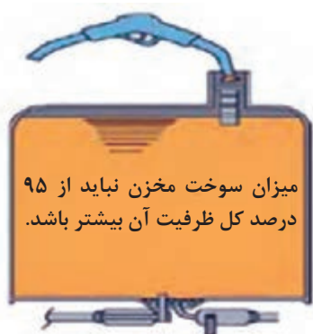
شکل ۲۳- پر کردن مخزن سوخت
