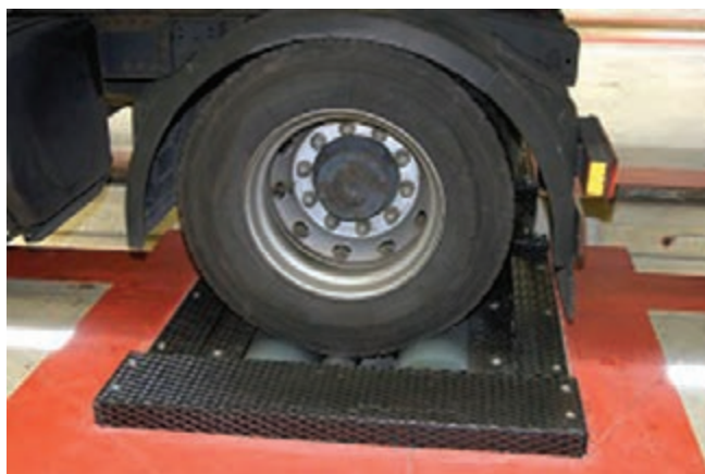
شکل ۵۲- انجام تست ترمز در سالن معاینه فنی ناوگان جاده‌ای
