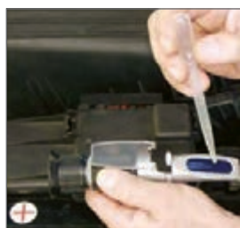
شکل ۶- اندازه‌گیری الکترولیت باتری
