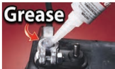
شکل ۵- گریس کاری بست‌های باتری
