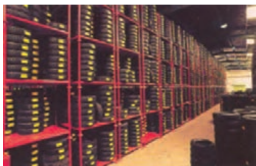
شکل ۳۶- انبارکردن صحیح تایر
