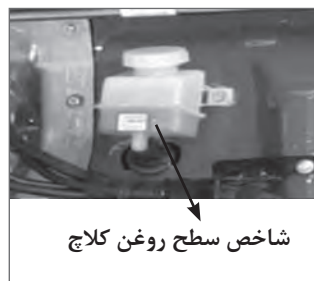
شکل ۲۶- مخزن روغن کلاچ
