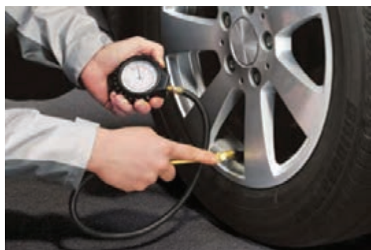
شکل ۳۵- اندازه‌گیری و تنظیم فشار باد تایر
