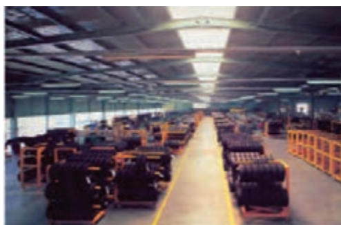
شکل ۳۶- انبارکردن صحیح تایر
