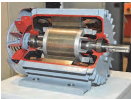
شکل ۱۳- موتور القایی سه فاز
