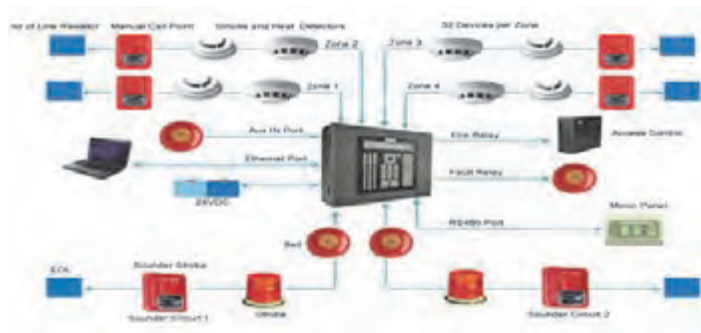
شکل ۴۲ - مرکز کنترل اعلام حریق
