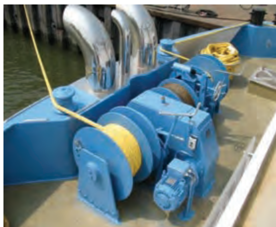
شکل ۸- سیستم Mooring شناور
