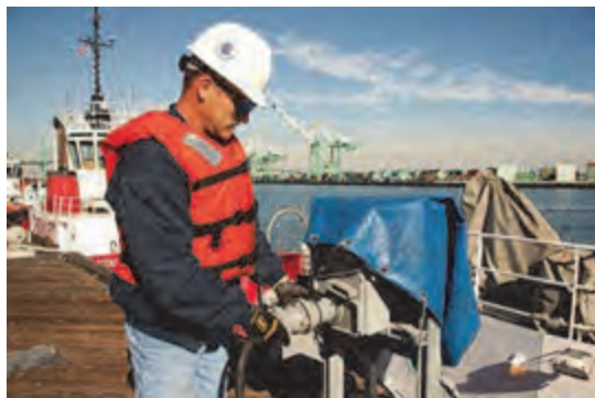
شکل ۲۰- استفاده از برق اسکله در زمان پهلوگیری شناور
