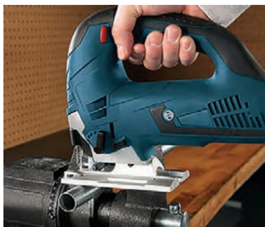
شکل ۵۰- برش لوله فلزی آویز لباس با اره چکشی
