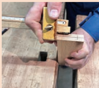
شکل ۱۹۹- ترسیم خط عرضی عمود بر خط طولی
