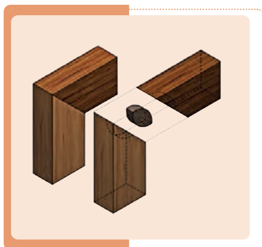
شکل ۱۶- سه نما و تصویر مجسم اتصال گوشه‌ای بیسکوییتی فارسی
