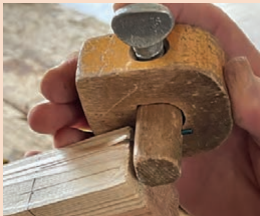
شکل ۱۱۴- خط کشی سر چوب با خط کش تیره دار
