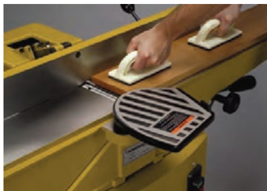
رندیدن چوب نازک با دستک فشار
