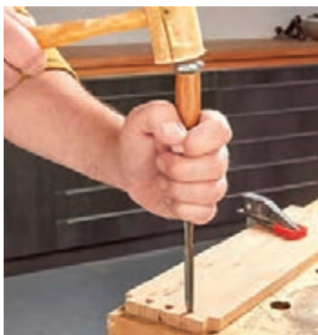
شکل ۱۳- استفاده از مغار برای تمیزکاری از دو طرف
