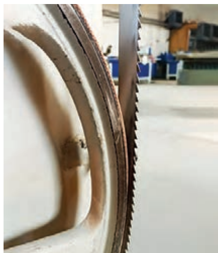
شکل ۴۸- میزان مناسب بیرون زدگی تیغه از فلکه ها
