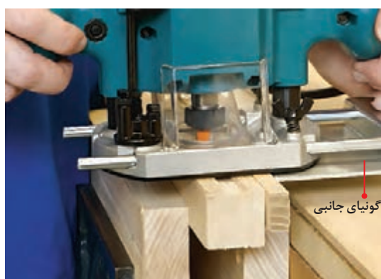
شکل ۱۴۶- شیارزنی روی قطعه کار با استفاده از گونیا جانبی
