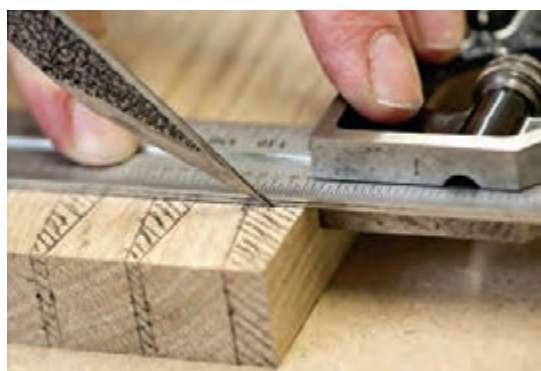
شکل ۹- عمیق کردن خط برش با چاقوی خط‌کشی
