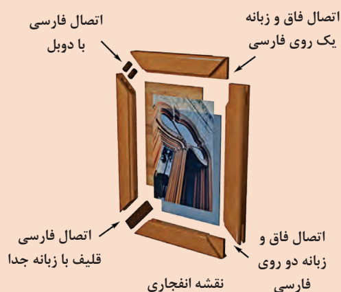
شکل ۱۰۳- تصویر انفجاری قاب عکس
