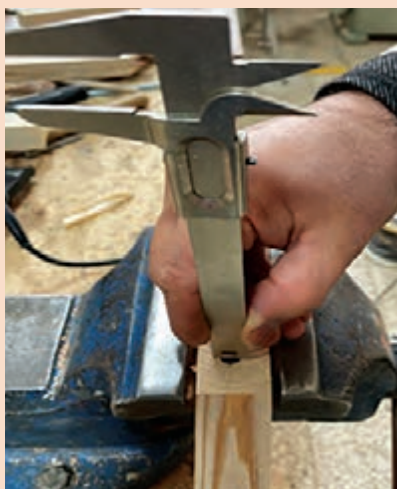
شکل ۱۱۱- کنترل عمق سوراخ
