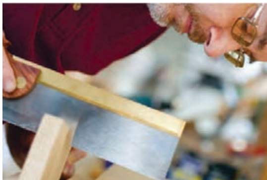
شکل ۱۱- بررسی کردن خط برش از پشت قطعه
