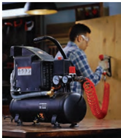
شکل ۹۹- اتصال ابزار به کمپرسور
