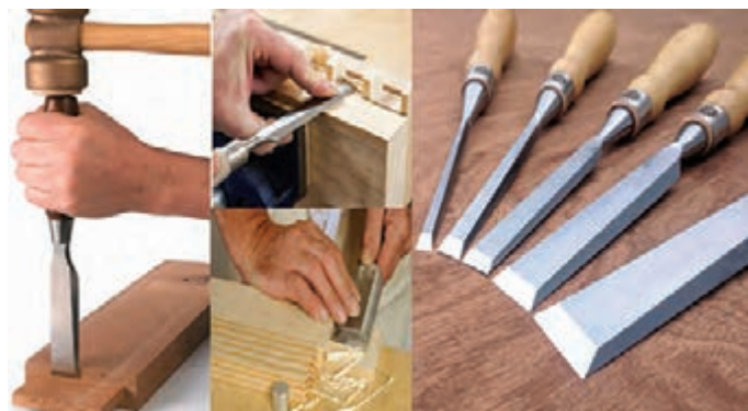
شکل ۵۹- انواع مغار پخ‌دار و کاربردهای آن
