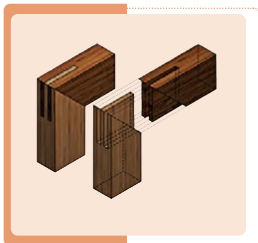
شکل ۱۰- سه نما و تصویر مجسم اتصال گوشه‌ای فاق و زبانه دوتایی دو رو فارسی
