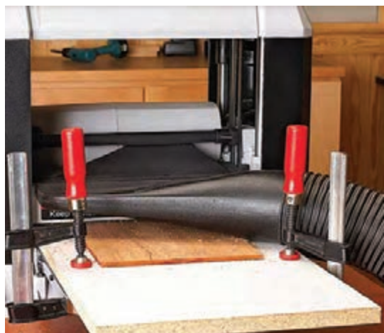
شکل ۷۴- گندگی کردن چوب‌های با ضخامت کم با کمک صفحات مصنوعی
