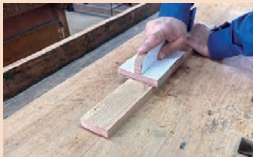
شکل ۲۲۴- سنباده‌زنی بدنه قاب شلف با تخته سنباده
