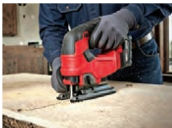
شکل ۴۷- برش مستقیم درون قطعه کار
