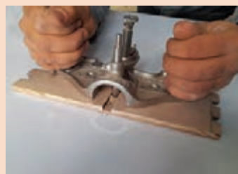
شکل ۲۹- زدن کنشکاف با استفاده از اره ظریف‌بر، مغار و رنده کف تراش کنشکاف
