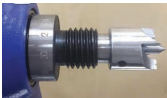
شکل ۱۳- انواع مرغک چهار نیش و با نیش های بیشتر
