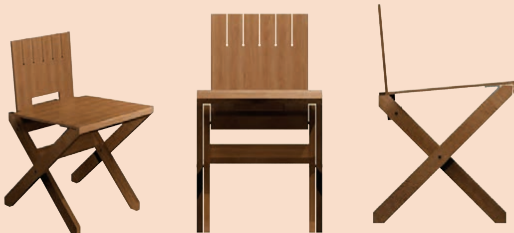
شکل ۸- نقشه سه نما، تصویر مجسم ایزومتریک صندلی تاشو
