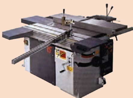
شکل ۲۰- ماشین اره گرد میزی یا اره مجموعه‌ای
