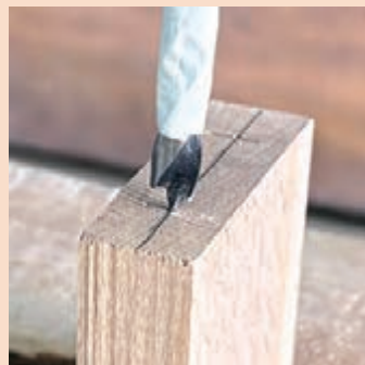
شکل ۲۰۵- استفاده از مته نیش‌دار شکل ۲۰۶- سوراخ‌کاری محل میخ چوبی شکل ۲۰۷- قطعات سوراخ‌کاری شده
