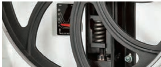
شکل ۴۱- نشانگر کشش سنج تیغه
