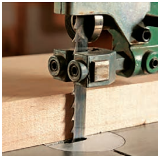
شکل ۴۹- تنظیم هدایتگر تیغه با توجه به ارتفاع برش چوب
