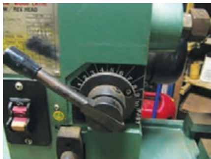
شکل ۱۲- گیربکس تنظیم دور ماشین خراپی
