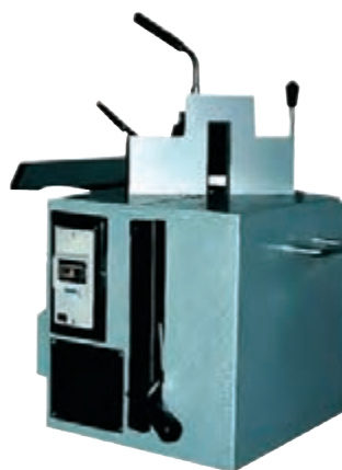
شکل ۷۵- ماشین اره فارسی بر صندوقی
