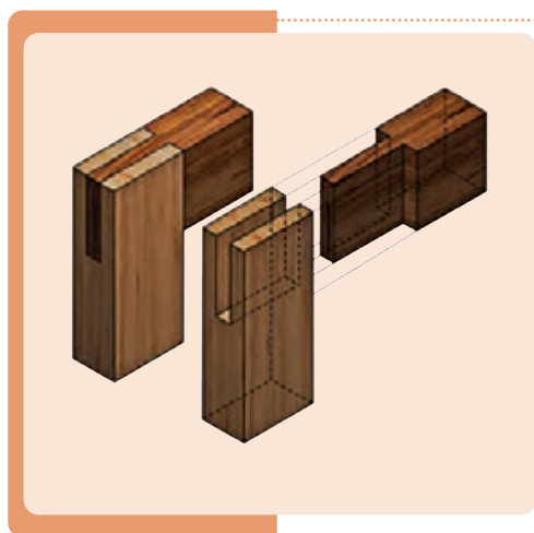
شکل ۵- سه نما و تصویر مجسم اتصال گوشه‌ای فاق و زبانه ساده
