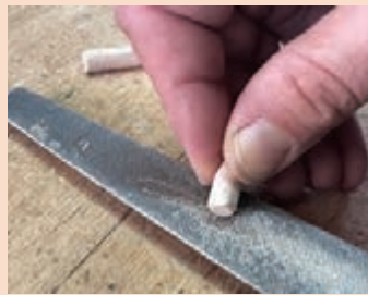
شکل ۲۲۷- پخ زدن دوبل با سوهان
