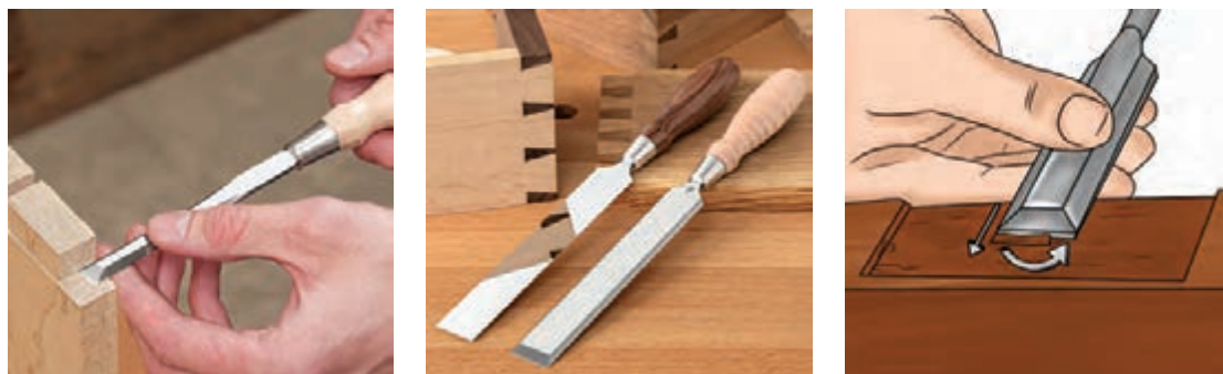
شکل ۶۰- برخی از کاربردهای مغارهای اتصال زنی
