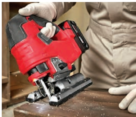
شکل ۴۹- برش مورب و تحت زاویه با اره چکشی
