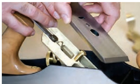
شکل ۱۵۴- جدا کردن با احتیاط تیغه فلزی برای عدم برخورد با دست
