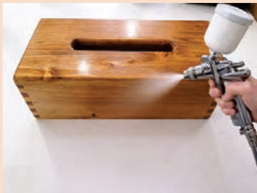
شکل ۶۶- پاشیدن کیلر براق روی جعبه
