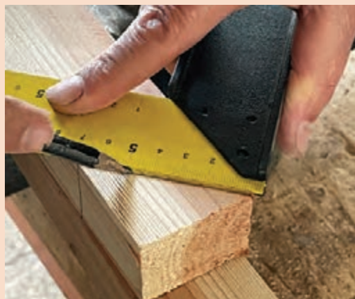
شکل ۱۱۵- خط کشی ۴۵ درجه با گونیای فارسی
