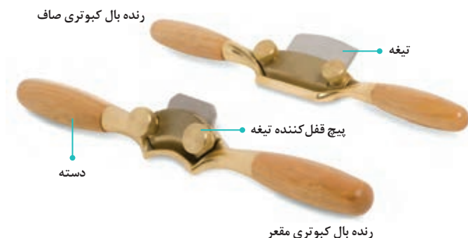
شکل ۱۶۹- انواع رنده بال کبوتری
