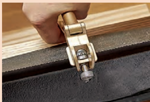
شکل ۷۳- چپ و راست کردن دندان تیغه اره
