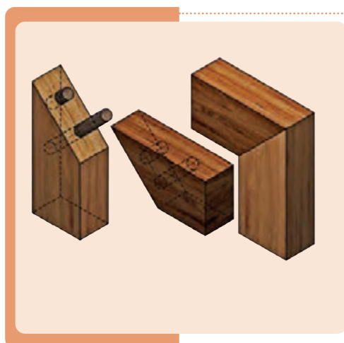
شکل ۱۸- سه نما و تصویر مجسم اتصال گوشه‌ای فارسی ساده با دوبل کوتاه و بلند
