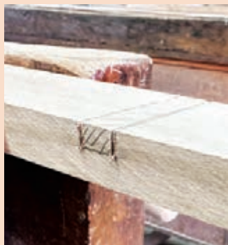
شکل ۲۱۸- برش ایجاد شده تا خط عمق شیار
