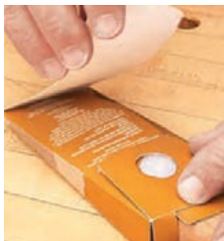
شکل ۸۵- پیچیدن قلم‌مو در پوشش مقوایی شکل ۸۶- پیچیدن قلم‌مو در کاغذ ضخیم
