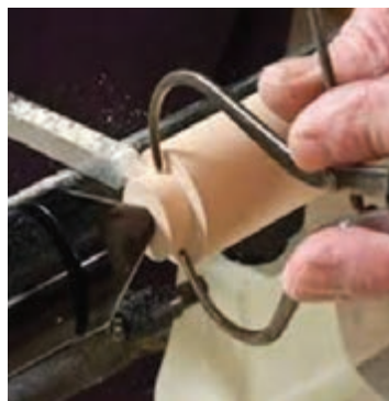
شکل ۴۰- کاربرد انواع پرگار اندازه‌گیر
