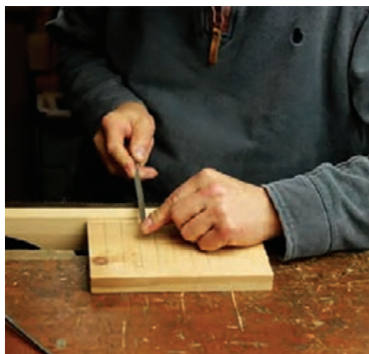
شکل ۷۷- ترسیم زاویه قائمه برای اره برش طولی
