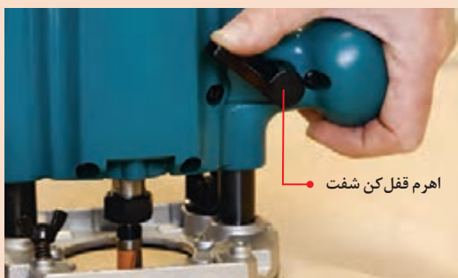
شکل ۱۴۳- قفل کردن شفت با اهرم مخصوص
