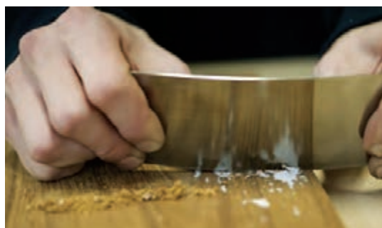
شکل ۱۷۵- لیسه کاری اضافه های چسب از سطح روکش طبیعی
