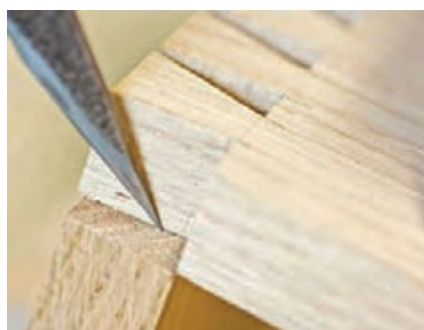
شکل ۱۶- انتقال خطوط زبانه روی سر قطعه فاق شکل ۱۷- امتداد خطوط انتقال یافته روی سطح قطعه فاق
