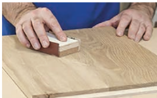
شکل ۱۸۱- تخته سنباده با سنباده پشت پارچه‌ای و کاربرد آن
