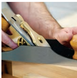
شکل ۱۶۴- تنظیم پرتیغ یا کم تیغ کردن تیغه
