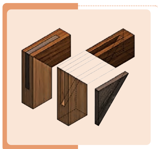
شکل ۱۵- سه نما و تصویر مجسم اتصال گوشه‌ای دو رو فارسی با زبانه جدا
