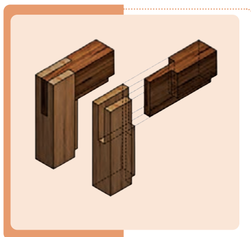
شکل ۱۱- سه نما و تصویر مجسم اتصال گوشه‌ای فاق و زبانه ساده با دو راهه
