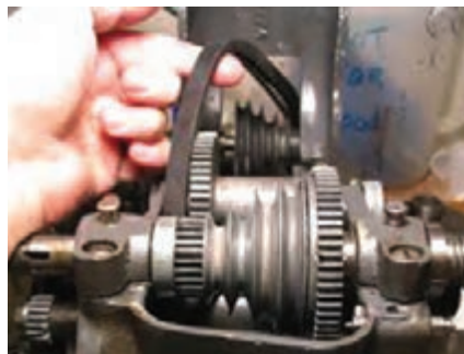
شکل ۱۲- گیربکس تنظیم دور ماشین خراپی
