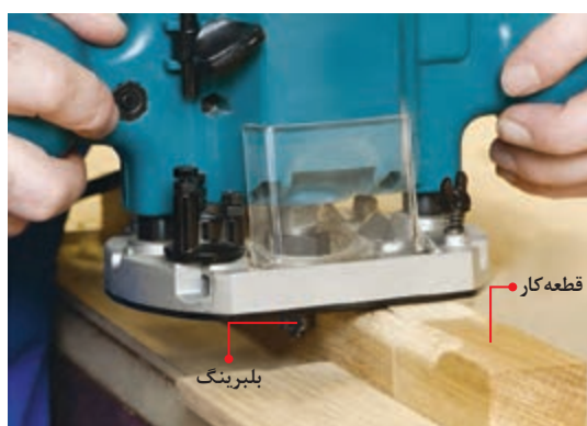
شکل ۱۴۷- گرد کردن لبه قطعه چوب با اورفرز و تیغه بلبرینگ‌دار و قطعه با لبه گرد شده
