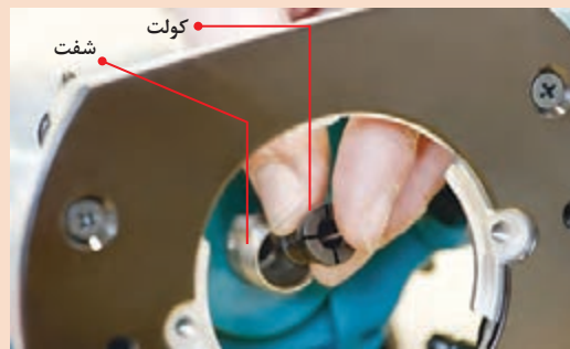
شکل ۱۳۶- قرارگیری کولت درون شفت
