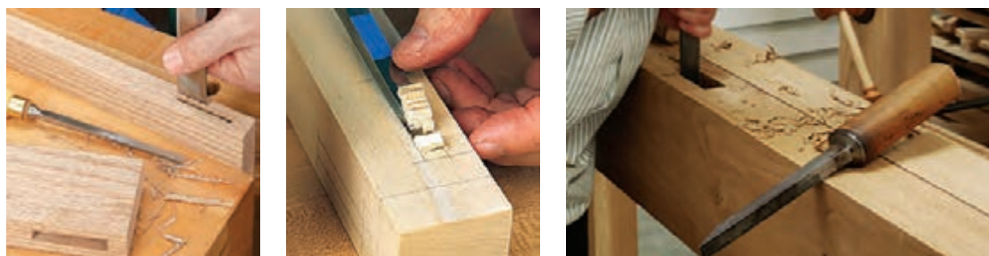
شکل ۶۱- اسکنه و کاربرد آن
