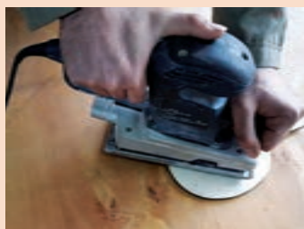
شکل ۹۸ - پرداخت سطح کار با سنباده لرزان
