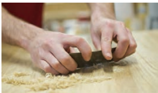
شکل ۱۷۶- لیسه کاری سطح چوب
