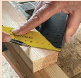
ب) خط کشی تحت ۴۵ درجه با گونیا از بالا به پایین
