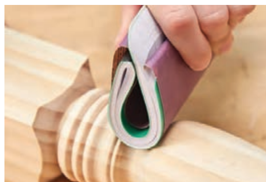
نحوه سنباده زدن قوس مقعر
