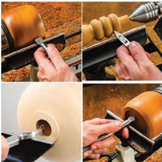
شکل ۱۸- کاربرد برخی مغارها با تیغچه‌های الماسه
