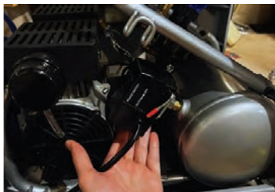
شکل ۱۰۰- خاموش کردن کمپرسور و تخلیه فشار
