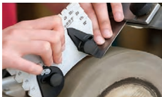
شکل ۱۵۶- تنظیم زاویه قرارگیری تیغه روی دستگاه سنگ
