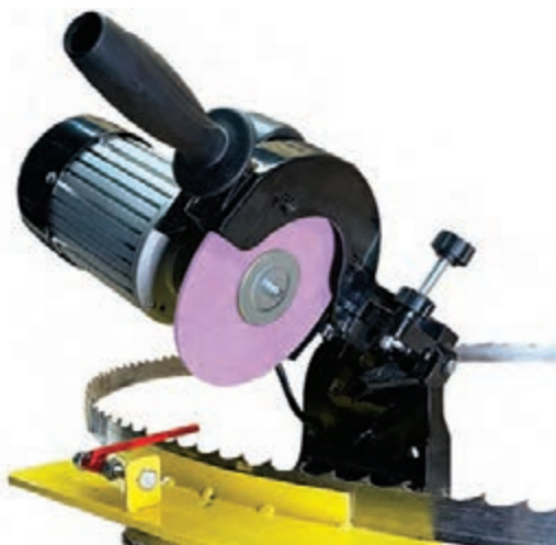
شکل ۴۲- ماشین تیغه تیزکن اره نواری
