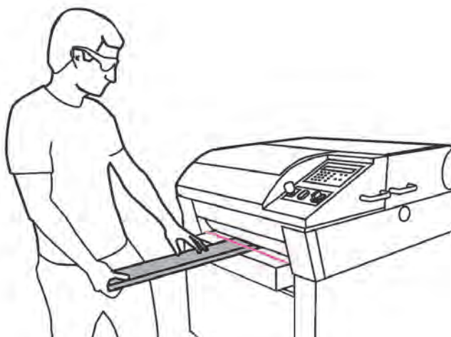
شکل ۵۹- یک ضخامت کردن قطعات چوب با ماشین گندگی
