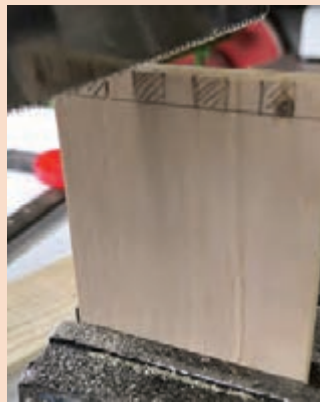
شکل ۵۵- برش کاری اتصال با اره دستی ظریف‌بر شکل ۵۶- خارج کردن بخش‌هایی از اتصال انگشتی
