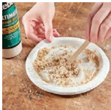
شکل ۵۷- مخلوط کردن بتونه
