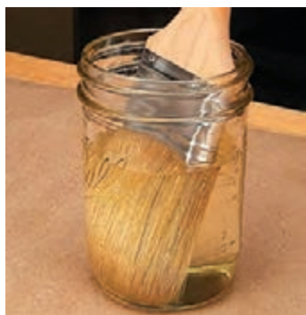
شکل ۸۴- قراردادن قلم‌مو در حلال
