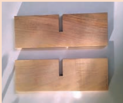
شکل ۳۶- اتصال نیم نیم برای تقسیم داخلی جعبه
