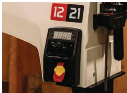
شکل ۱۱- افزایش و کاهش سرعت ماشین خراپی با اینورتر
