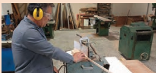
شکل ۱۲۷- آماده سازی قطعات با ماشین اره فارسی بر صندوقی
