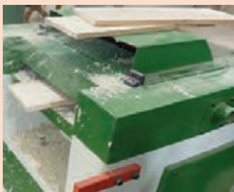
شکل ۱۹۱- هم ضخامت کردن با ماشین گندگی
