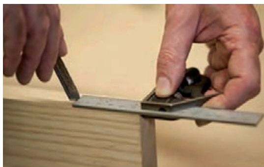
شکل ۳۴- اندازه گذاری از لبه قطعه کار
