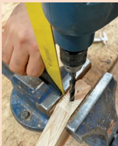
شکل ۱۱۰- نحوه سوراخ کردن محل دوپل
