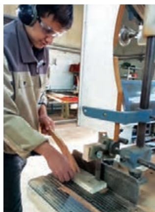
شکل ۵۰- استفاده از دستک فشار (پیش‌دهنده) در برش‌کاری
