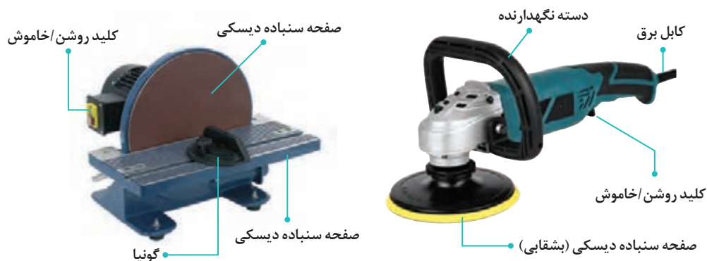
شکل ۲۰- ماشین سنباده دیسکی (پولیش) و دیسکی ثابت
