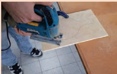
شکل ۸۹- برش الگو توسط اره عمودبر
