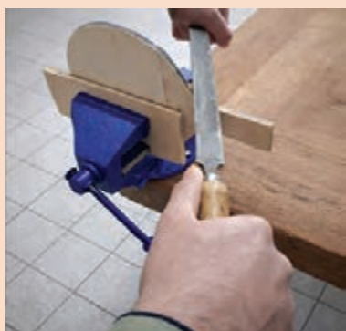
شکل ۹۵ - پرداخت قسمت برش خورده
