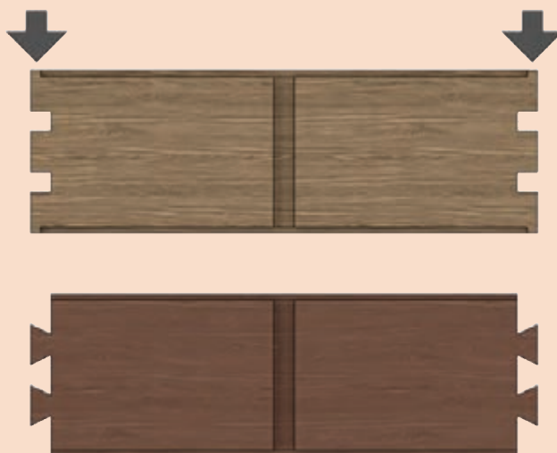
شکل ۳۱- کنشکاف و دوراها ایجاد شده روی تخته ها (دو فلش، قسمت سر و ته دوراها نشده را نشان می دهد).
