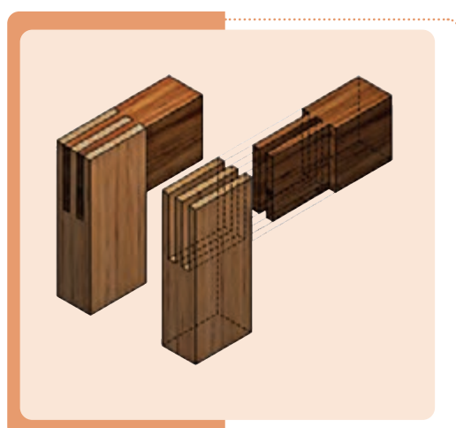
شکل ۹- سه نما و تصویرمجسم اتصال گوشه‌ای فاق و زبانه دوتایی ساده
