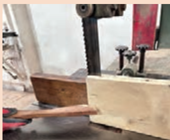
شکل ۱۸۹- برش از ضخامت با اره نواری
