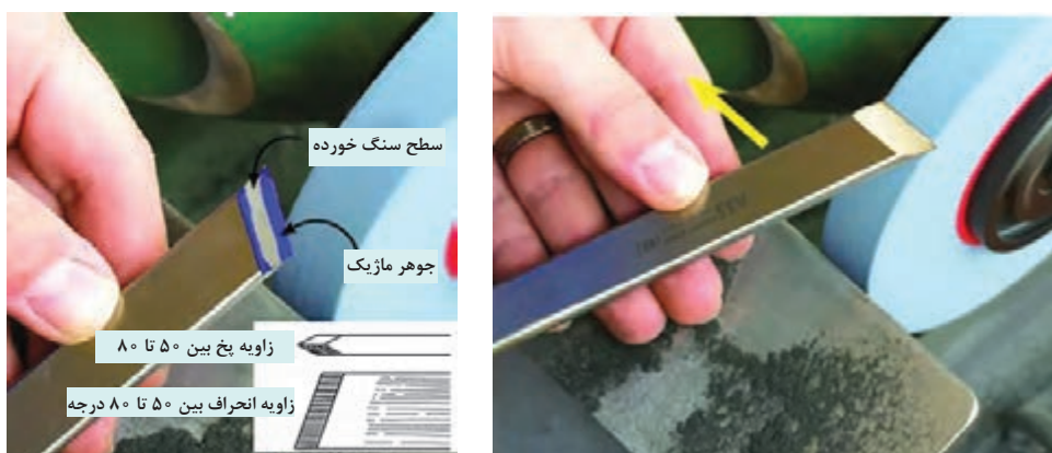
شکل ۳۱- نحوه تیز کردن مغار مورب
