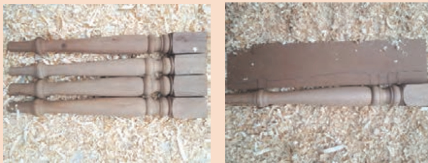
شکل ۷۵- پایه‌های خراطی شده میز جلو مبلی طبق طرح
