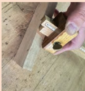
شکل ۲۱۳- خط‌کشی عمق شیار با خط‌کش تیره‌دار
