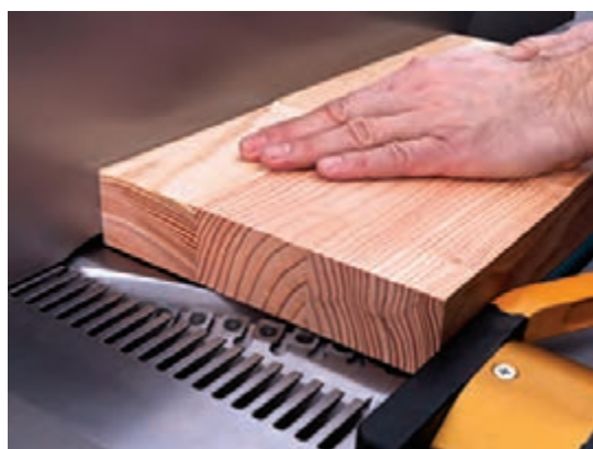
شکل ۴- رنده کاری قطعات چوب با ماشین کفرند
