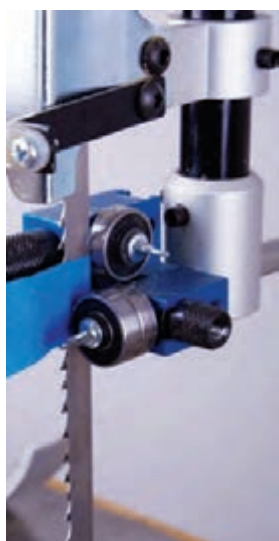
شکل ۳۸- تنظیم فاصله تیغه از دو طرف با راهنمای جانبی به کمک کاغذ
