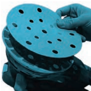
شکل ۲۴- ورق سنباده پشت کرک دار سوراخ دار و نحوه نصب در ماشین سنباده گردلرزان
