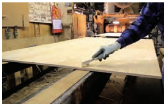
شکل ۵۸- بتونه کاری سطح چوب با کاردک
