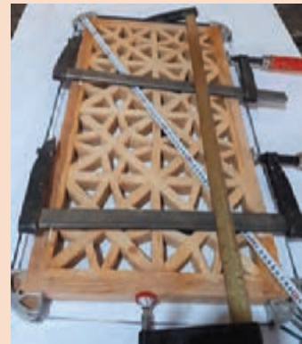
شکل ۱۲۸- مونتاژ قاب گره چینی و شکل ۱۲۹- ابزار زنی لبه قاب با ماشین اورفرز شکل ۱۳۰- مونتاژ نهایی صفحه میز به پایه
