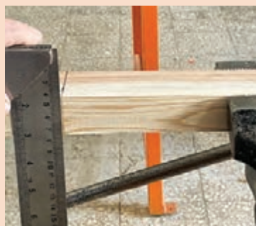
ب) دور کردن چوب به کمک گونیا
