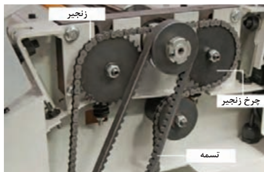
شکل ۷۰- سیستم انتقال نیرو در ماشین گندگی
