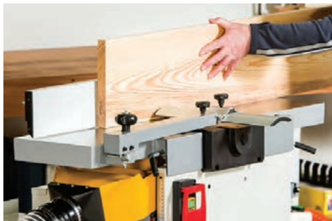
شکل ۱۸- حفاظ روی تویی رنده (تیغه‌ها)
