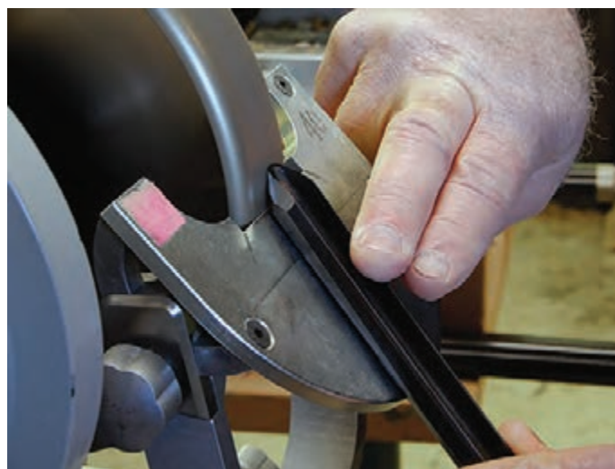
شکل ۳۲- تیز کردن انواع مغار گلوبی براساس زاویه
