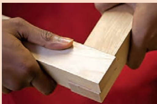
شکل ۸۹- لب به لب نبودن اتصال
