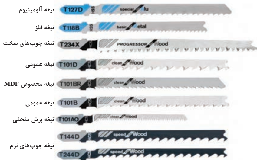
شکل ۵۱- انواع تیغه اره عمودبر با توجه به نوع کاربرد
