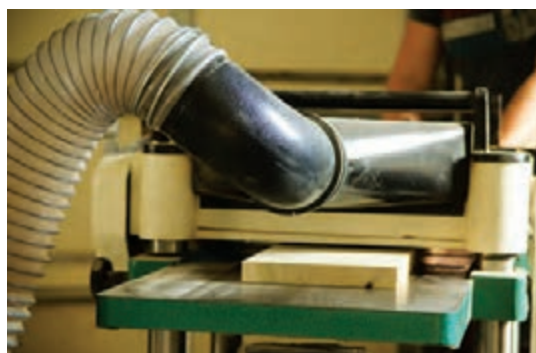
شکل ۶۹- دهانه خروج پوشال متصل به مکنده
