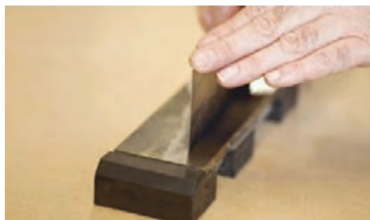
شکل ۱۷۱- هموار کردن لبه طولی لیسه با سنگ نفت
