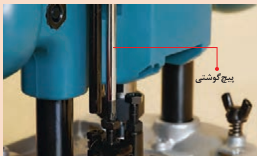
شکل ۱۴۵- تنظیم ارتفاع پله با پیچ گوشتی
