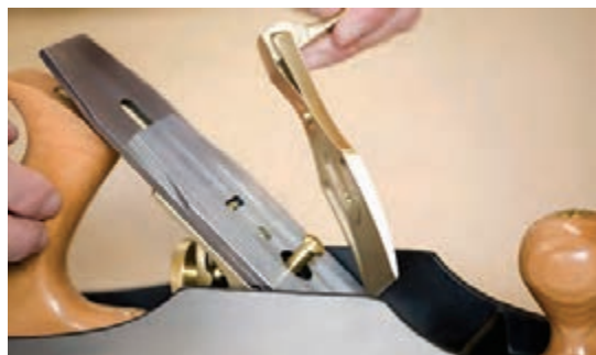
شکل ۱۵۳- جدا کردن نگه‌دارنده تیغه از روی رنده
