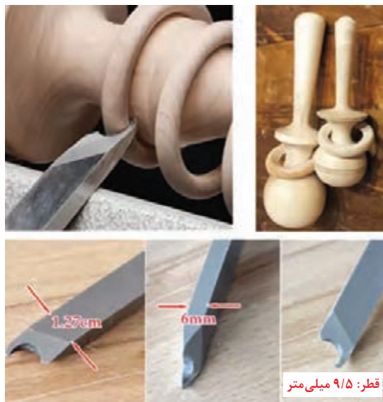
شکل ۲۵- مغار مورب با افتادگی نیم گرد
