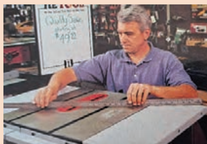
شکل ۲۱- بررسی صفحه ماشین
