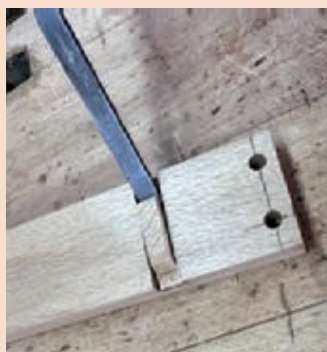
شکل ۲۲۱- نحوه مغار کاری در حالت خوابیده قطعه
