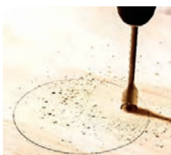
سوراخ کردن داخل قطعه برای برش درون قطعه کار
