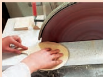
شکل ۹۷ - پرداخت لبه با سنباده دیسکی
