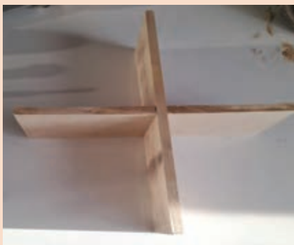
شکل ۳۷- اتصال درهم جازده شده
