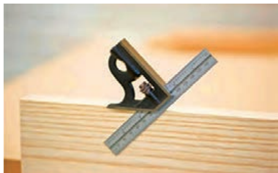
شکل ۳۳- خط کشی ۴۵ درجه
