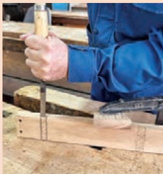
شکل ۲۱۹- بستن قطعه با پیچ دستی و مغار کاری
