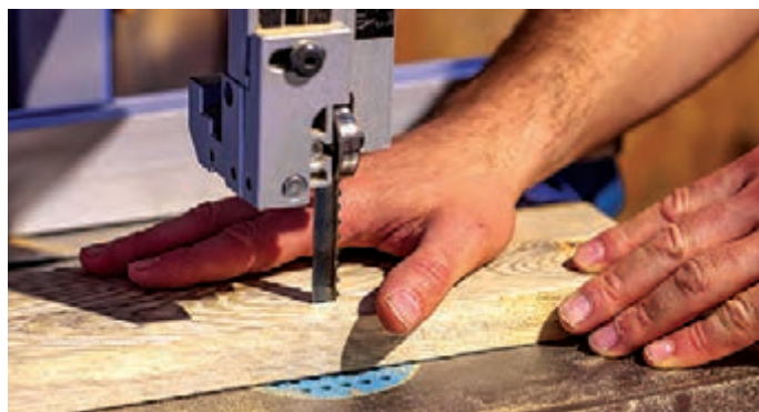
شکل ۵۱- عدم رعایت فاصله مناسب دست نسبت به تیغه
