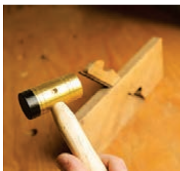
شکل ۵۰- چکش فلزی ضد جرقه برای در آوردن تیغه از رنده
