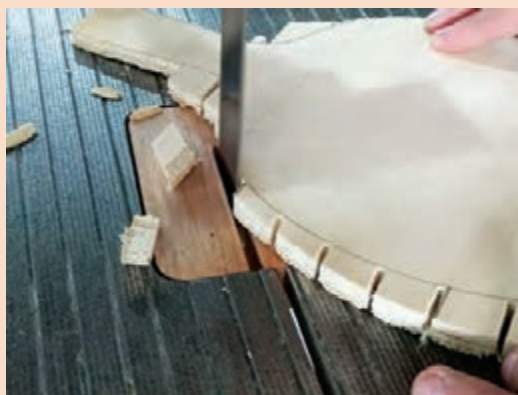
شکل ۹۳- انجام قوس‌بری با چندین برش مستقیم
