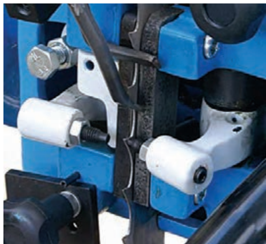
شکل ۴۳- ماشین چپ راست کن تیغه اره نواری
