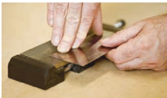
شکل ۱۷۲- پلیسه گیری لبه طولی لیسه با سنگ نفت
