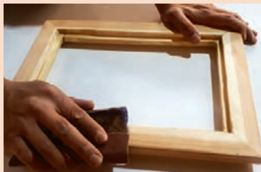
شکل ۱۲۷- نحوه سنباده دستی با تخته سنباده و با دست
