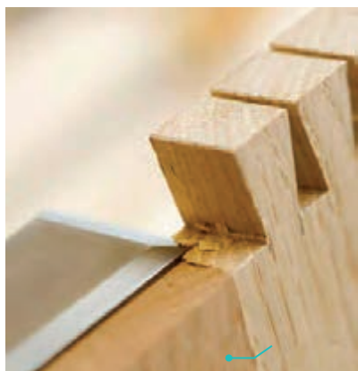
شکل ۱۵- تمیز کردن محل برش خورده با مغار
