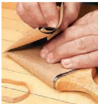
شکل ۸۵- پیچیدن قلم‌مو در پوشش مقوایی شکل ۸۶- پیچیدن قلم‌مو در کاغذ ضخیم
