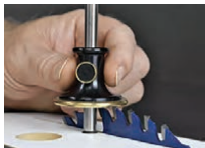
شکل ۴۸- استفاده خط کش تیره دار برای تنظیم ارتفاع تیغه
