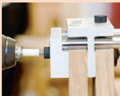
شکل ۲۰۸- نحوه قرارگیری قطعات درون قالب شکل ۲۰۹- سوراخ‌کاری محل میخ چوبی در سر قطعه شکل ۲۱۰- سوراخ‌کاری در سطح قطعه
