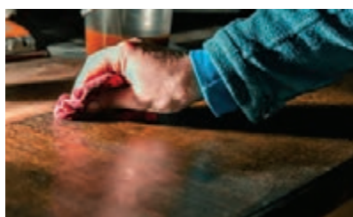
شکل ۶۶- زدن آستری با کرباس
