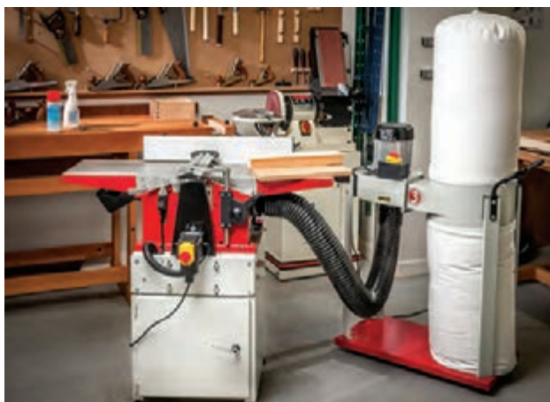
شکل ۷۱- استفاده از مکنده صنعتی در کار با ماشین آلات
