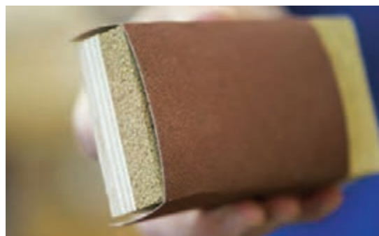
شکل ۱۸۱- تخته سنباده با سنباده پشت پارچه‌ای و کاربرد آن
