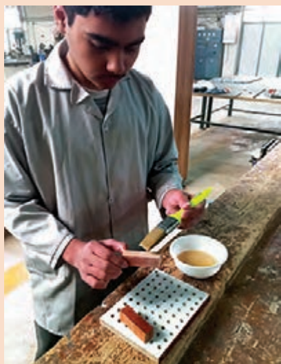
شکل ۸۱- رنگ کاری قطعات چوبی با استفاده از قلم‌مو
