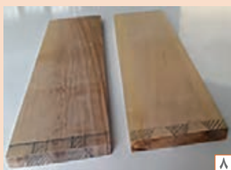
شکل ۲۷- مراحل و نحوه اندازه‌گذاری و خط‌کشی اتصال دم چلچله
