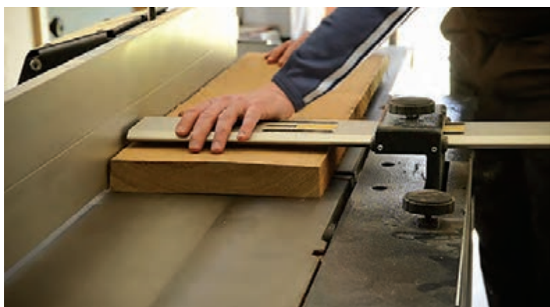
شکل ۱۹- تنظیم گونیا با توجه به عرض چوب
