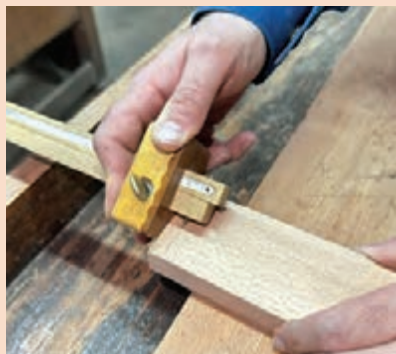
شکل ۲۰۱- ترسیم خط طولی در انتهای چوب
