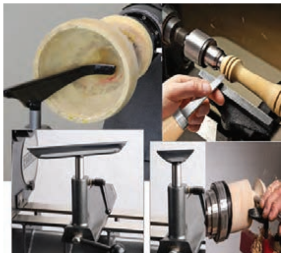
شکل ۱۵- فرم‌ها و اندازه‌های متفاوت تکیه‌گاه مغار مورد استفاده
