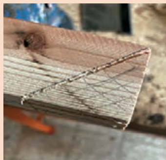
ث) برش زبانه تحت زاویه ۴۵ درجه
