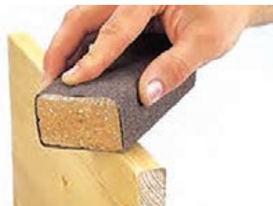
شکل ۵۲- استفاده از یک قطعه چوب برای سنباده کاری
