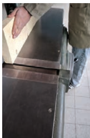
شکل ۲۰- تنظیم نادرست گونیا
