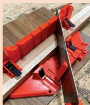
ت) برش تحت زاویه ۴۵ با قالب
