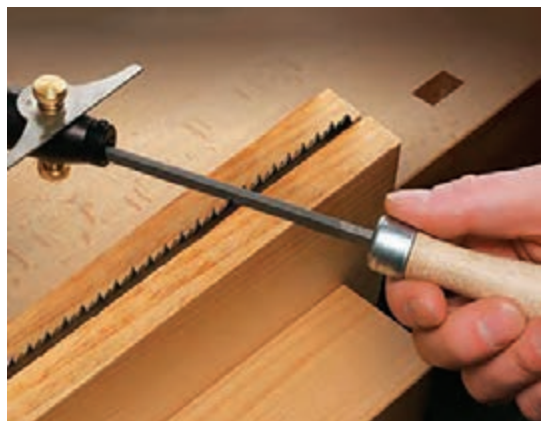
شکل ۸۰- قابلیت تنظیم دو زاویه حمله و برش
