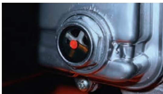
شکل ۹۵- بررسی سطح روغن
