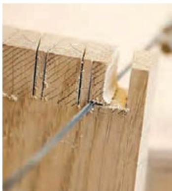
شکل ۱۸- برش کاری زبانه و خالی کردن قسمت های زائد
