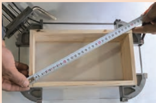
شکل ۵۸- جا زدن اتصال انگشتی، بستن با گیره کمربندی و گرفتن دوییدگی (گونیا یی کردن)
