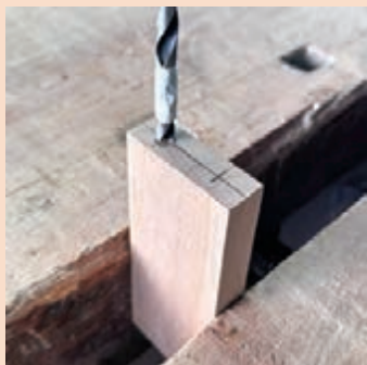
شکل ۲۰۵- استفاده از مته نیش‌دار شکل ۲۰۶- سوراخ‌کاری محل میخ چوبی شکل ۲۰۷- قطعات سوراخ‌کاری شده
