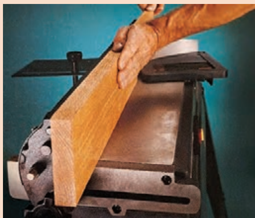
شکل ۱۲- رندیدن لبه یا نر قطعه کار
