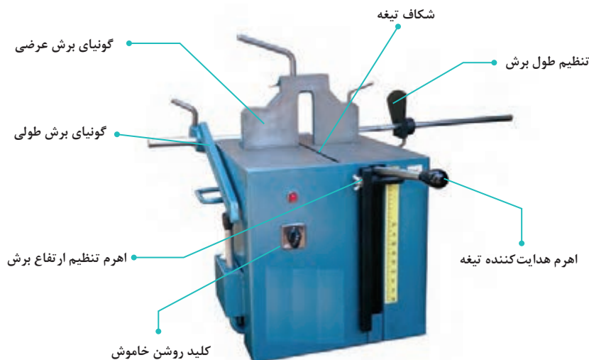
شکل ۹۲- ماشین فارسی بر صندوقی (قطع کن از پایین)
