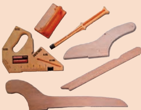
شکل ۳۰- لوازم کمکی پیش‌دهنده (دستک فشار)
