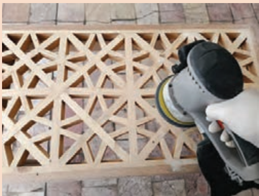
شکل ۱۳۲- پرداخت کاری کار با ماشین سنباده اربیتال
