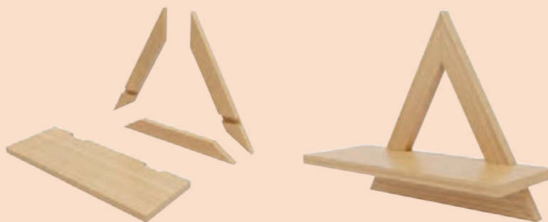
شکل ۲۳۶- تصویر مجسم ایزومتریک و نقشه مونتاژ (انفجاری) شلف مثلثی
