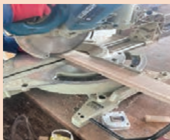
شکل ۱۹۵- اندازه بری با اره فارسی بر
