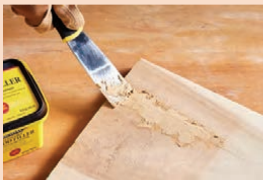
شکل ۱۰۸- برداشتن بتونه اضافه
