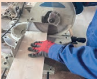
شکل ۱۹۲- برش طبقه به طول نهایی با فارسی بر
