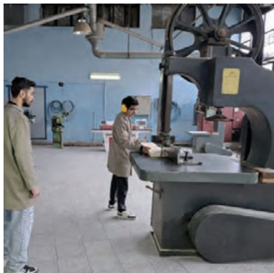
شکل ۵۲- ایستادن غیرمجاز در طرفین ماشین اره نواری
