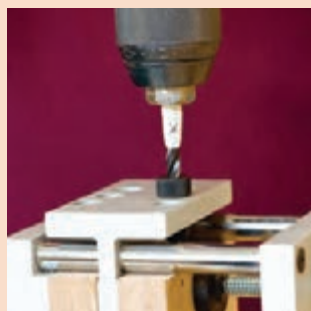
شکل ۲۰۸- نحوه قرارگیری قطعات درون قالب شکل ۲۰۹- سوراخ‌کاری محل میخ چوبی در سر قطعه شکل ۲۱۰- سوراخ‌کاری در سطح قطعه
