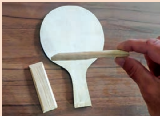
شکل ۱۰۲- برش ۴۵ درجه قطعات چوبی
