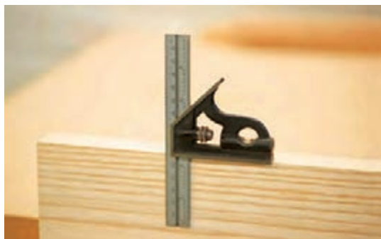
شکل ۳۲- خط کشی ۹۰ درجه
