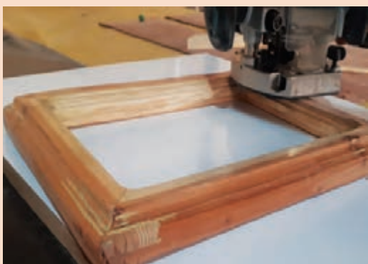
شکل ۱۲۶- انتخاب تیغه فرز و فرز کاری لبه داخلی و خارجی قاب عکس
