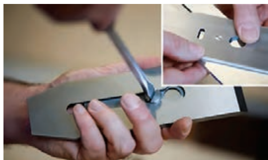
شکل ۱۵۵- باز کردن هدایت‌کننده براده چوب از روی تیغه
