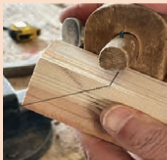
پ) تقسیم ضخامت قطعه به کمک خط کش تیره دار به سه قسمت مساوی
