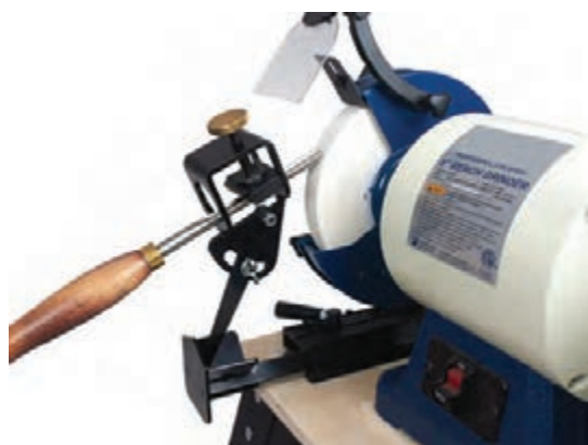
شکل ۳۲- تیز کردن انواع مغار گلوبی براساس زاویه
