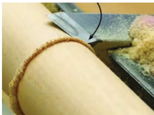
ب) مغار مورب برای موج‌گیری و صاف کردن سطوح مورب
