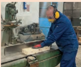
شکل ۱۸۸- رندیدن نر قطعه با کف رند
