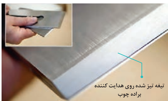
شکل ۱۶۳- تیغه تیز شده و سفت کردن روی هدایت کننده براده
