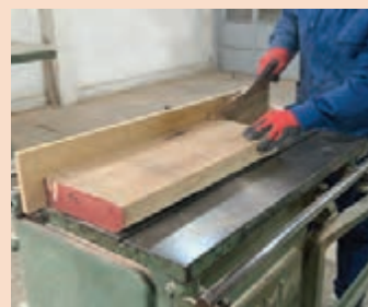
شکل ۱۹۳- برش قطعات بدنه شلف با اره دورکن
