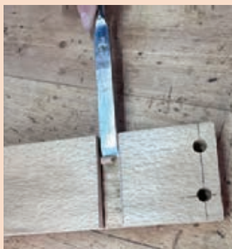
شکل ۲۲۲- هاشور زدن محل برش شیارها
