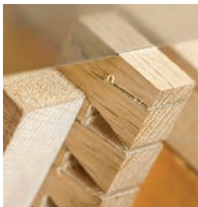
شکل ۱۴- برش لبه زبانه با اره ظریف بر
