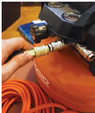
شکل ۹۸- اتصال ابزار به کمپرسور
