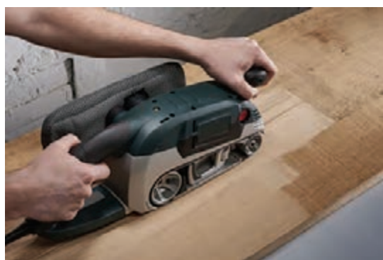
حرکت ماشین سنباده نواری در جهت الیاف چوب
