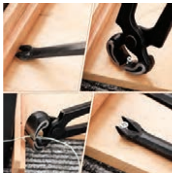
شکل ۵۷- کشیدن پیچ، اهرم کردن و پیچاندن
