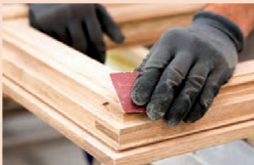
شکل ۱۲۷- نحوه سنباده دستی با تخته سنباده و با دست
