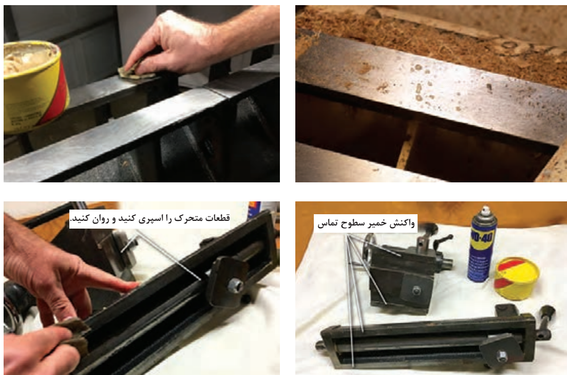
شکل ۶۴- نحوه از بین بردن زنگ‌زدگی و روان کاری ماشین خراطی
