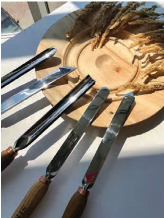
شکل ۱۷- فرم‌های متفاوت نوک مغار
