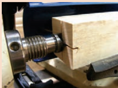
ج) نحوه قرارگیری پایه در چهار نیش
