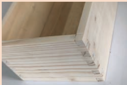
شکل ۵۸- جا زدن اتصال انگشتی، بستن با گیره کمربندی و گرفتن دوییدگی (گونیا یی کردن)
