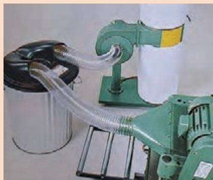
شکل ۲۷- دستگاه مکنده با لوله خرطومی
