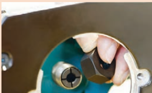
شکل ۱۳۷- قرارگیری مهره نگه‌دارنده کولت
