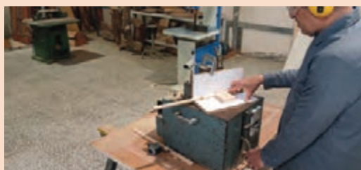
شکل ۱۲۷- آماده سازی قطعات با ماشین اره فارسی بر صندوقی
