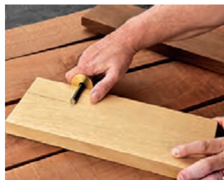
شکل ۴۳- خط‌کشی موازی با لبه قطعه کار
