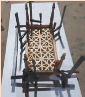
شکل ۱۲۸- مونتاژ قاب گره چینی و شکل ۱۲۹- ابزار زنی لبه قاب با ماشین اورفرز شکل ۱۳۰- مونتاژ نهایی صفحه میز به پایه
