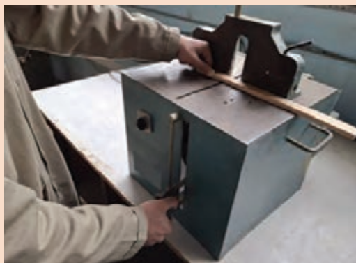
شکل ۱۰۱- برش قطعات با اره فارسی بر صندوقی
