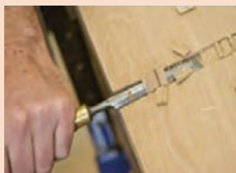
شکل ۲۹- زدن کنشکاف با استفاده از اره ظریف‌بر، مغار و رنده کف تراش کنشکاف
