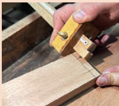
شکل ۲۰۳- ترسیم خط عرضی عمود بر خط طولی
