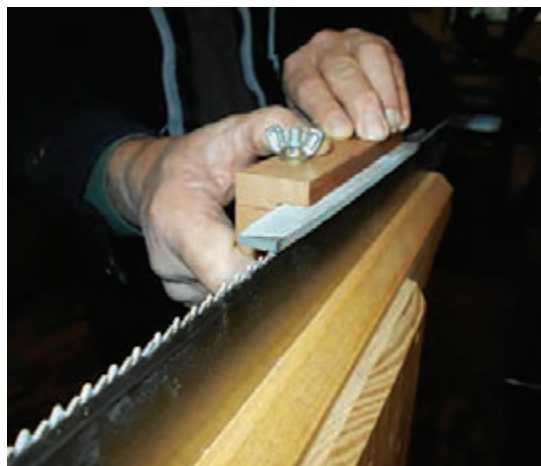
شکل ۷۶- نحوه هم سطح کردن ارتفاع دندانهای تیغه با سوهان
