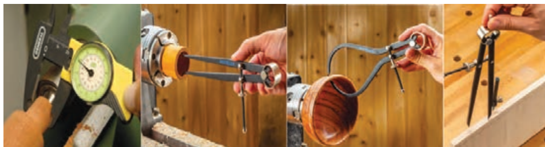
کولیس اندازه‌گیری داخلی، خارجی و عمق کار
