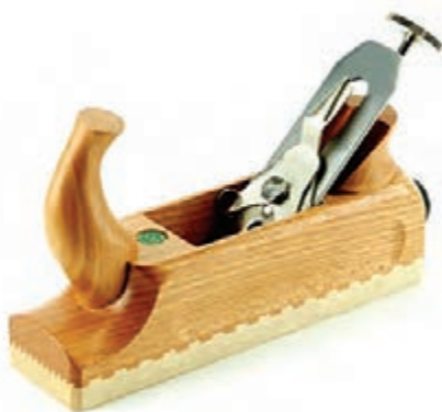
شکل ۱۵۱- رنده چوبی مدرن با نگه دارنده تیغه فلزی، تنظیم جانبی تیغه و پیچ تنظیم میزان بیرون زدگی تیغه
