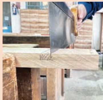
شکل ۲۱۷- برش محل شیار با اره پشت‌دار
