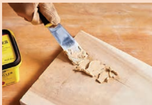
شکل ۱۰۷- پر کردن ترک با بتونه
