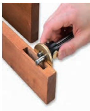
شکل ۴۵- خط‌کشی اتصال کُم
