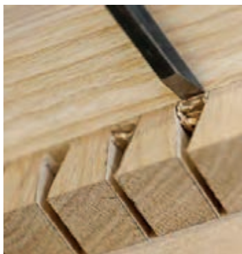
شکل ۱۳- استفاده از مغار برای تمیزکاری از دو طرف
