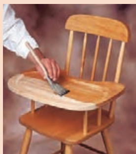
شکل ۱۱۵- سیلر کاری تمام سطح
