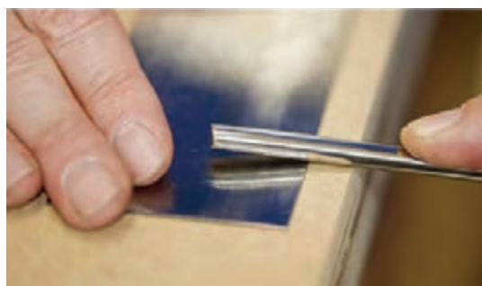
شکل ۱۷۳- کشیدن مصقل برای برگرداندن پلیسه
