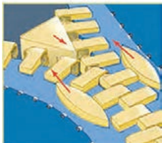
زیپ نمونه‌ای از فناوری قرن بیستم است که از سه گوه بهره می‌برد. دسته زیپ از گوه‌هایی تشکیل شده که تلاش کوچک ما را به نیروی بزرگی تبدیل می‌کنند که زیپ را باز می‌کند و می‌بندد. بدون کمک این گوه‌ها، متصل کردن یا جدا کردن دندان‌های زیپ تقریباً امکان‌پذیر نیست.
