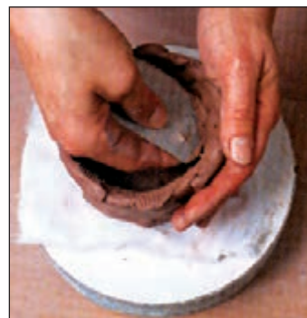
▲ پرداخت کردن سطح داخلی ظرف سفالی.
