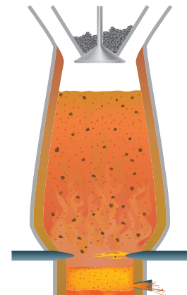
(ب) گرمادادن مخلوط سنگ آهن، کربن و سنگ آهک در کوره
