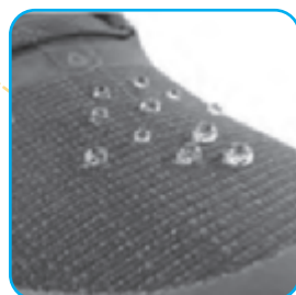
شکل ۴ اگر آب قطره قطره روی سطحی بریزد و به‌طور یکنواخت روی آن گسترده نشود، آن سطح را آب‌گریز می‌نامند.
