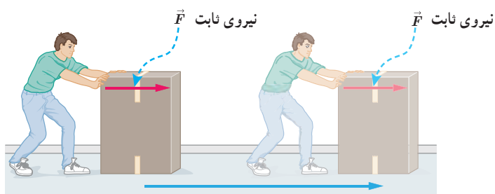
شکل ۳-۱ نیروی ثابت \vec{F} که با جابه‌جایی \vec{d} هم جهت است، کار W = Fd را انجام می‌دهد.
