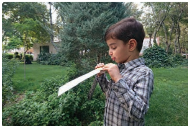
شکل ۲-۲۷ تندی جریان هوا در بالای کاغذ بیشتر از زیر آن است. با توجه به اصل برنولی، فشار هوا در بالای کاغذ کمتر از زیر آن است.
