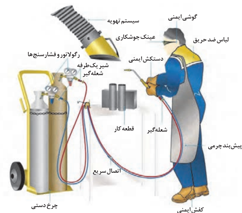
شکل ۵۴- تجهیزات ایمنی جوشکاری گاز
