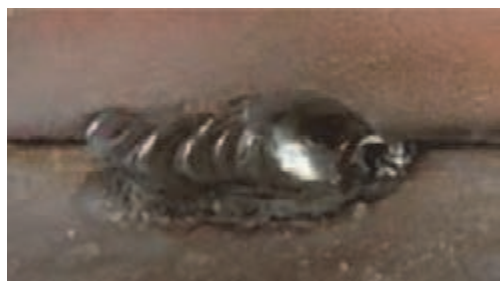
شکل ۳۸- مقطع باید کوچک و یکنواخت باشد تا تأثیری بر جوش نهایی نداشته باشد
