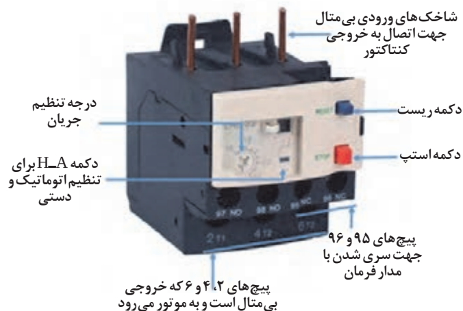
شکل ۲۱- تصویر ظاهری بی متال و اجزای آن
