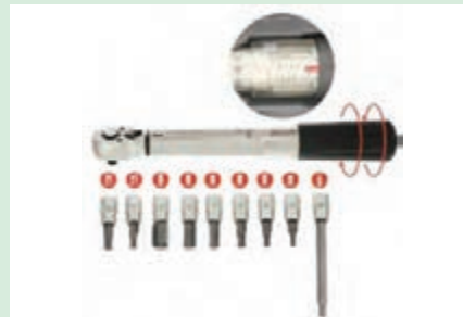
شکل ۸- تنظیم ترک متر قابل تنظیم
