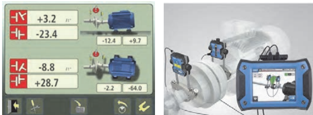
شکل ۸۵- هم‌راستا کردن محورها با دستگاه لیزر
