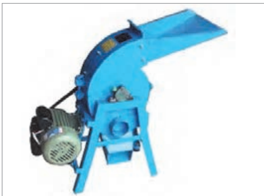
ب) تغییر دور موتور با تسمه در کاه خردکن
