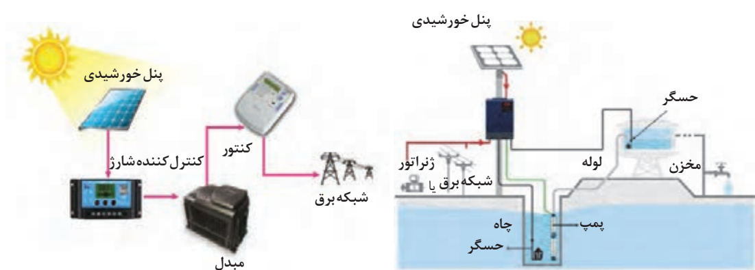
شکل ۴۲- سامانه متصل به شبکه برق
