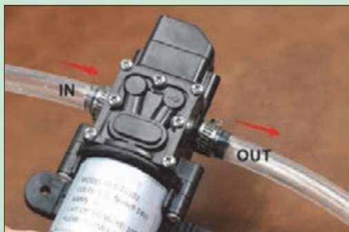
شکل ۵۹- اتصال پمپ و رعایت جهت حرکت سیال
