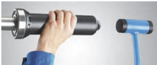
شکل ۶۵- جا زدن بلبرینگ با استفاده از ابزار مخصوص
