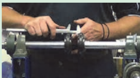
شکل ۸۳- کنترل هم راستایی کوپلینگ با استفاده از کولیس
