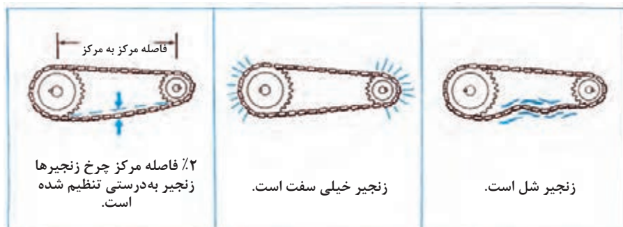
شکل ۹۱- کشش زنجیر
