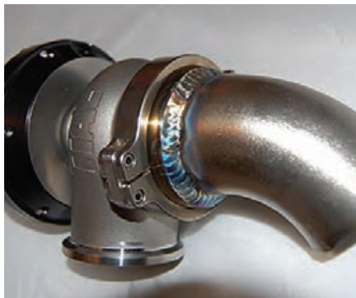
(الف) جوش کاری دو قطعه فولادی
