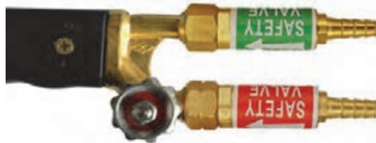
شکل ۵۶- شیر یک طرفه شعله گیر
