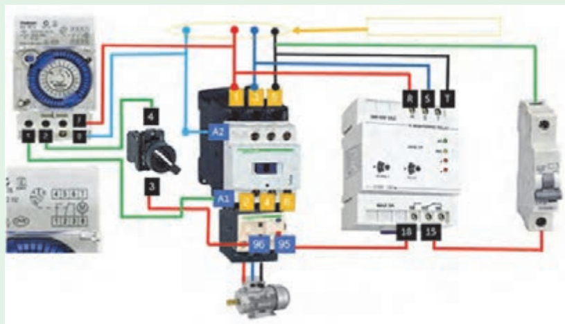
شکل ۳۱- مدار راه اندازی موتور سه فاز با حفاظت کامل و با استفاده از تایمر
