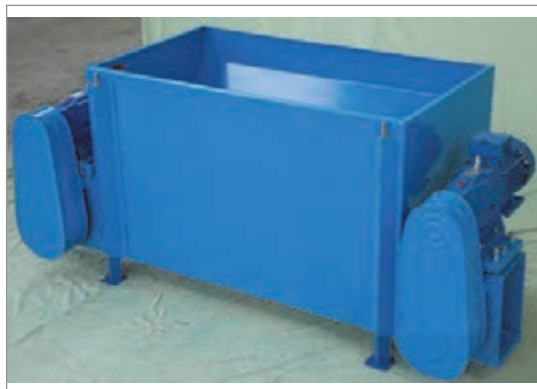
الف) تغییر دور موتور با جعبه دنده در دانخوری زنجیری
