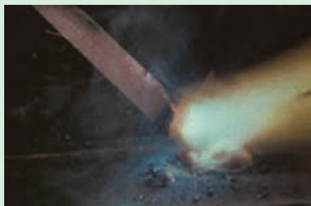
شکل ۲۲- برقراری قوس با الکتروودی که روکش آن کنده شده (عدم برقرار قوس پایدار)
