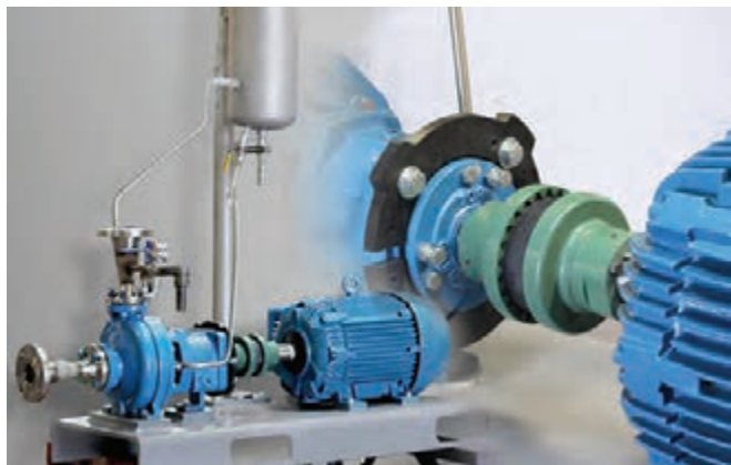
شکل ۸- انتقال قدرت مستقیم از موتور به دستگاه
