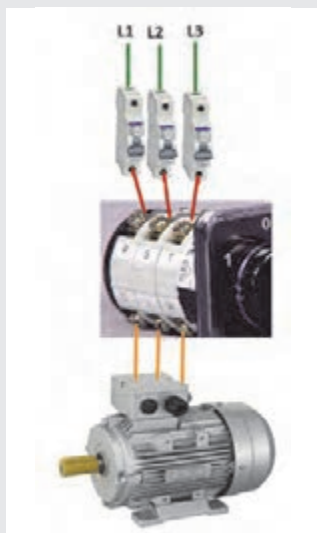
شکل ۲۷- نحوه کابل کشی و برق رسانی به یک موتور سه فاز آسنکرون با کلید زبانه ای (۱-۰)
