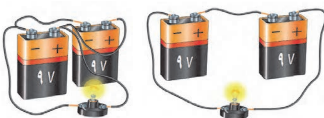
شکل ۴۶- اتصال سری و موازی پیل الکتریکی
