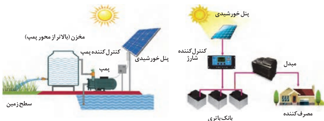
شکل ۴۱- سامانه مستقل از شبکه برق
