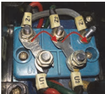
شکل ۱۵- تخته کلم و اتصال سیم پیچ های موتور تک فاز در جهت راست گرد و تبدیل آن به وضعیت چپ گرد با جابه جایی تسمه
