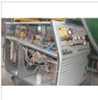
شکل ۹- ساختمان داخلی رکتیفایر
