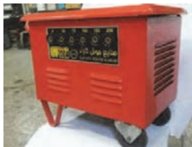
شکل ۶- ترانس با مکانیزم تغییر آمپر پله‌ای
