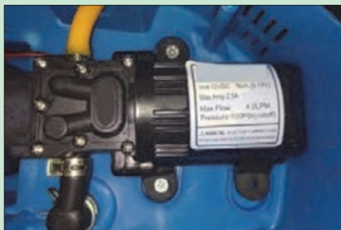
شکل ۵۹- اتصال پمپ و رعایت جهت حرکت سیال
