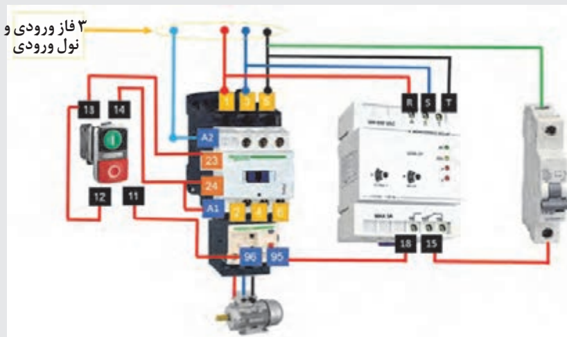
شکل ۳۰- مدار راه اندازی موتور سه فاز با حفاظت کامل و با استفاده از شستی استپ- استارت
