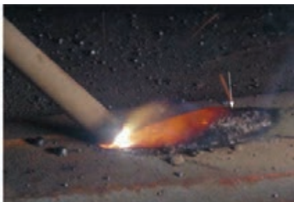
شکل ۲۸- جوشکاری با طول قوس بسیار کم
