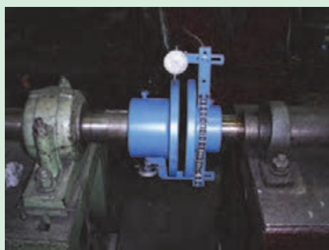
شکل ۸۴- هم راستا کردن محورها با ساعت اندازه گیری
