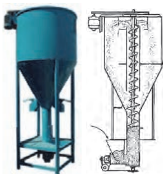
شکل ۲۷- مخلوط‌کن عمودی و نحوه عملکرد آن
