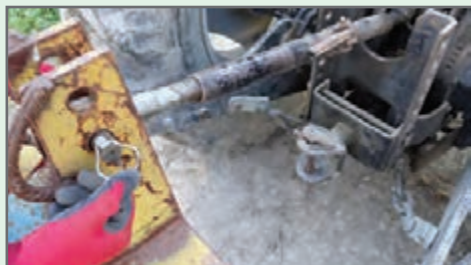
شکل ۲۳- اتصال بازوی وسط تراکتور به نه‌رکن
