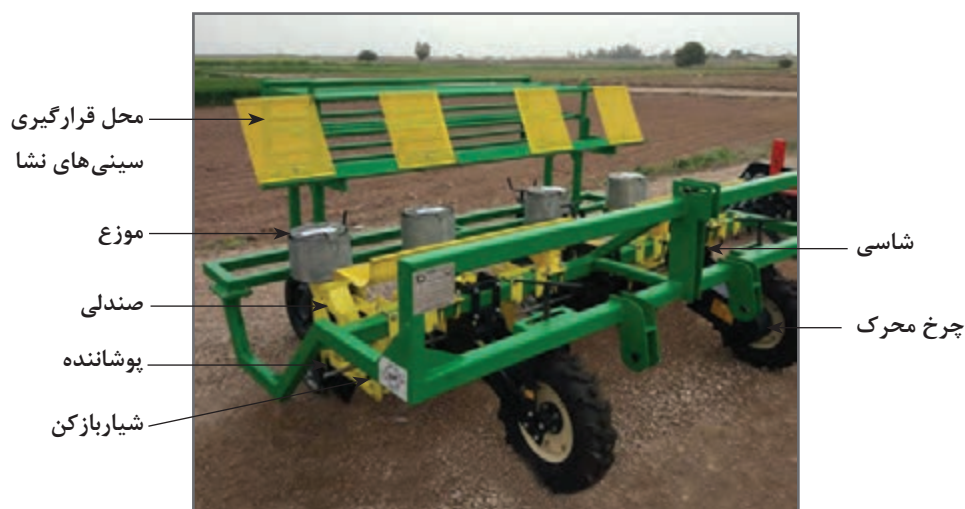
شکل ۹- اجزای ساختمانی یک نمونه نشاکار صیفی
