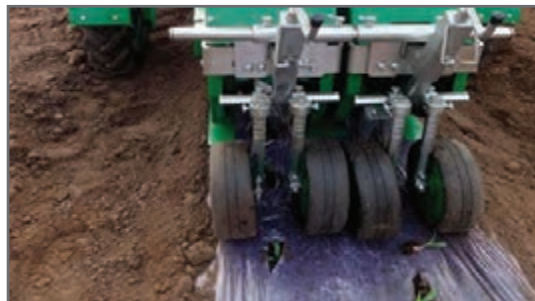
شکل ۷- نشاکار با قابلیت کاشت روی مالچ پلاستیکی
