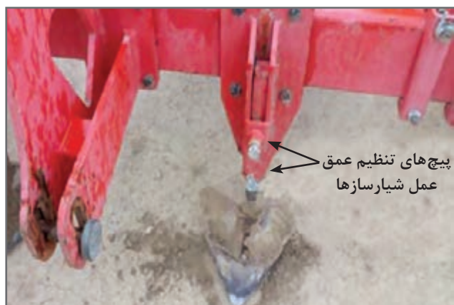
شکل ۱۷- پیچ‌های تنظیم عمق شیارساز
