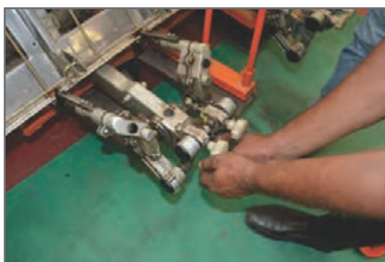
شکل ۱۹- بستن پیچ و مهره بازوی لنگ نشاکار
