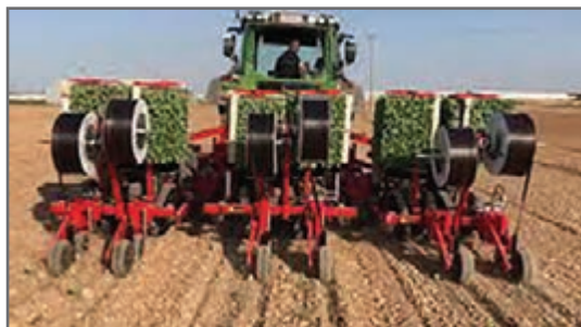
شکل ۸- نشاکار با قابلیت خواباندن نوار تیپ
