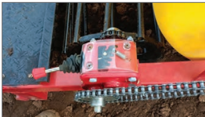
شکل ۱۸- اهرم تنظیم سرعت موزع در یک نوع ماشین حبه‌کار
