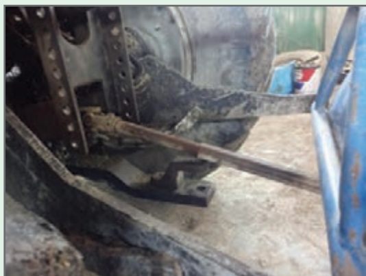
شکل ۸- کنار زدن مالبند ثابت
