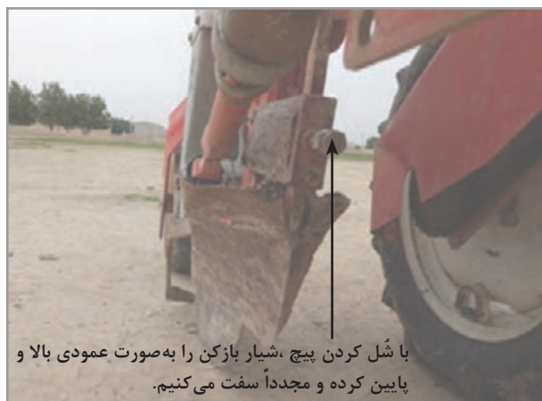
شکل ۲۰- تنظیم شیار بازکن
