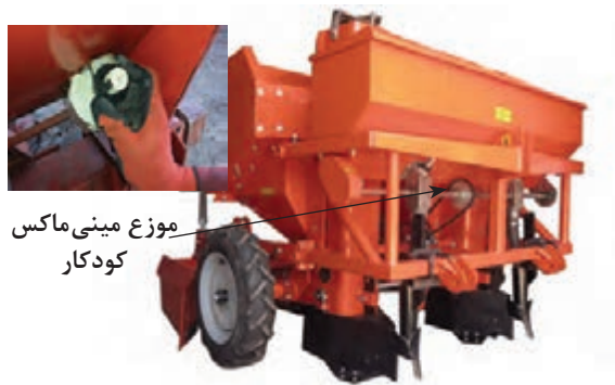
شکل ۱۸- تنظیم موزع مینی ماکس کودکار
