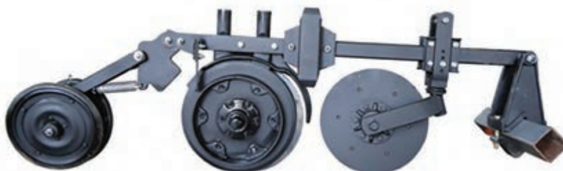
شکل ۱۸- ترتیب و آرایش قرارگیری پیش‌بر، شیاربازکن و چرخ فشاردهنده در خطی کار کشت مستقیم
