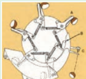
شکل ۱۰- تصویر شماتیک نحوه کار موزع انگشتی
