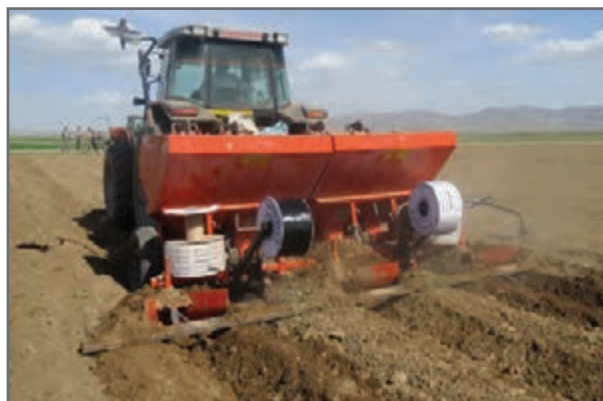
شکل ۱۱- غده کار خودکار با قابلیت خواباندن لوله‌های آبیاری نواری (نوار تیپ)
