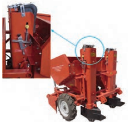
شکل ۱۶- مکانیزم تنظیم کشش نوار نقاله و تک دانه کن
