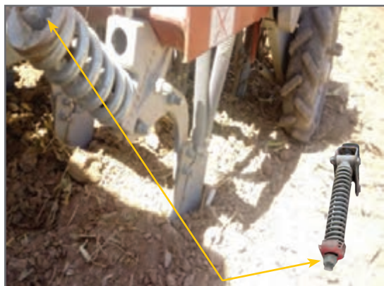
شکل ۳۶- شیار بازکن و مهره نگهدارنده فشر و تنظیم فشار
