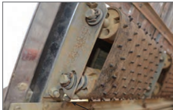
شکل ۱۸- تنظیم کشش تسمه انتقال نشاها
