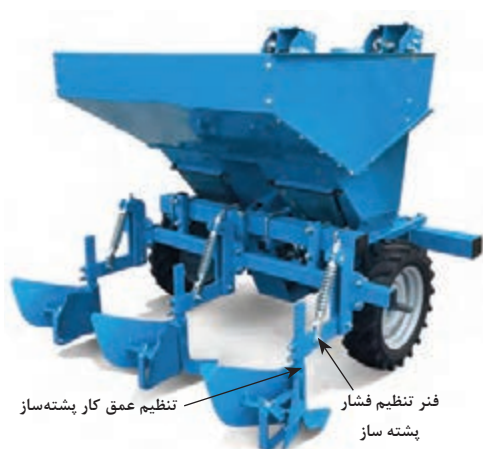
شکل ۱۵- تغییر موقعیت چرخ تثبیت عمق کاشت سیب زمینی کار
