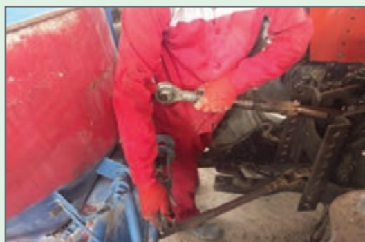
شکل ۱۱- اتصال بازوی وسط تراکتور به بذریاش
