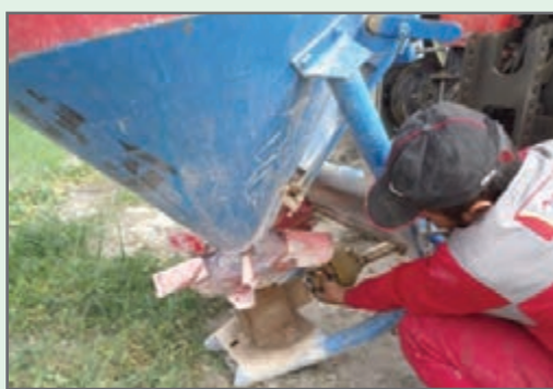
شکل ۱۰- نصب گاردان بین بذریاش و تراکتور
