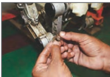
شکل ۲۰- خارج کردن و جازدن مجدد واشر تنظیم
