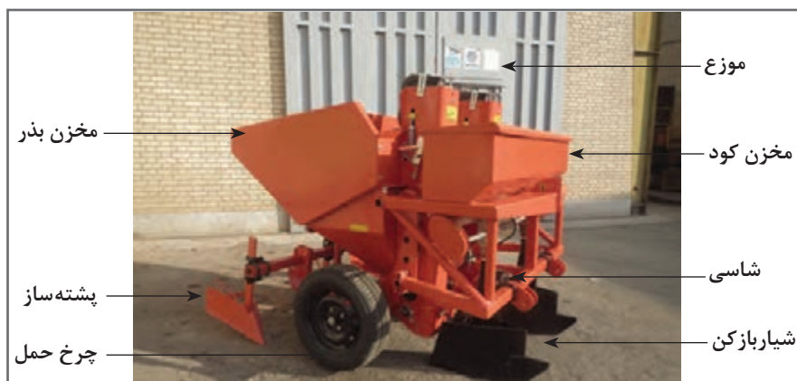
شکل ۵- غده کار خودکار دوردیفه همراه با مخزن کود
