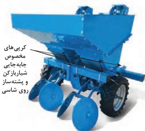
شکل ۱۳- کری های مخصوص تنظیم اندازه پشته
