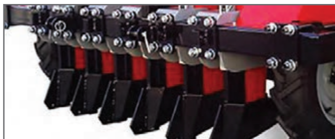
شکل ۱۷- پیچ‌های اتصال شیار بازکن به شاسی
