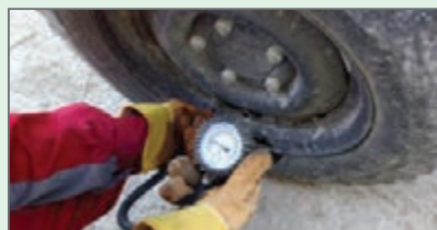
شکل ۱۳- تنظیم باد چرخ ها به مقداری که در دفترچه راهنمای ماشین نوشته شده است.
