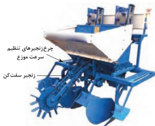
شکل ۱۴- زنجیر و چرخ زنجیر سیستم محرک موزع سیب زمینی کار
