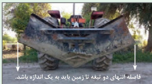
شکل ۲۵- تنظیم تراز عرضی نه‌رکن
