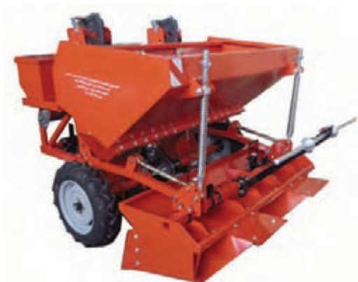
شکل ۱۷- قطعات قابل تنظیم در شکل دهنده پشته ها
