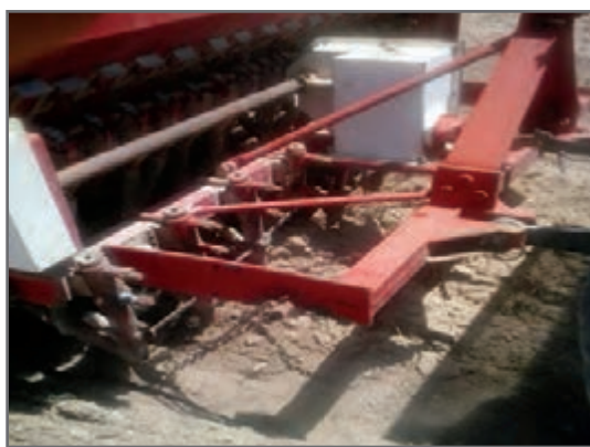
شکل ۳۵- شیار بازکن مستقر شدن با پیچ روی تیر افزار
