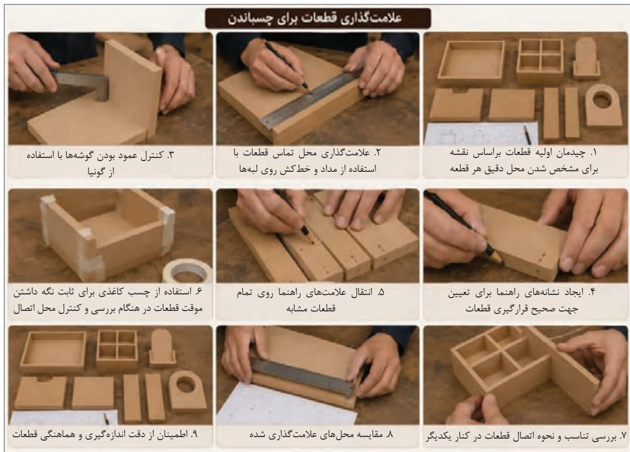
شکل ۱۶- علامت‌گذاری لبه‌های قطعات برای چسباندن
