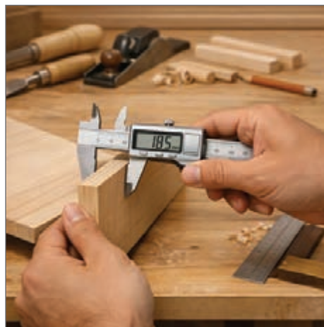
شکل ۱۰- اندازه‌گیری ضخامت چوب با کولیس
