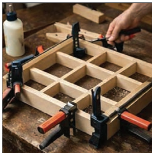
شکل ۳- ساخت و پرس شبکه داخل چارچوب
