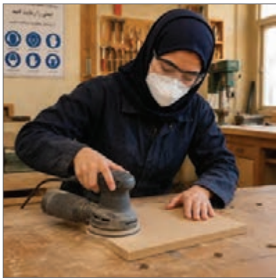
شکل ۴۷- سنباده کاری ام‌دی اف خام با دستگاه سنباده لرزان
