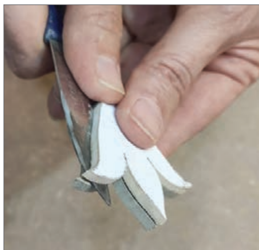
شکل ۱۲- طریقه جداسازی قطعات چوب از الگو با استفاده از تیزک
