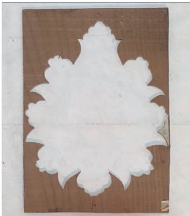
شکل ۲۸- برش چوب زمینه به وسیله اره مویی
