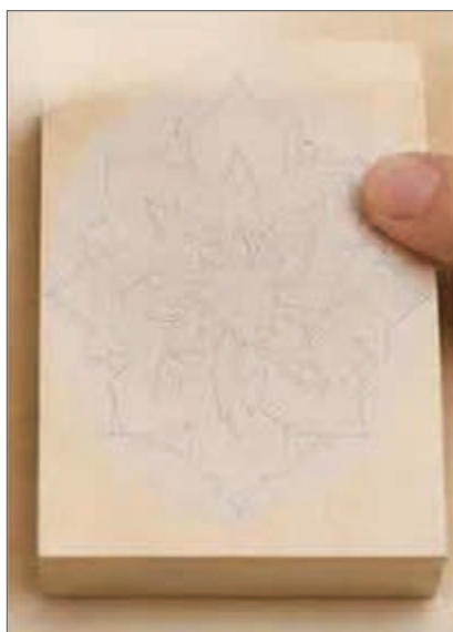
شکل ۳۰- انتقال چسب کالک بر روی قطعات چوب معرق
