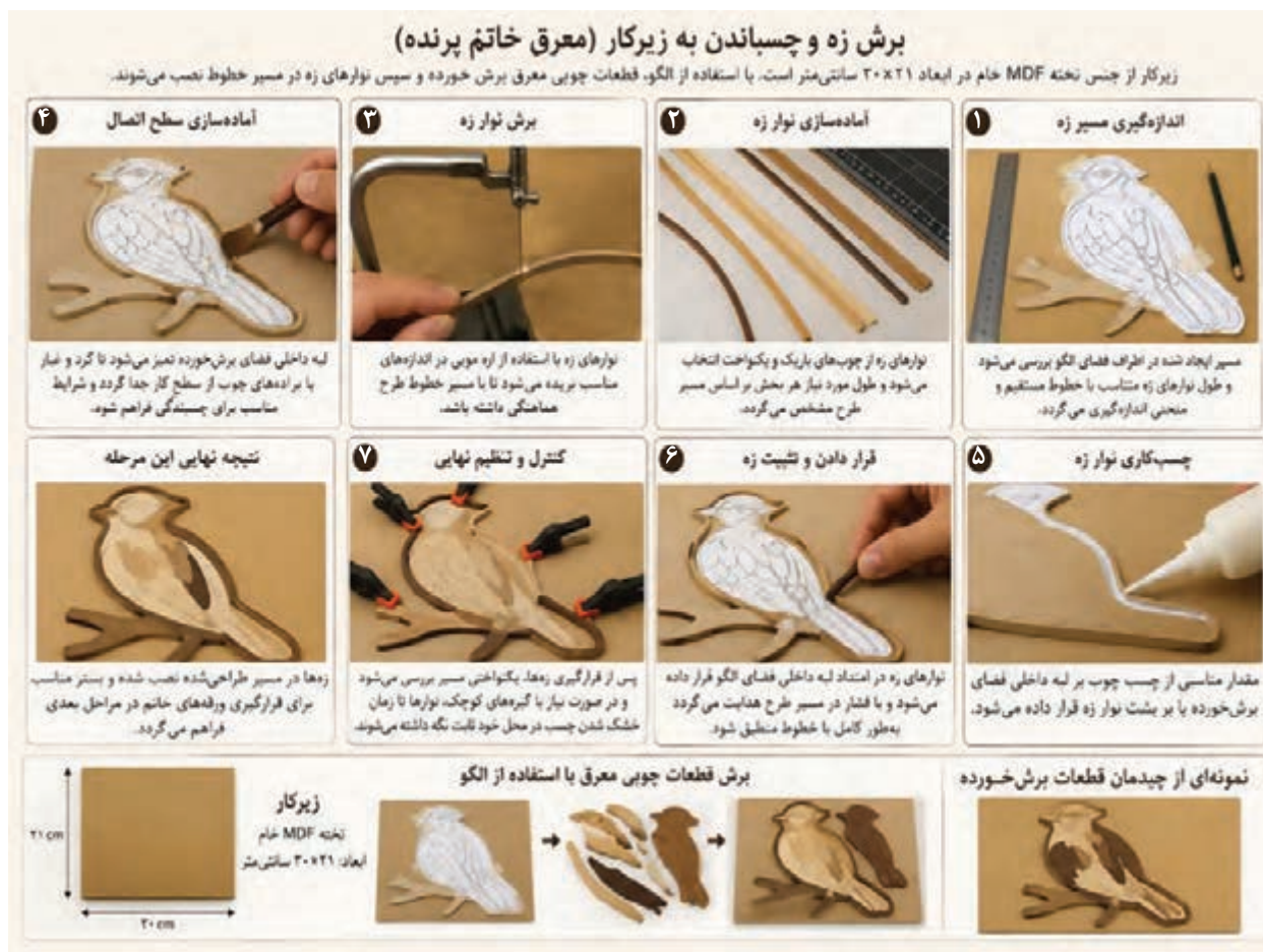
شکل ۱۹- مراحل برش زه و چسباندن به زیرکار
