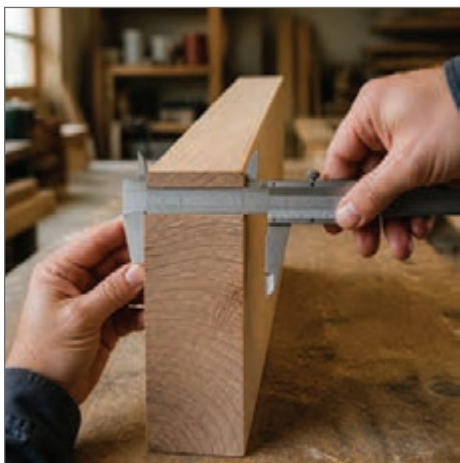
شکل ۱۰- اندازه‌گیری ضخامت چوب با کولیس
