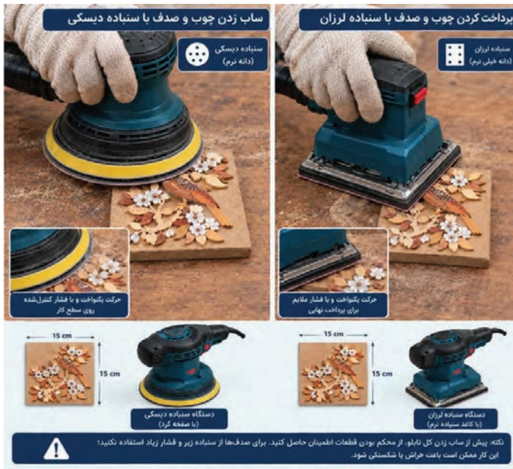
شکل ۱۳- ساب زدن قطعات چوب و صدف با دستگاه‌های سنباده‌زن
