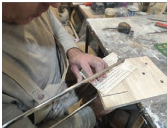
شکل ۱۹- روش برش خطوط صاف و گرفتن کمان اره مویی
