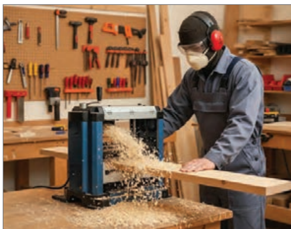
شکل ۱۱- تنظیم ضخامت چوب با دستگاه گندگی
