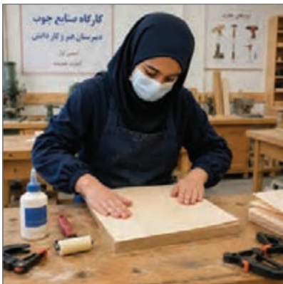
شکل ۴۹- چسباندن روکش بر روی زیرکار (ام‌دی اف خام)
