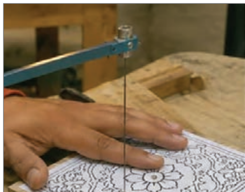
شکل ۲۶- برش کاری قطعات مشبک با اره مویی
