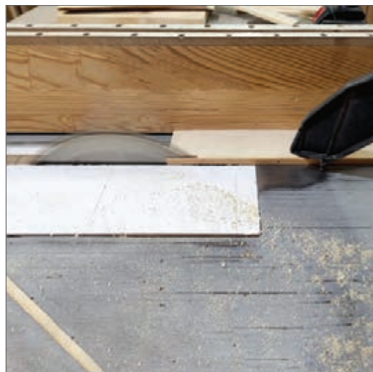
شکل ۶- برش زیرکار با دستگاه اره گرد رومیزی
