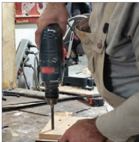
شکل ۶- سوراخ کردن جای پیچ پیشکار توسط دریل
