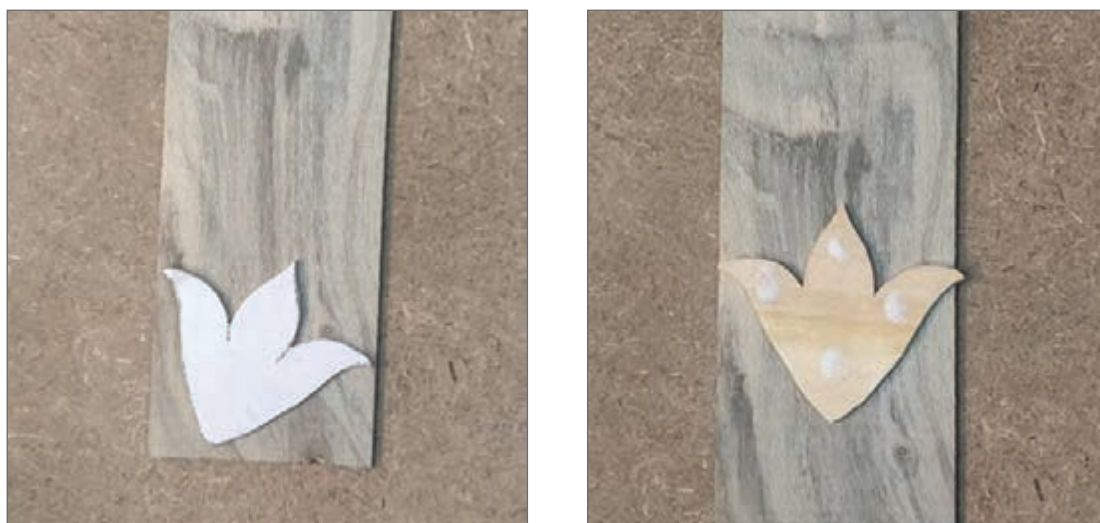
شکل ۱۰- تثبیت الگو بر روی چوب با روش خال چسب
