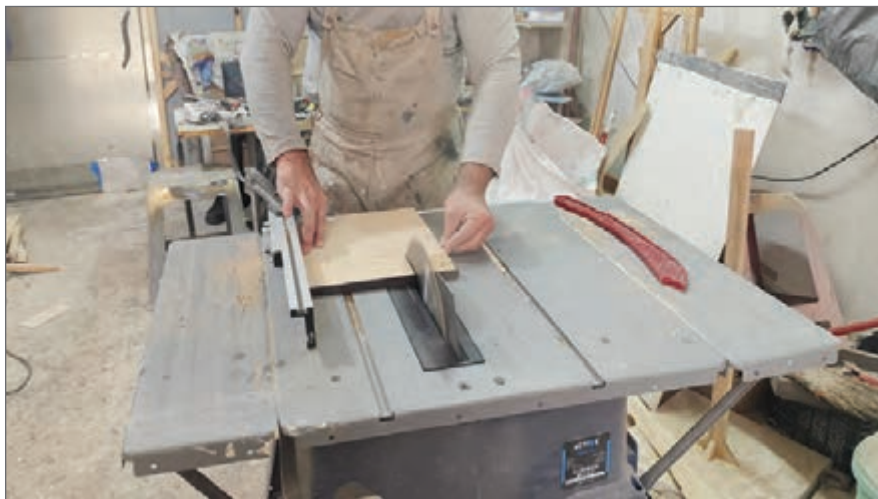
شکل ۲- برش ابعاد پیشکار با دستگاه اره گرد میزی
