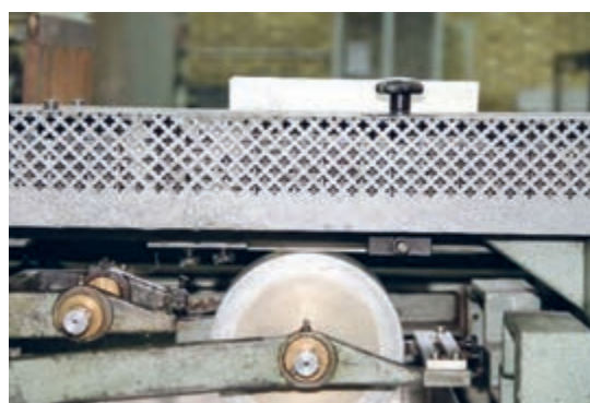
شکل ۳۲- دستگاه ته‌چسب بلوک‌های دوخته شده و خشک‌کن چسب عطف
