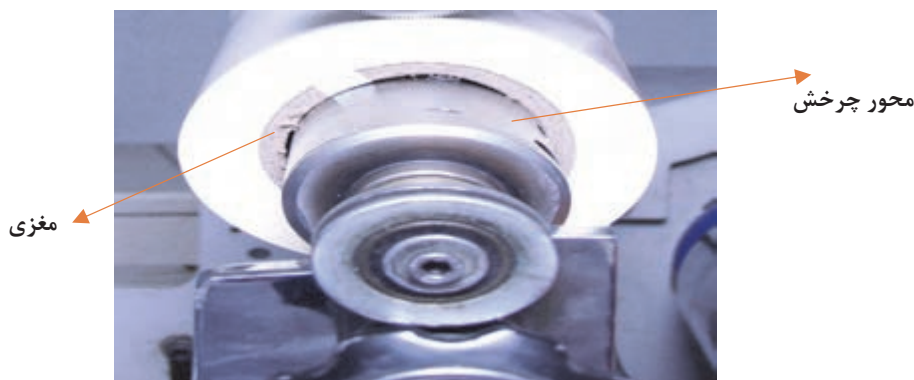
شکل ۲۹- تناسب مغزی سلفون با محور چرخشی دستگاه
