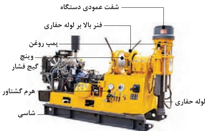
شکل ۱۳- دستگاه حفاری هیدرولیکی وایر لاین دارای وینچ
