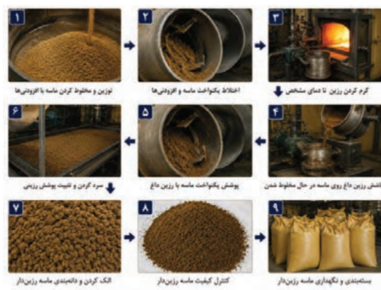
شکل ۲۲ - فرایند تهیه ماسه رزین دار با رزین فنولیک جامد
