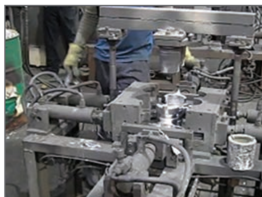
(ج) ریخته‌گری در قالب فلزی (ریژه)
