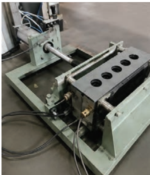
(ب) ماشین ماهیچه گیری با گرمکن الکتریکی و سیستم پنوماتیکی
