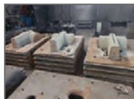
ت) دمش گاز CO_2 به قالب
