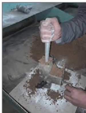
ب) متراکم کردن مخلوط در جعبه ماهیچه با کوبه دستی
