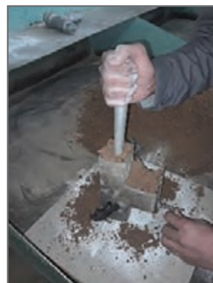
(الف) متراکم کردن مخلوط در جعبه ماهیچه با کوبه دستی
