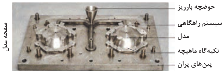
ب) نمونه صفحه مدل صنعتی مورد استفاده در فرایند قالب گیری پوسته‌ای
