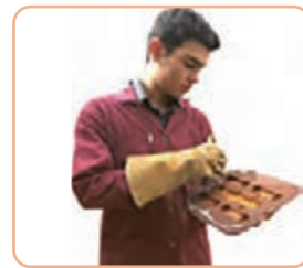
ز) تمیزکاری، اصلاح لبه‌ها و چسب زدن اطراف نیم‌پوسته
