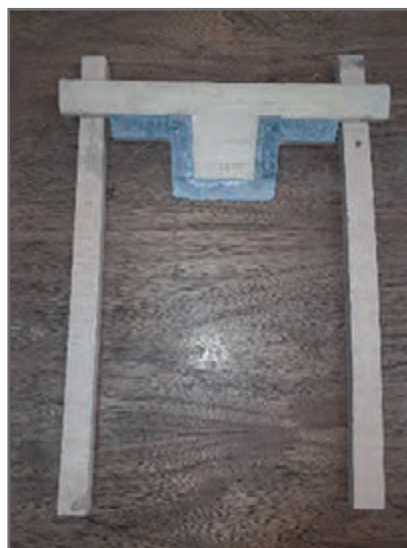
نمونه شابلون کششی با پروفیل شماره ۱ روی تیغه‌های راهنما
