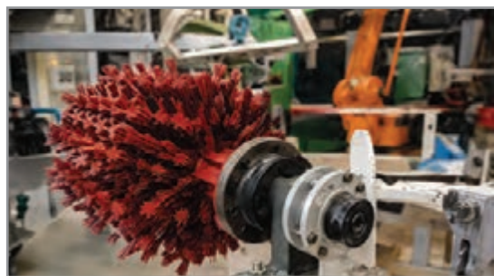
شکل ۲۵- میله فولادی مونتاژ خوشه مومی در ریخته‌گری دقیق
