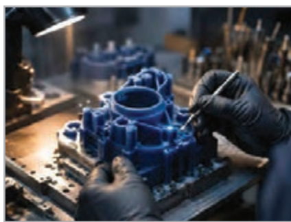
الف) کاردک گرم برای مونتاژ مدل‌های مومی
