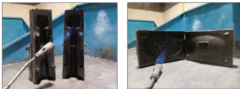
شکل ۱۹- پیش‌گرم کردن قالب‌های فلزی ریژه با مشعل گازی دستی
