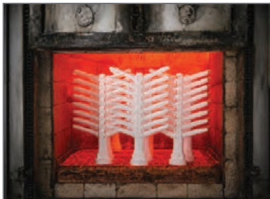
شکل ۲۶- ایجاد شیب در دسته مدل‌ها برای خروج آسان‌تر موم در مرحله موم‌زدایی
