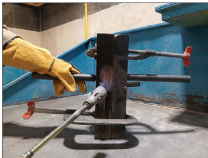
شکل ۲۲- استفاده از گیره برای بستن و هم‌راستا کردن دو نیمه قالب ریژه
