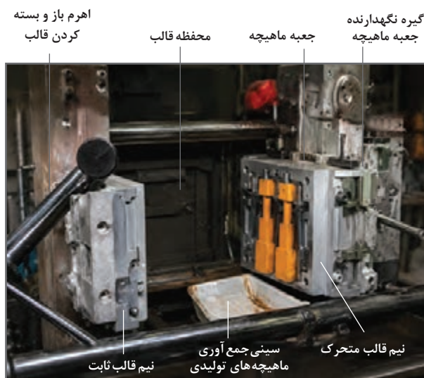
شکل ۷- ماشین های ماهیچه گیری با گرمکن الکتریکی
