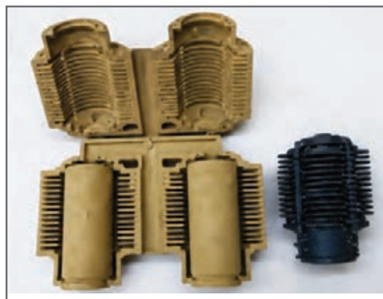
شکل ۱۱- قطعات ریخته‌گری شده به روش قالب پوسته‌ای
