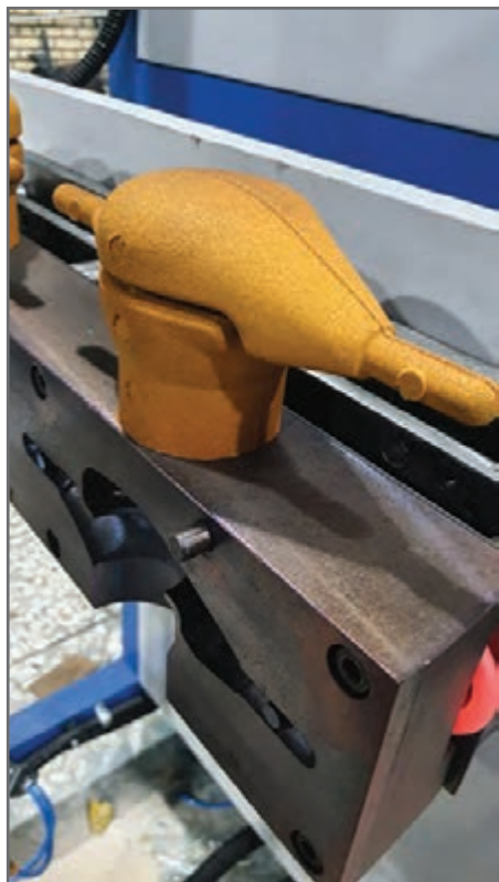
ب) ماهیچه تولید شده به‌روش جعبه ماهیچه گرم
