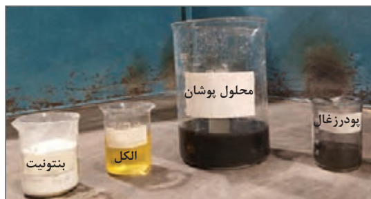
شکل ۲۰- سوسپانسیون پوشان آماده شده حاوی پودر زغال، بنتونیت و الکل
