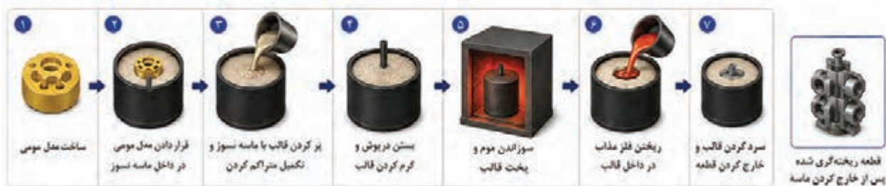
شکل ۱۳- مراحل مختلف ریخته‌گری دقیق به روش پوشته‌ای سرامیکی و توپر
