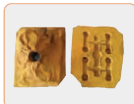
و) آماده‌سازی و ساخت نیمه دوم قالب (مطابق مراحل ساخت نیمه اول)
