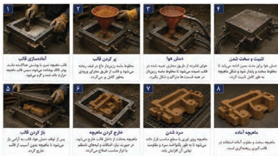
شکل ۲۵- مراحل ماهیچه گیری به روش فوران جعبه گرم
