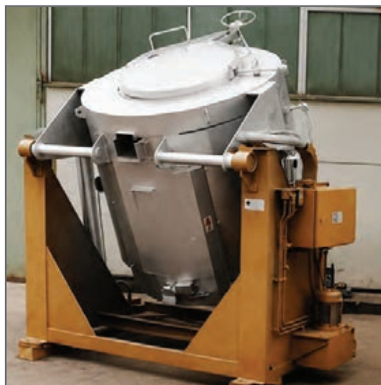
شکل ۱۸- کوره زمینی بوت‌ه‌ای متحرک
