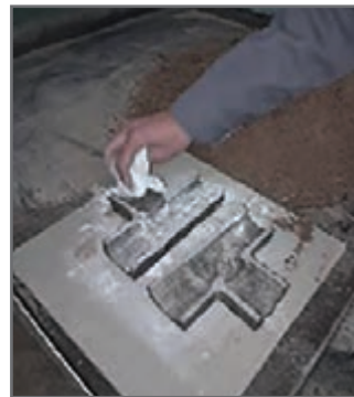
الف) پوشاندن جعبه ماهیچه با پودر جدايش
