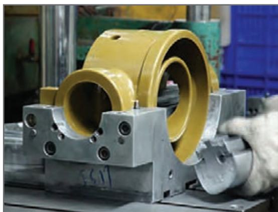
شکل ۲۰- مدل مومی ساخته شده به روش تزریق در قالب فلزی
