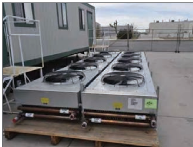
شکل ۳۵- سیستم آب‌گرد با هوای خشک
