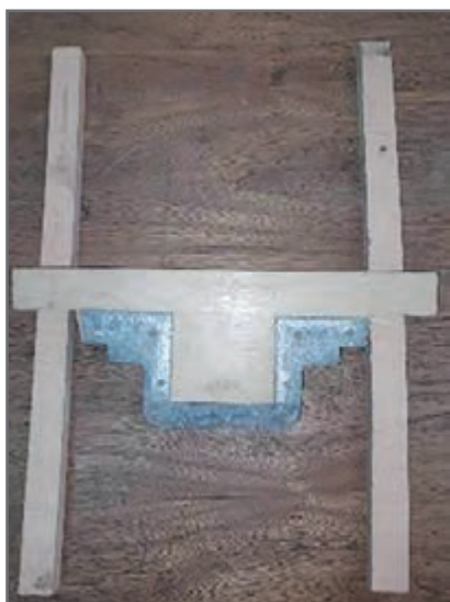
نمونه شابلون کششی با پروفیل شماره ۲ روی تیغه‌های راهنما
