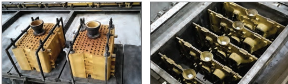
شکل ۱۰- خوشه قالب‌های پوسته‌ای مونتاژ شده و آماده ذوب‌ریزی
