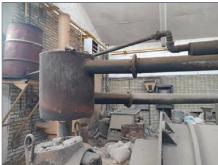
شکل ۱۵- نمونه‌ای از منبع یا مخزن سوخت کوره دوار
