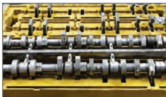
شکل ۱۰- خوشه قالب‌های پوسته‌ای مونتاژ شده و آماده ذوب‌ریزی
