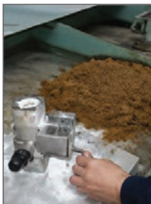
(ب) دمش گاز CO_2 برای سخت شدن ماهیچه
