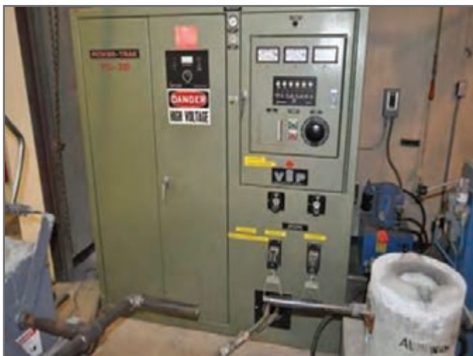
شکل ۳۲- منبع تغذیه ۷۵ کیلوواتی کوره القایی
