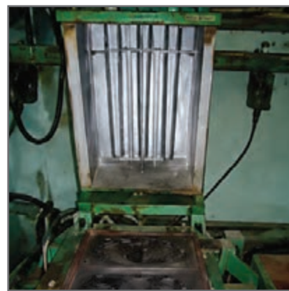
(الف) آماده‌سازی صفحه داغ قالب‌گیری پوسته‌ای
