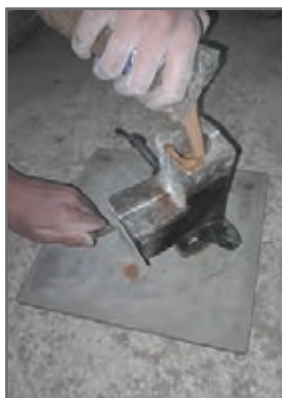
(د) پر کردن جعبه ماهیچه با مخلوط ماهیچه گیری
