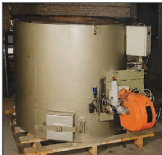
شکل ۱۷- کوره زمینی بوت‌ه‌ای ثابت
