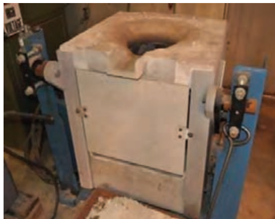
شکل ۲۸- کوره القایی بدون هسته با ظرفیت ۲۰۰ پوند
