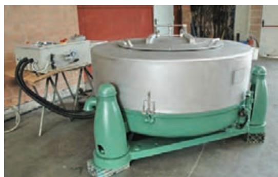
شکل ۱۳- سانتریفوژ آبگیری و نحوه آویزان کردن کلاف‌ها در فضای باز جهت خشک شدن
