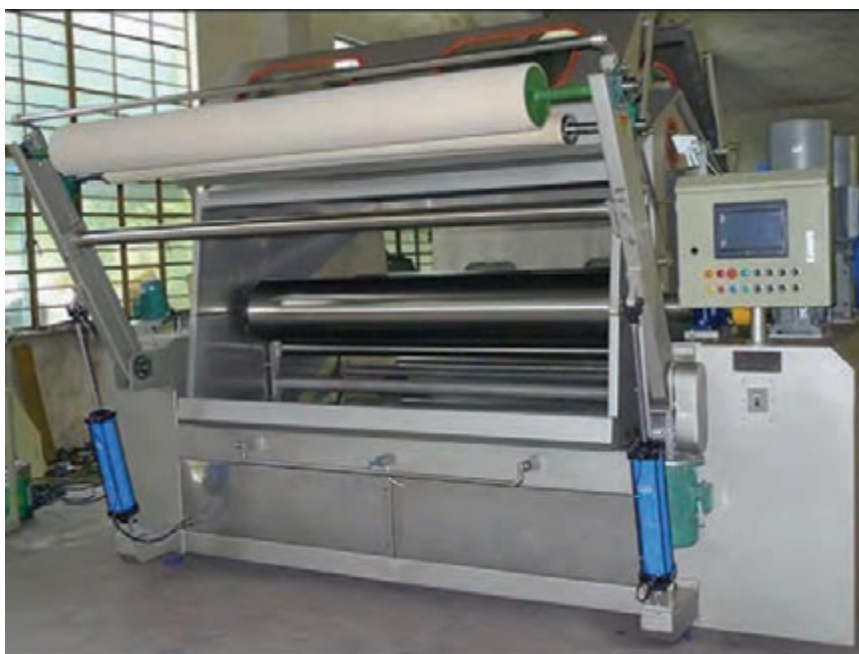
شکل ۴- برخی از اجزای یک ژیگر معمولی
