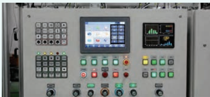
شکل پانل دستگاه رنگری وینچ
