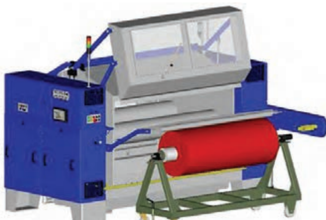
شکل ۶- یک ماشین ژيگر در دار و پارچه رنگرزی شده روی خرک
