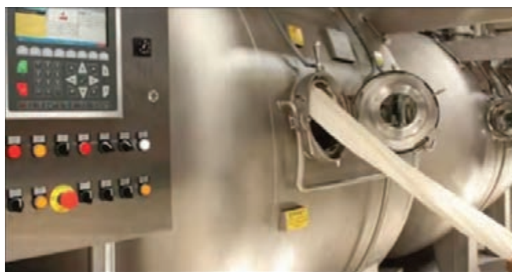
شکل ۹- فرم طنابی شده پارچه جهت رنگریزی در ماشین وینچ
