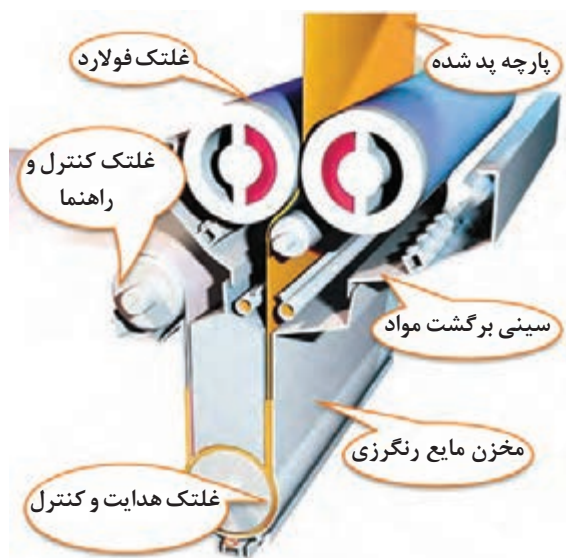
شکل ۴- نمای شماتیک قسمت‌های اصلی فولارد
