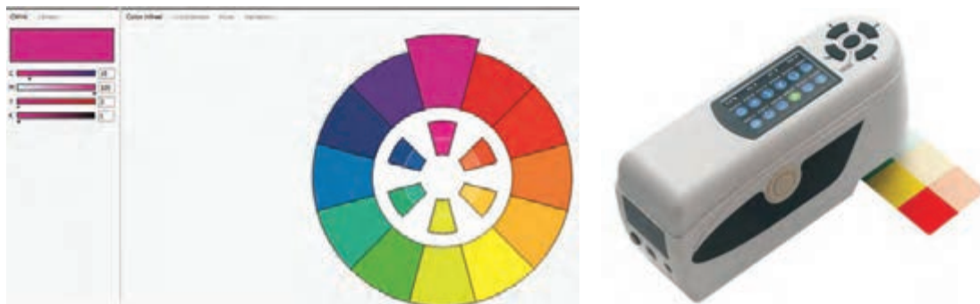
شکل ۵- تصویری از یک نرم‌افزار کاربردی رنگ‌سنجی در محیط ویندوز و یک اسپکتروفوتومتر انعکاسی
