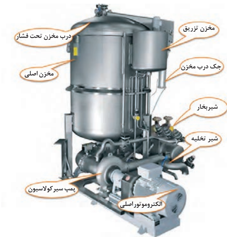
شکل ۱۹- اجزای خارجی یک دستگاه بوبین رنگ کنی عمودی (ایستاده)
