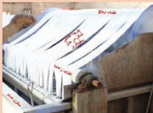
یک ماشین وینچ یا هاسپل در حال عمل سفیدگری
