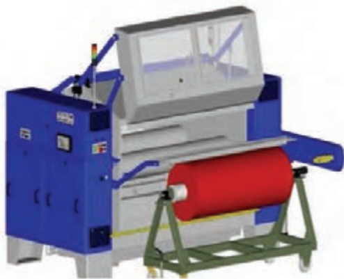
شکل ۱۸- تصویر یک ماشین ژیگر و پارچه رنگریزی شده روی خرک
