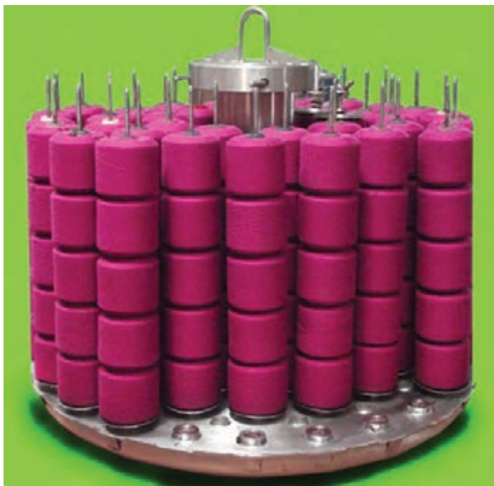
شکل ۲۴- بوبین‌های رنگریزی شده داخل قفسه بوبین جهت آبیگری و خشک کردن
