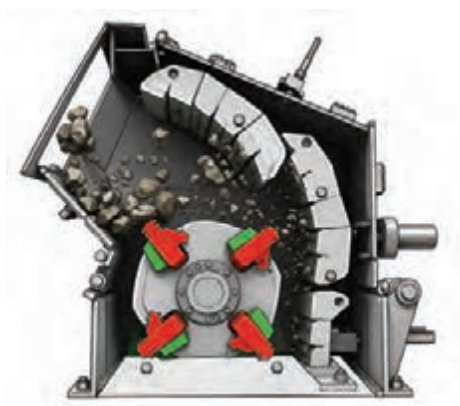
شکل ۴۱- سنگ شکن پرتابی شافت افقی
