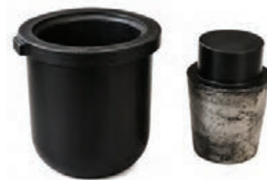
شکل ۲۰- قالب و پانچ پلی‌یورتانی جهت تولید گلوله
