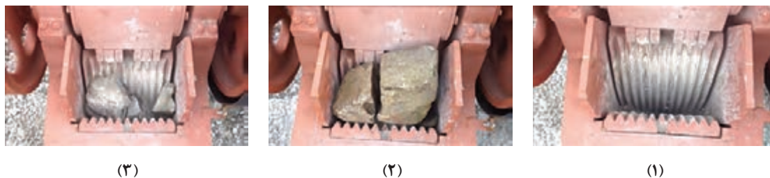
شکل ۲۲- مراحل خردایش سنگ در سنگ‌شکن فکی
