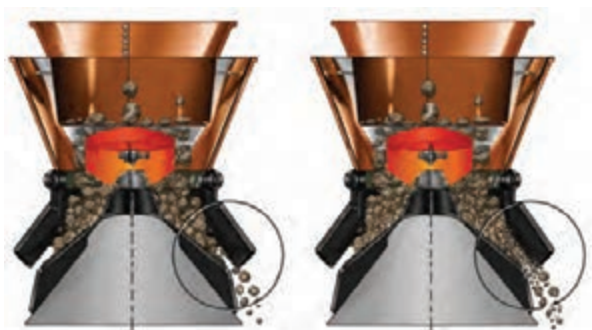
شکل ۳۰- خردایش در سنگ شکن مخروطی
