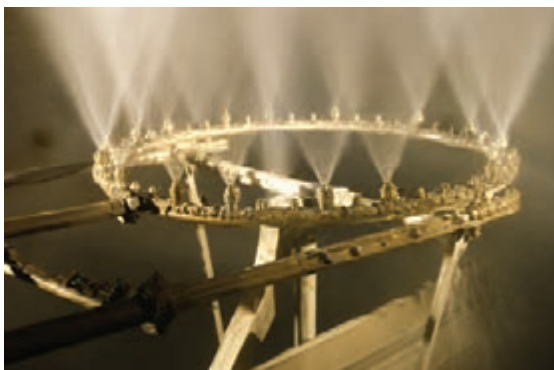
شکل ۳۰- چیدمان چندین افشانک نازلی در یک خشک کن پاششی
