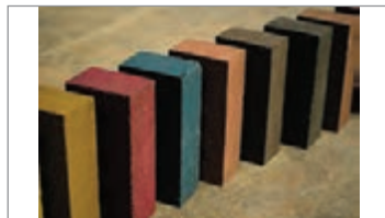
شکل ۲۱- استفاده از دورریز ساخت و ساز و بازیافتی در تولید آجر و کاشی
