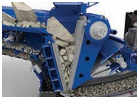
(د) سنگ شکن با اعمال نیروی فشار و سایش
