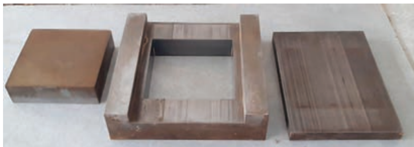
شکل ۱۳- اجزای قالب فولادی
