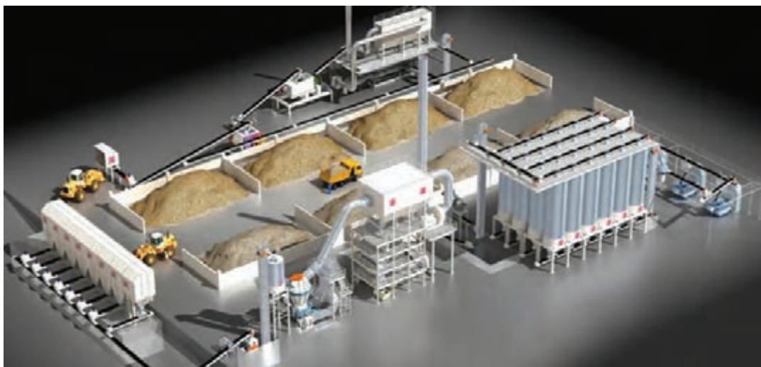
شکل ۳۱- تولید پودر به روش خشک (گرانول خشک)
