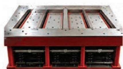
شکل ۱۷- قالب ۴ حفره برای کاشی‌های با ابعاد کوچک
