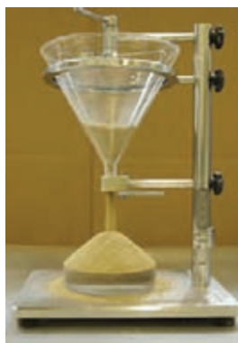
شکل ۵۱- نحوه عملکرد دستگاه تعیین زاویه خواب برای تعیین جریان یابی گرانول
