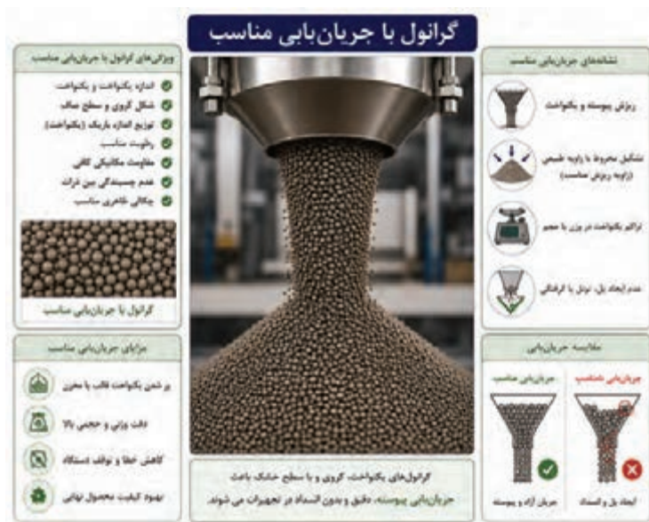
شکل ۹- گرانول با جریان یابی مناسب
