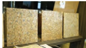
شکل ۲۱- استفاده از دورریز ساخت و ساز و بازیافتی در تولید آجر و کاشی
