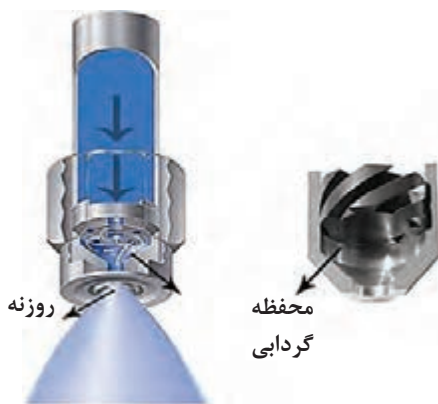
شکل ۲۸ - افشانک نازلی نوع گردابی
