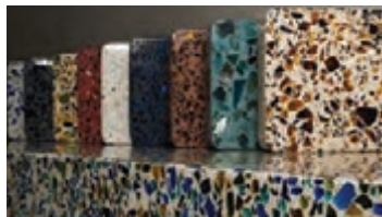
شکل ۲۱- استفاده از دورریز ساخت و ساز و بازیافتی در تولید آجر و کاشی
