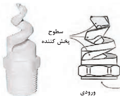
شکل ۲۷ - افشانک نازلی نوع حلزونی
