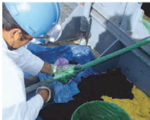
شکل ۲۲-۱ روان کاری طناب سیمی با گریس
