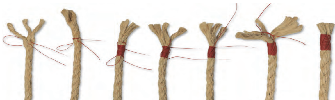
شکل ۲-۲۱- نخ‌پیچی کردن انتهای طناب
