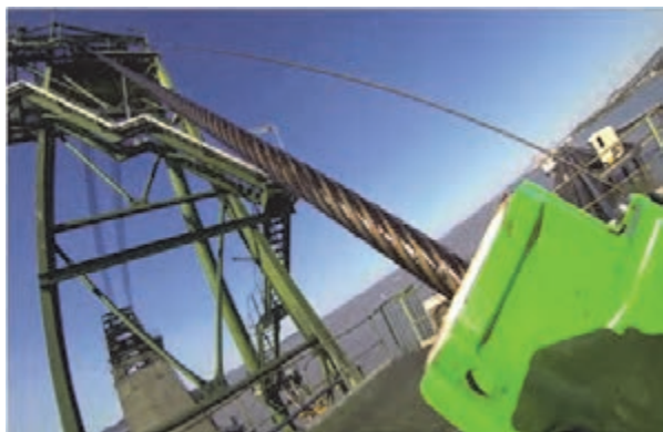
شکل ۲۲-۱ روان کاری طناب سیمی با گریس
