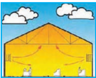
تصویر ۱-۲ مقایسه‌ی سیستم‌های گرمایشی جابه‌جایی و تابشی
