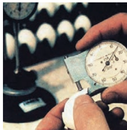
تصویر ۲۵-۱- اندازه‌گیری ضخامت یوسته با میکرومتر
