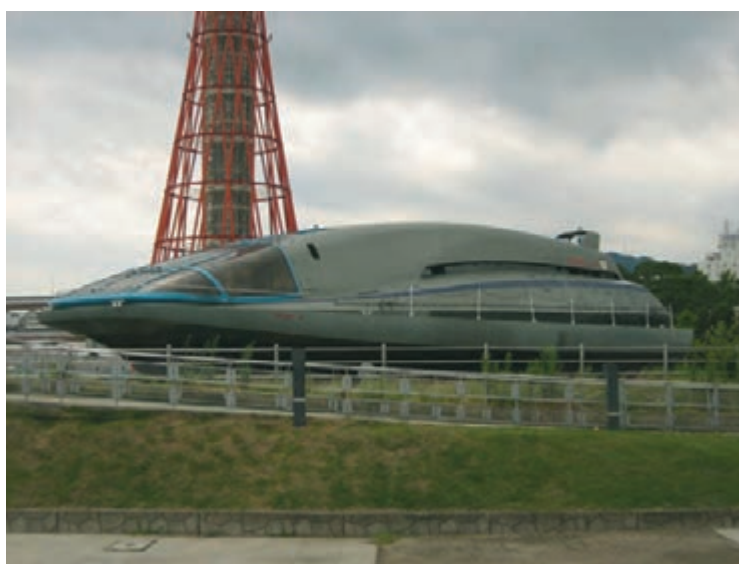
شکل ۳- کشتی رانش مغناطیسی یاماموتو (Yamato)
