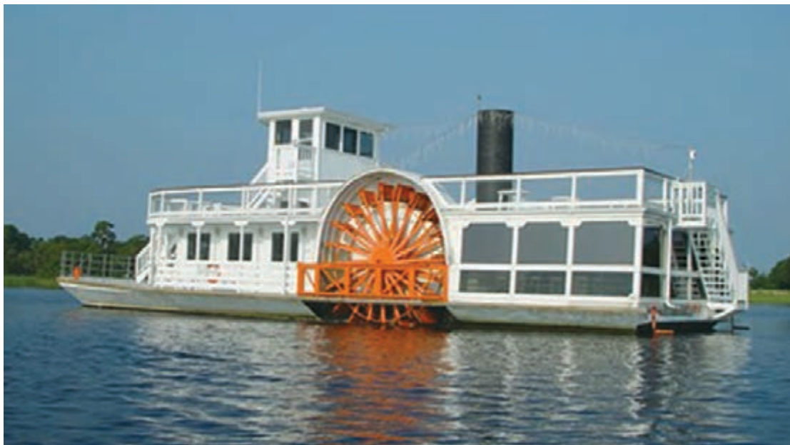
شکل ۱- سامانه پیشران چرخ پدالی
