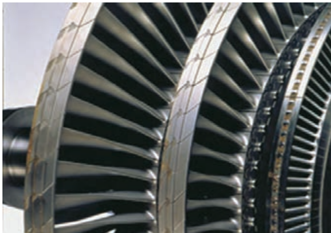
شکل ۷- محل اتصال پره‌ها با چرخ
