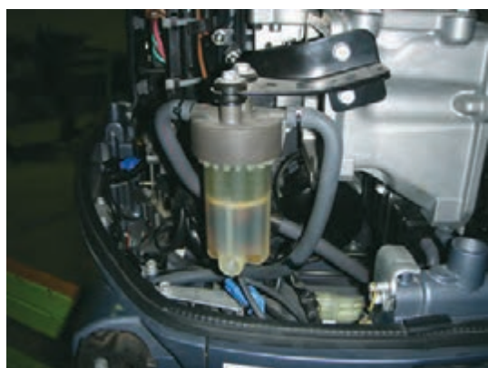
شکل ۴- پالایه اولیه سوخت
