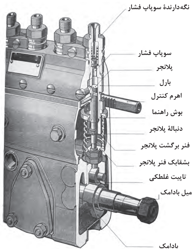
شکل ۳۱- پمپ انژکتور نوع جرک
