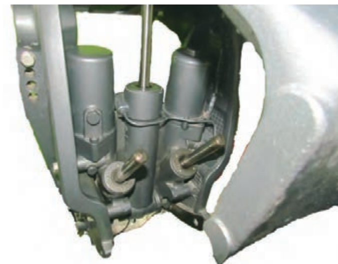
شکل ۳۷- سامانه جک هیدرولیکی
