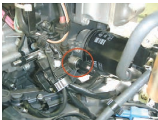
شکل ۲۱- حسگر فشار روغن
