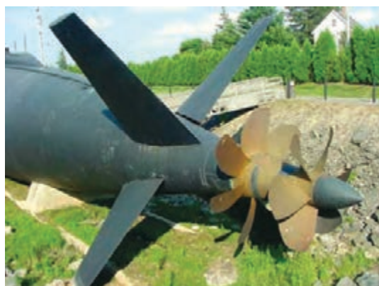
شکل ۸- پروانه های عکس چرخنده
