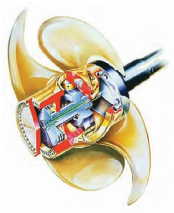
شکل ۷- پروانه گام متغیر
