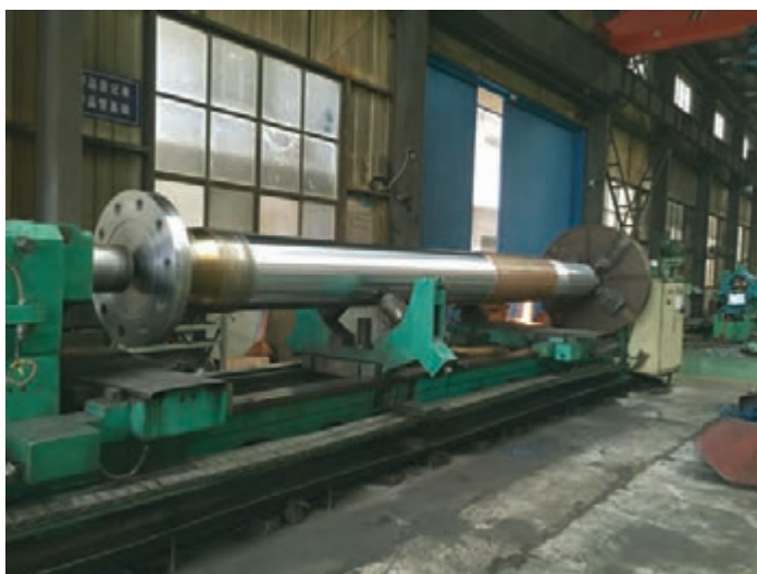
شکل ۱۰- محور پروانه در کارگاه جهت ماشین‌کاری
