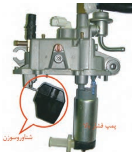
شکل ۸- مجموعه داخل مخزن تفکیک بخار
