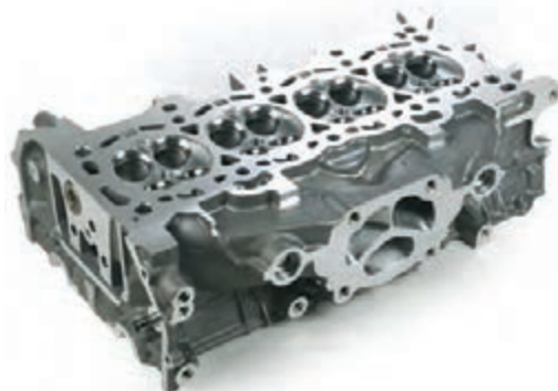
شکل ۴- سرسیلندر
