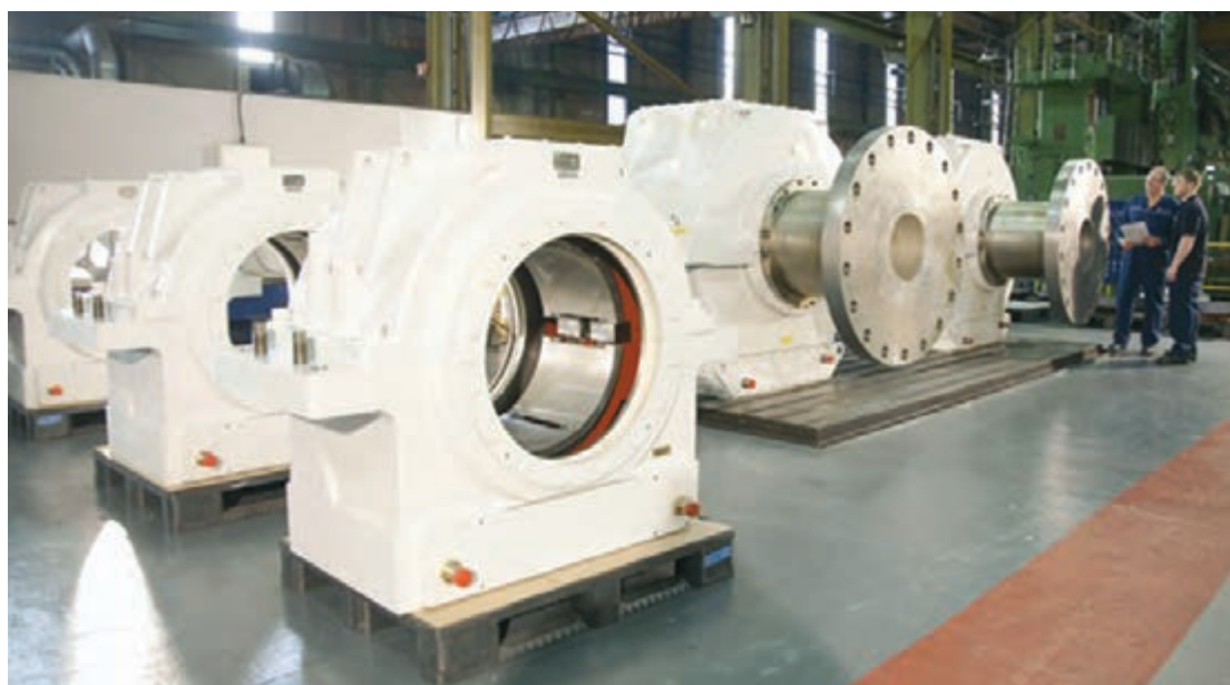
شکل ۲۴- یاتاقان‌های مورد استفاده جهت تکیه‌گاه محور پروانه
