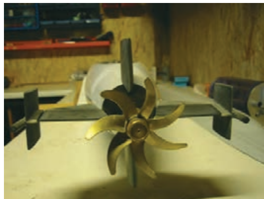
شکل ۶- پروانه گام ثابت
