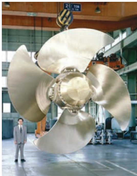
شکل ۷- پروانه گام متغیر
