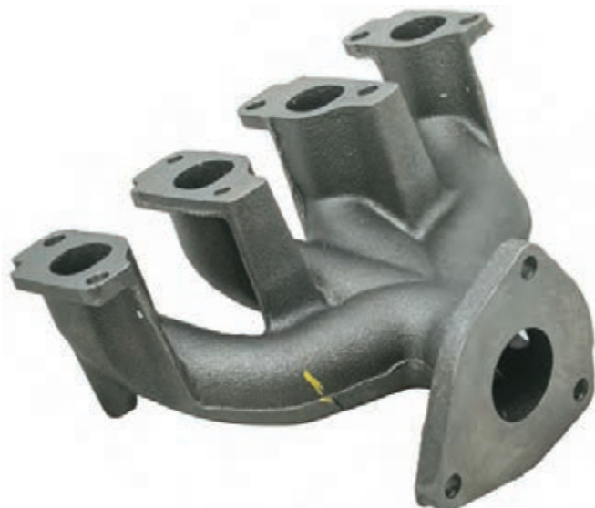
شکل ۱۵- چند راهه ورود هوا
