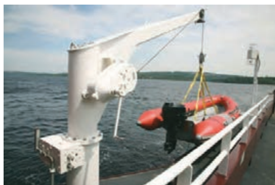
شکل ۲۴- قرقره ثابت
