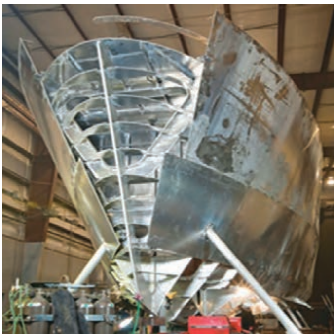
شکل ۲۳- سازه سینه یک شناور در حال ساخت
