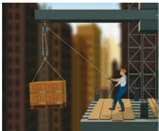
شکل ۲۶- ترکیب دو قرقه برای افزایش بهره مکانیکی
