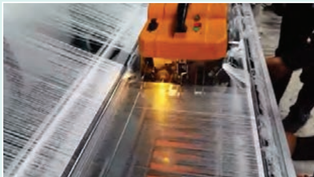
شکل ۲۵ - گره زدن نخ‌های لایه زیر (نخ‌های روی ماشین) با نخ‌های لایه رو (نخ‌های روی قرقره جدید)
