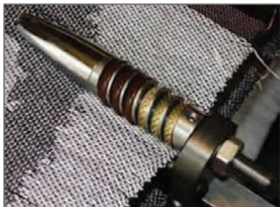
شکل ۱۳- لبه گیر پارچه
