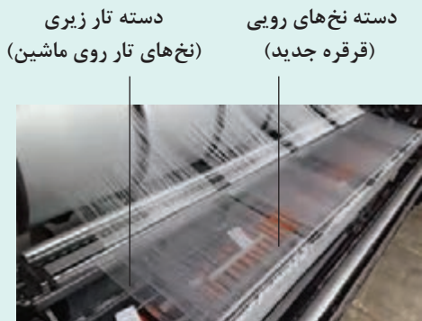
شکل ۲۴ - لایه‌های نخ تار در شاسی ماشین گره زن
