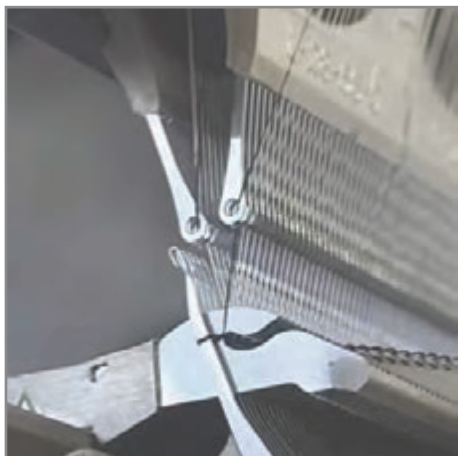
شکل ۳۸- مرحله آندرلپ حرکت شانه پشت سوزن
