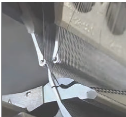
شکل ۴۱- تغذیه نخ و گرفتن تارها توسط سوزن‌ها
