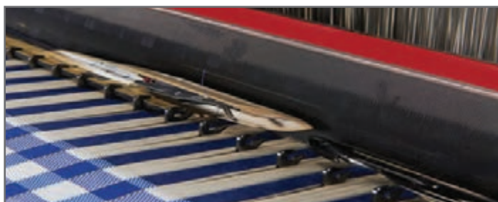
شکل ۱۷- راپیر و راهنماها و نحوه انتقال پود
