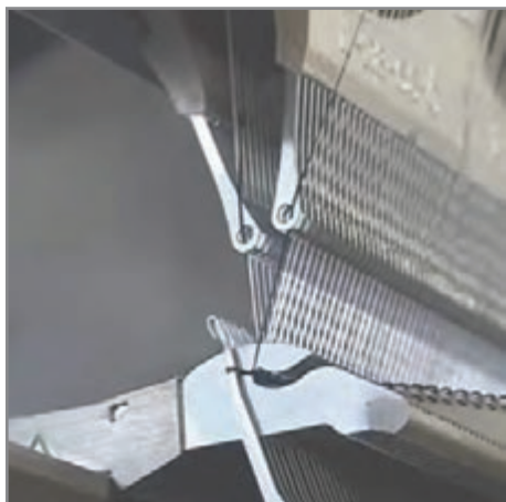
شکل ۳۷- مرحله ۱ قرارگرفتن حلقه روی ساقه سوزن
