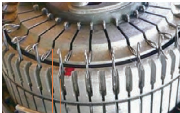
سوزن‌های روی صفحه سوزن‌های روی سیلندر
