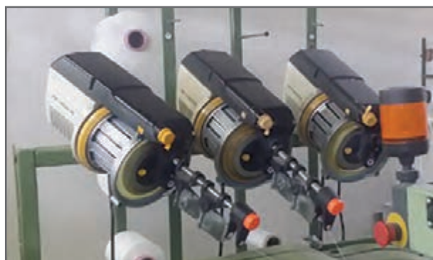
شکل ۲۷- سیستم رزرو نخ پود
