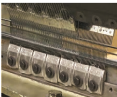
شکل ۳۱ - نصب بلوک سوزن‌ها با پیچ روی صفحه
