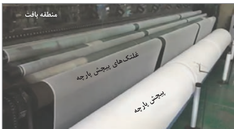
شکل ۵۲ - غلتک‌های کشش و پیچش پارچه
