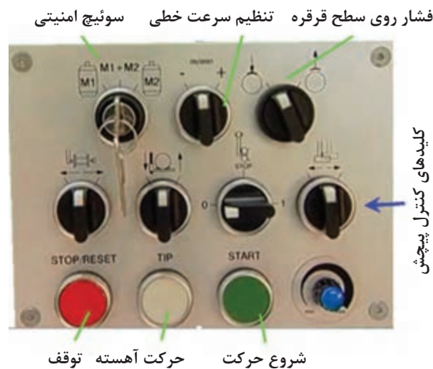
شکل ۱۲ - کلیدهای راه‌اندازی یک دستگاه پیچش قرقره
