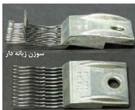
شکل ۳۱ - نصب بلوک سوزن‌ها با پیچ روی صفحه
