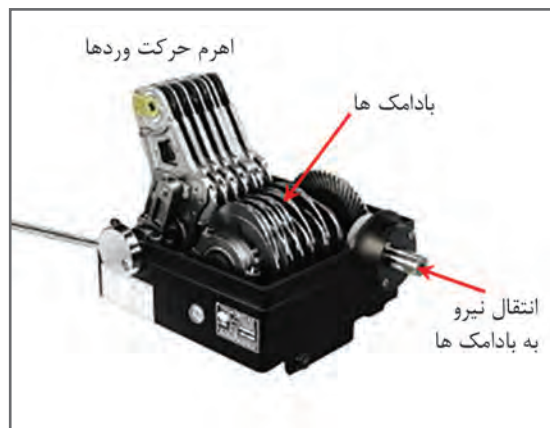
شکل ۱۱- مکانیزم بادامک خارجی
