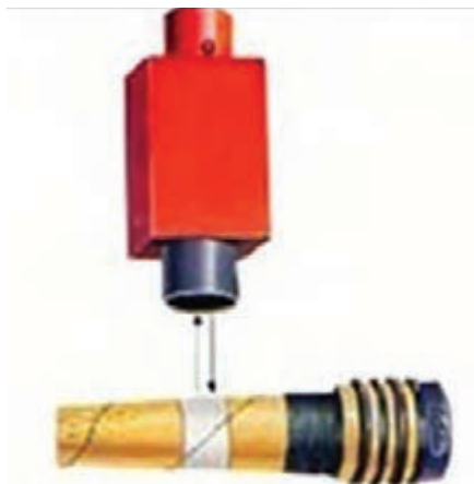
شکل ۸- مکانیزم فتوالکتریکی حس کننده ماسوره خالی
