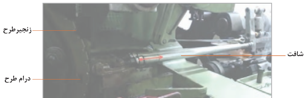
شکل ۵۰- درام طرح و شافت رابط
