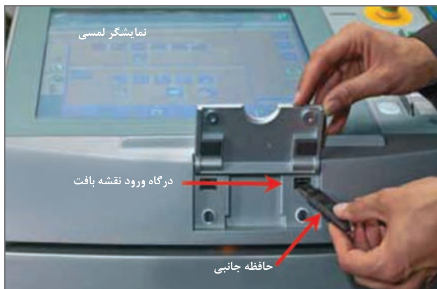
شکل ۳۵- نحوه اتصال حافظه جانبی به ماشین بافندگی
