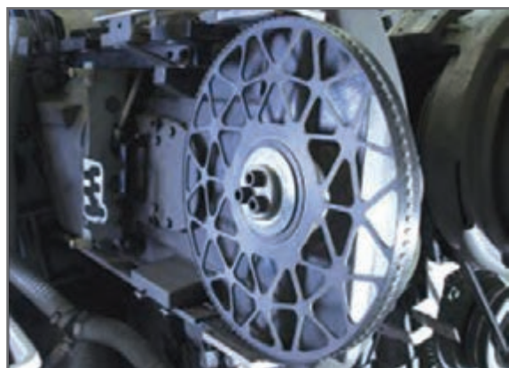
شکل ۱۹- غلتک دوران کننده و محرک راپیر
