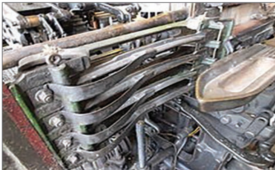
شکل ۹- چهار جعبه ماکو در یک ماشین بافندگی
