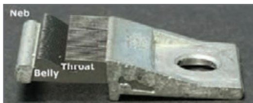
شکل ۳۲ - قالب یک اینچی سینکر
