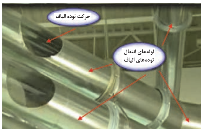
شکل ۸- لوله‌های انتقال الیاف در سیستم شوت فید
