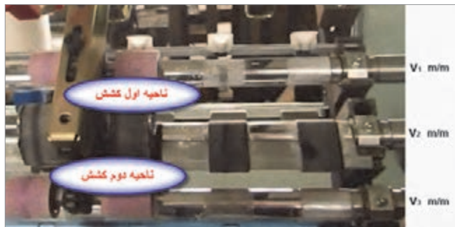
شکل ۲۳- نواحی کشش در رینگ
