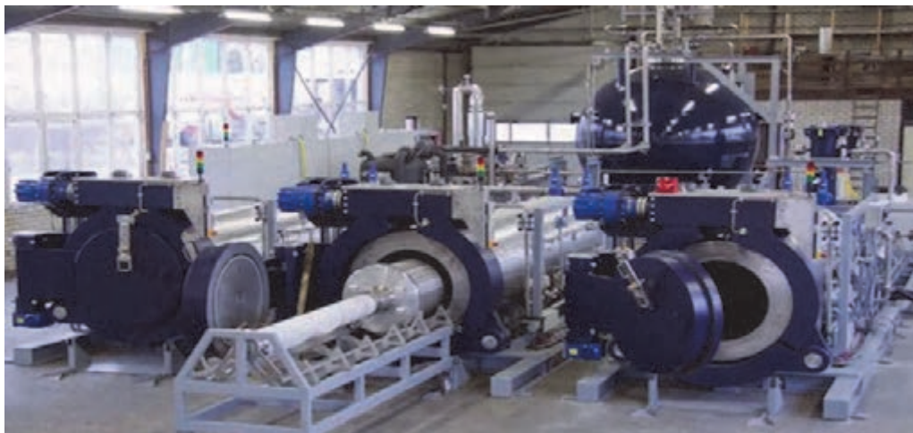
شکل ۲۵- یک نمونه ماشین رنگریزی فوق بحرانی CO_2
