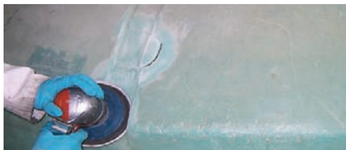
شکل ۲۶- آماده‌سازی سطوح پلاستیکی قبل از جوشکاری
