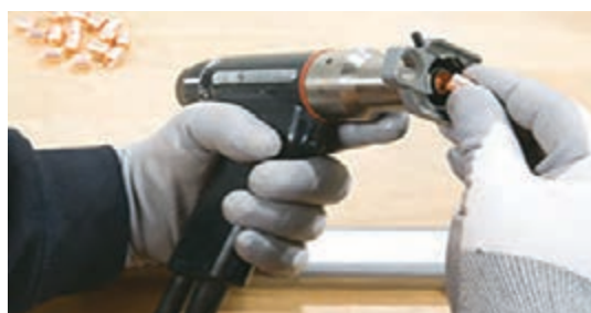
شکل ۲۰- قرار دادن محافظ سرامیکی
