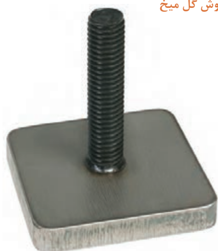
شکل ۲- اتصال ایجاد شده به روش گل میخ
