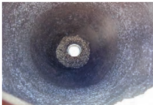
شکل ۲۰- استقرار دیسک ذوب شونده در انتهای بوته
