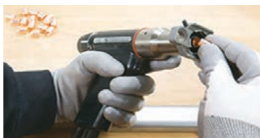
شکل ۱۹- قرار دادن گل میخ در داخل نگهدارنده
