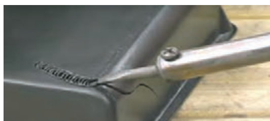
شکل ۲۲- جوشکاری تعمیری قطعات پلاستیکی
