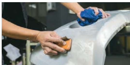
شکل ۳۰- پولیش قطعه کار پس از تعمیر
