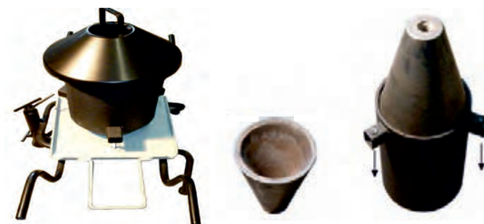
شکل ۶- بوته نگهدارنده مذاب
