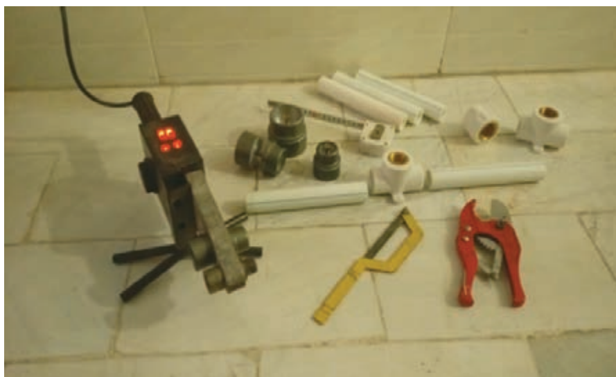
شکل ۱۹- تجهیزات جوشکاری لوله‌های پلاستیکی
