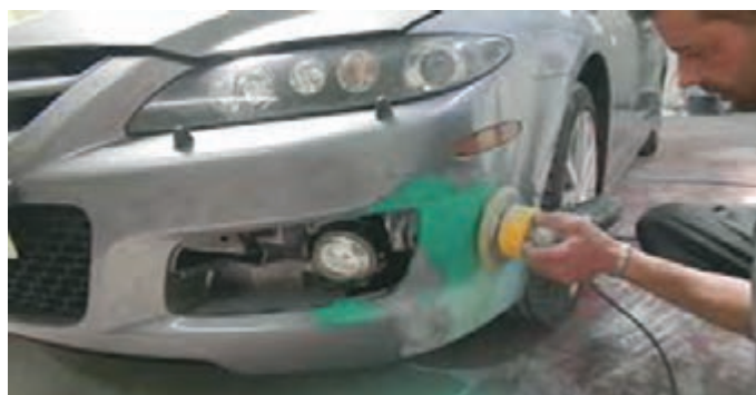
شکل ۲۷- تمیزکاری سپر خودرو
