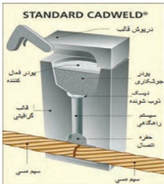
شکل ۲۷- تجهیزات جوشکاری احتراقی
