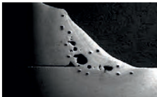
شکل ۳۱- مک و تخلخل در جوشکاری قطعات پلاستیکی
