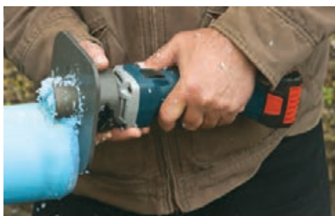
شکل ۲۴- پخ زدن قطعات پلاستیکی برای جوشکاری
