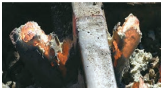
شکل ۲۴- برش گرده اضافی جوش
