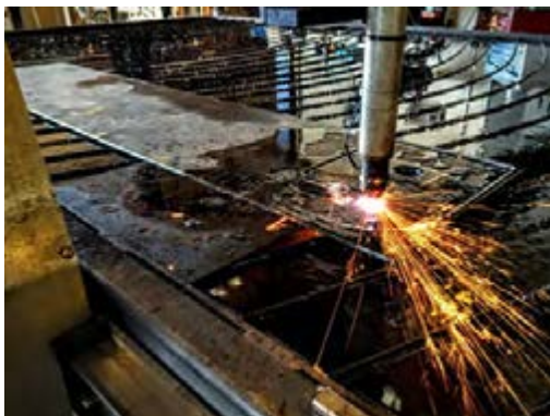
شکل ۲۴: برشکاری پلاسما
