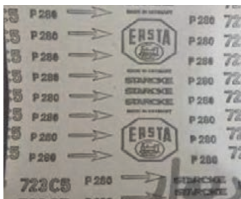
شکل ۵۱- به جهت فلش ورق سنباده توجه کنید.
