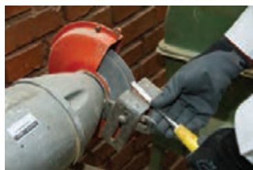
شکل ۳- تیز کردن تیغه رنده به صورت اصولی
