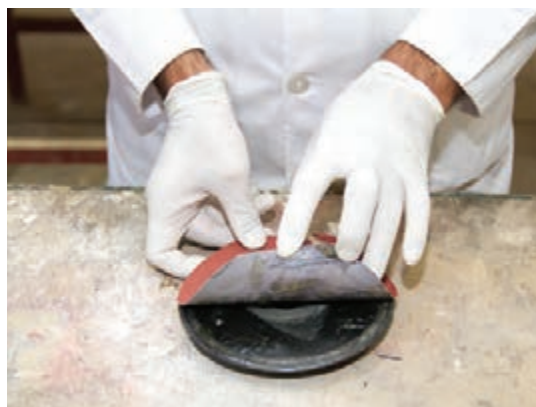
شکل ۱۷۶- چسب‌زدن به کاغذ سنباده
