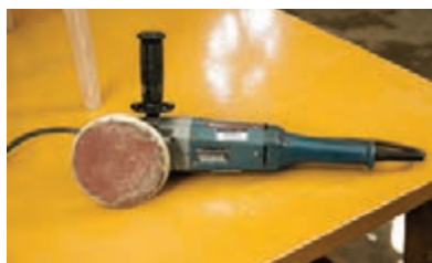
شکل ۱۷۴- اجزای سنباده دیسکی
