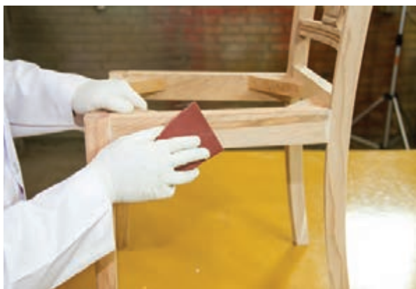
شکل ۱۱- نحوه سنباده کاری دستی
