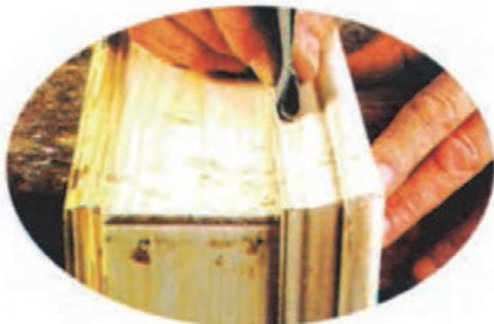
شکل ۱۴- سنباده کاری روی سطوح محدب و مقعر
