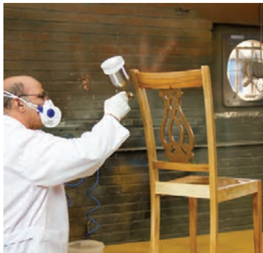
شکل ۴۳- زدن پلی استر با پیستوله
