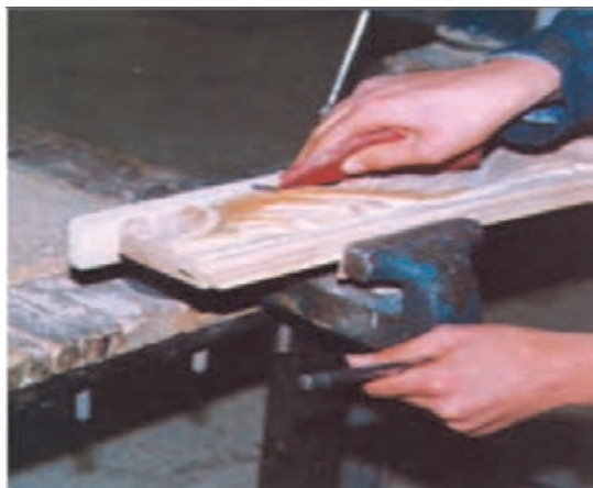
شکل ۱۶- نمدار کردن سطح چوب
