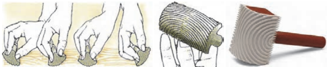
شکل ۱۶۰- روش صحیح استفاده از نقش انداز
