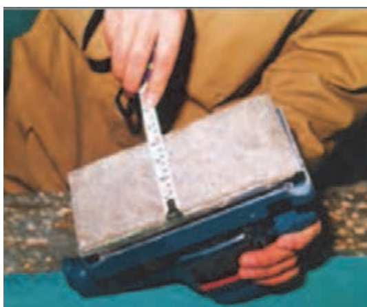
شکل ۴۰- اندازه‌گیری طول صفحه
