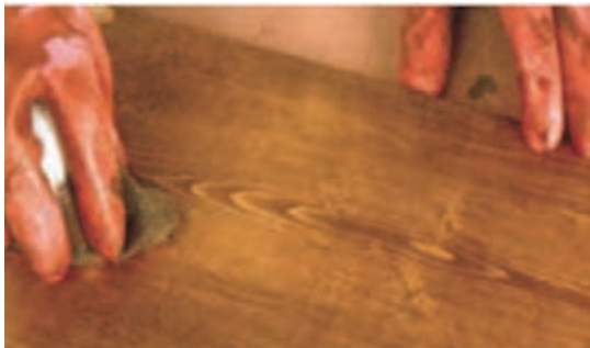
شکل ۱۴۴- زدن آستری هم رنگی با پارچه
