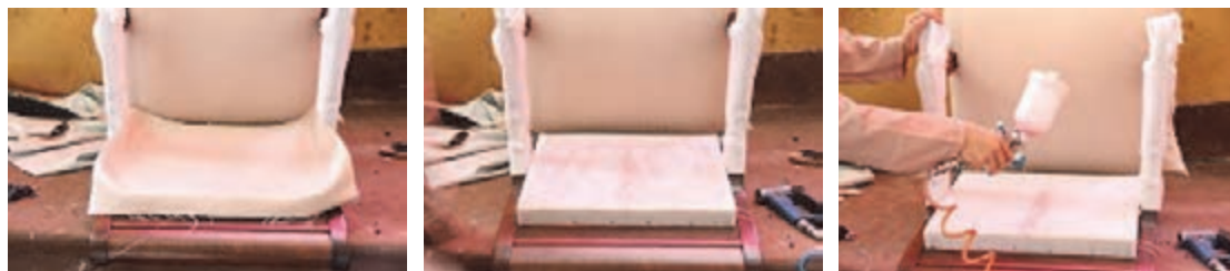
شکل ۳۸- مراحل رویه کوبی پشتی مبلمان
