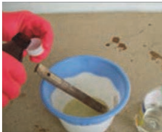
شکل ۴۱- اضافه کردن خشک‌کننده به نیم پلی‌استر رقیق‌شده
