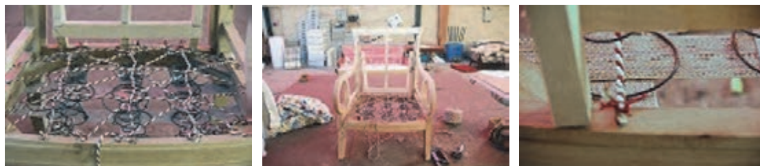
شکل ۳۲- بستن فنر با نخ فنربندی
