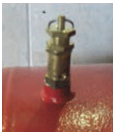
شکل ۱۸۹- سوپاپ کمپرسور برای خروج هوای اضافی
