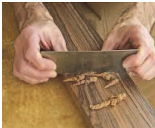
شکل ۵۵- لیسه کشی در جهت الیاف
