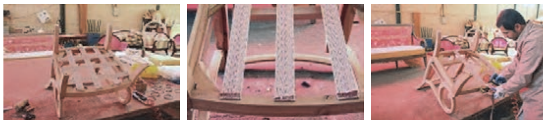
شکل ۳۰- مراحل تسمه کشی
