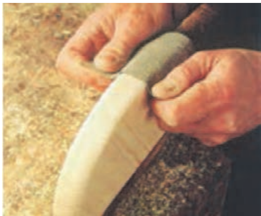
شکل ۱۵- سنباده کاری روی سطوح قوس دار
