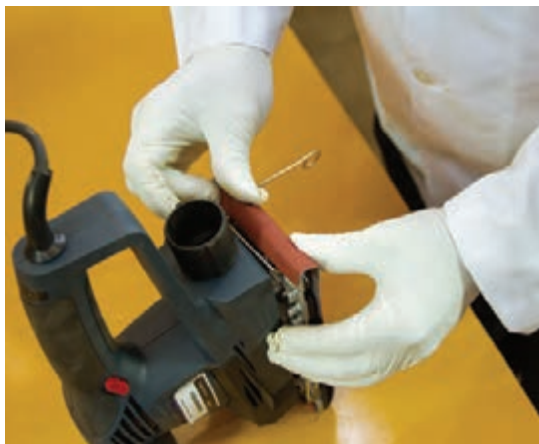
شکل ۴۴- روش جازدن سنباده
