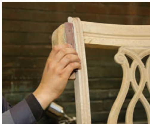
شکل ۹- سنباده کاری به کمک تخته پوست
