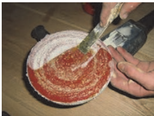
شکل ۱۷۷- چسباندن کاغذ سنباده به سنباده دیسکی
