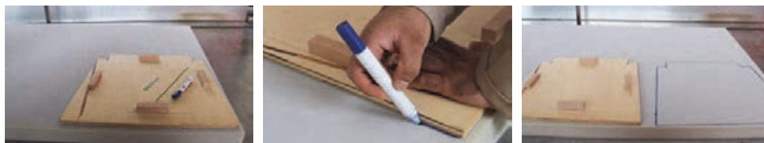
شکل ۳- اندازه‌گیری و خط‌کشی کفی صندلی
