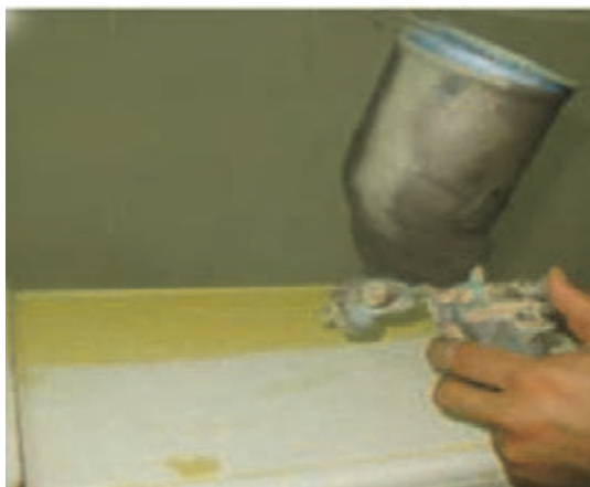
شکل ۲۹- پاشیدن رنگ نیترو سلولزی با پیستوله
