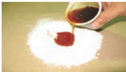
شکل ۸۶- اضافه نمودن رنگ روغنی به بتونه روغنی
