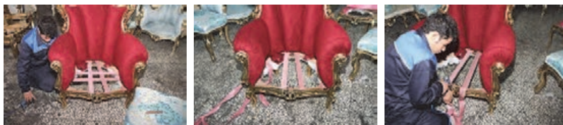
شکل ۲۹- مراحل تسمه کشی
