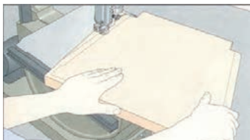
بریدن کفی توسط دستگاه اره نواری
