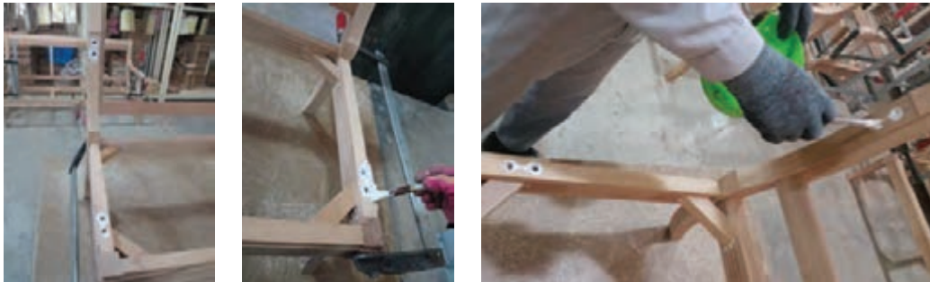
شکل ۵۹- چسب زدن محل اتصالات دسته مبل
