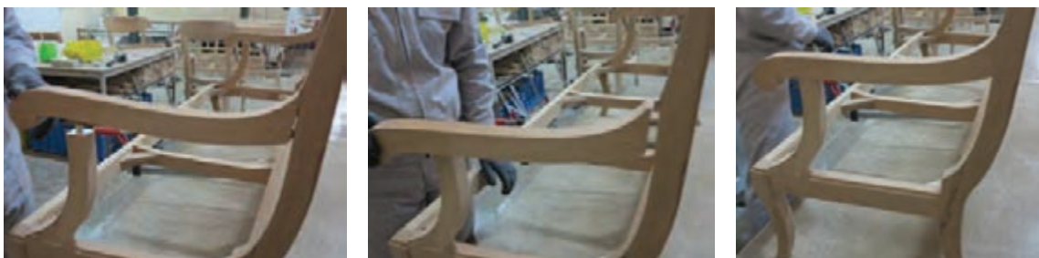
شکل ۶۱- کنترل صحیح بودن دسته مبل
