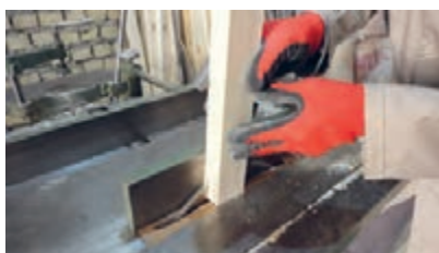
شکل ۹۱- عملیات برش زبانه با دستگاه اره گرد
