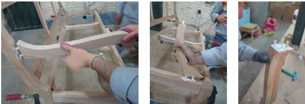
شکل ۶۰- جا زدن دسته مبل در محل اتصالات
