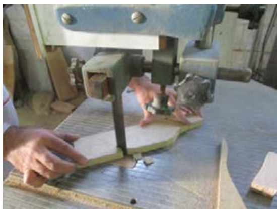
شکل ۶۲- عملیات قوس بری با دستگاه اره نواری
