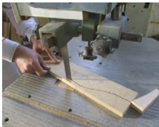
شکل ۶۲- عملیات قوس بری با دستگاه اره نواری
