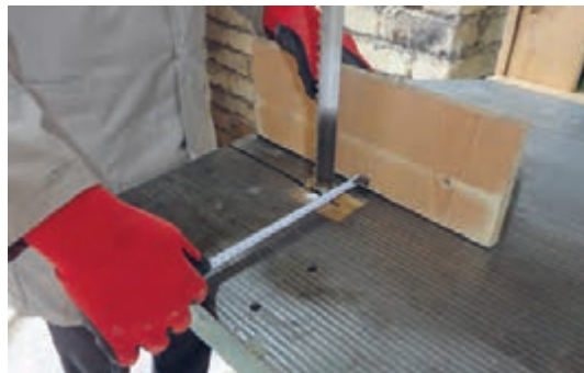
شکل ۷۴- اندازه‌گیری فاصله تیغه با گونیا
