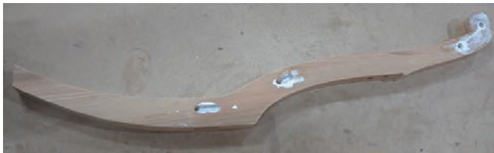
شکل ۴۶- روش چسب زدن اتصال دوبل پایه‌های عقب
