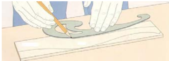
شکل ۴۲- آماده کردن الگوی پایه به وسیله پیستوله
