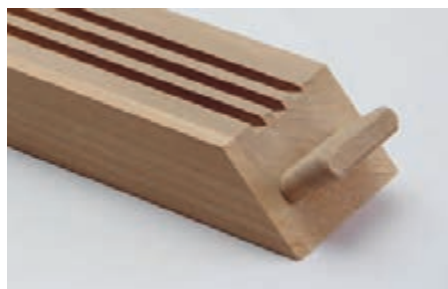
شکل ۹- اتصال زبانه زاویه دار
