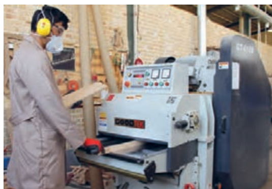
شکل ۷۸- نحوه گندگی کردن چوب‌های کم عرض
