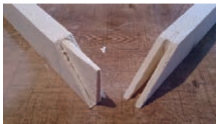
شکل ۲۰- برشکاری اتصال دو رو فارسی
