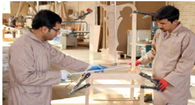
شکل ۱۰۹- کنترل دوئیدگی با متر
