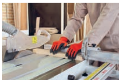
شکل ۷۹- مراحل مختلف یک اندازه کردن قیدها با دستگاه اره مجموعه‌ای
