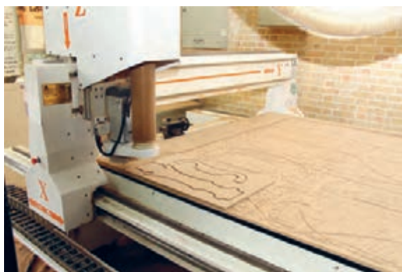
شکل ۶۷- تهیه شابلون با دستگاه فرز CNC
