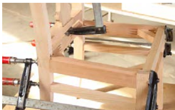
شکل ۱۱۰- نصب نبشی‌ها
