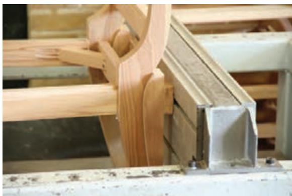
شکل ۵۵- جا زدن اتصالات با تنگ پنوماتیکی
