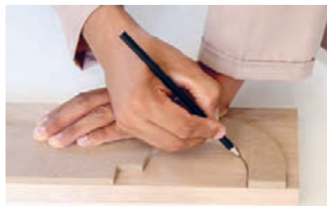
شکل ۸۰- انتقال الگوی تاج و پشتی، از روی شابلون به روی چوب
