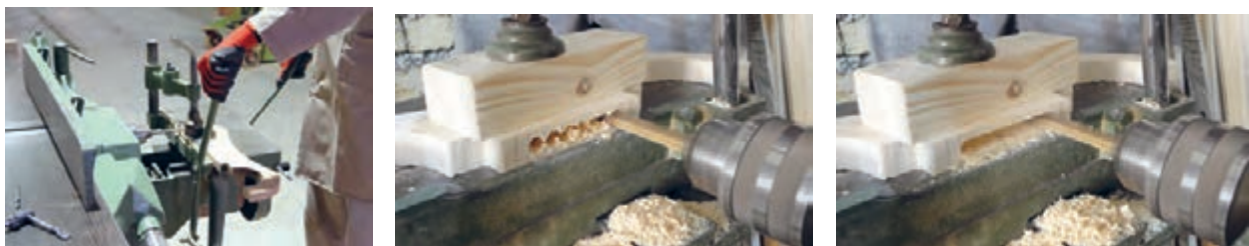
شکل ۸۸- عملیات کم کنی با دستگاه سه کاره
