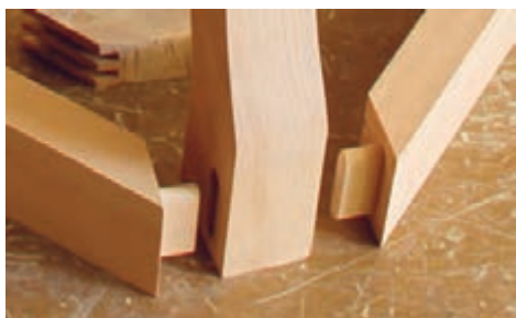
شکل ۱۰- اتصال و زبانه مخفی
