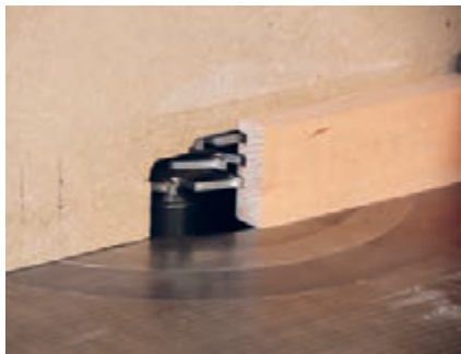
شکل ۶۱- تیغ فرز مخصوص زهوار صفحه
