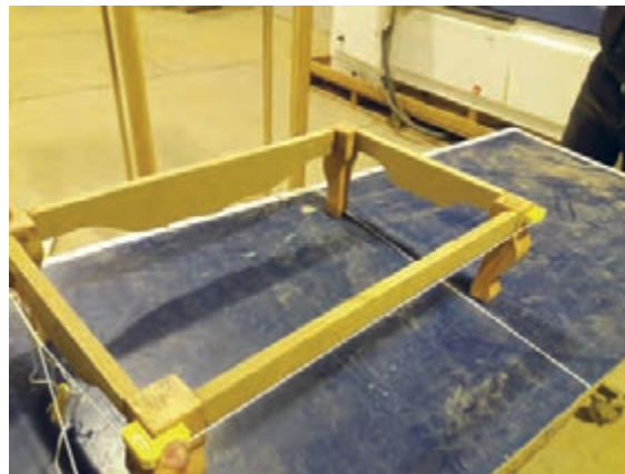
شکل ۷۱- مونتاژ به وسیله گیره کمربندی
