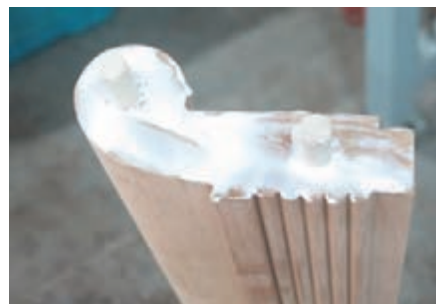
شکل ۴۶- روش چسب زدن اتصال دوبل پایه‌های عقب
