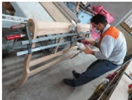
شکل ۵۲- تمیز کردن چسب اضافی روی قطعه کار
