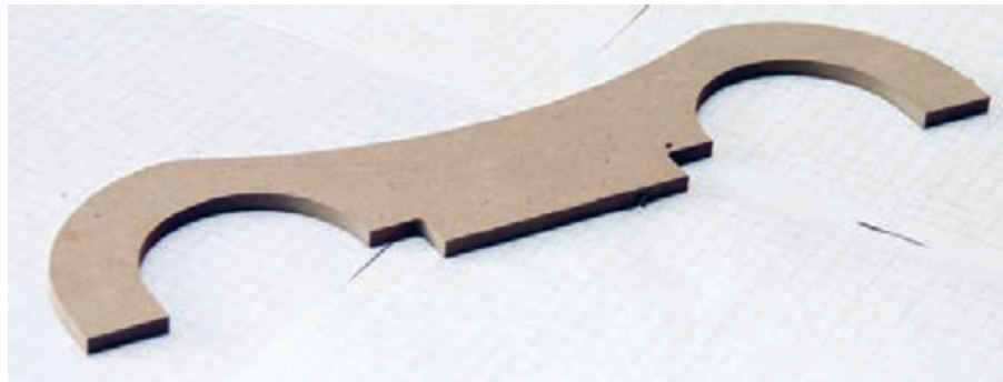
شکل ۶۵- شابلون تاج و پشتی صندلی
