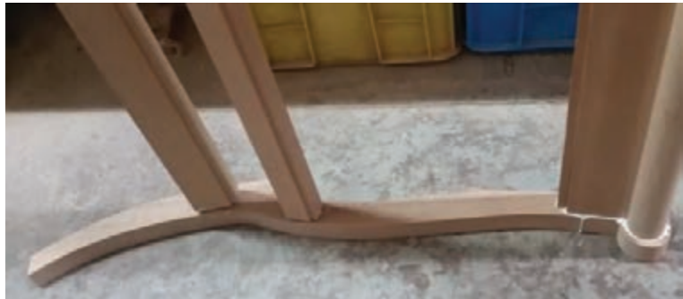
شکل ۴۸- جا زدن پشتی مبل
