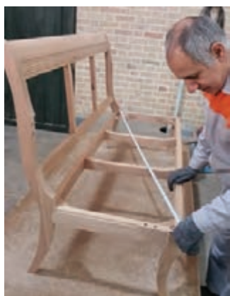
شکل ۵۷- کنترل دوئیدگی (گونیا)ی کردن کار) با متر
