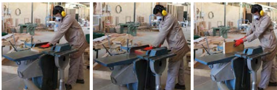
شکل ۷۰- یک رو و یک نرکردن چوب
