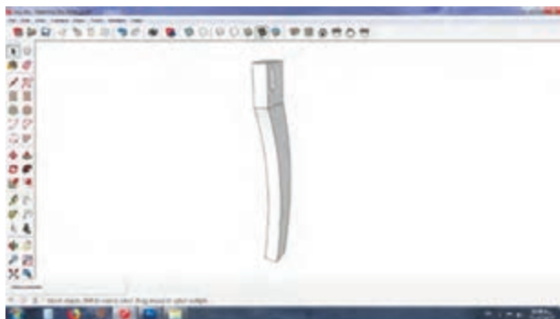
شکل ۲۷- پایه با زاویه ۴۵ درجه
