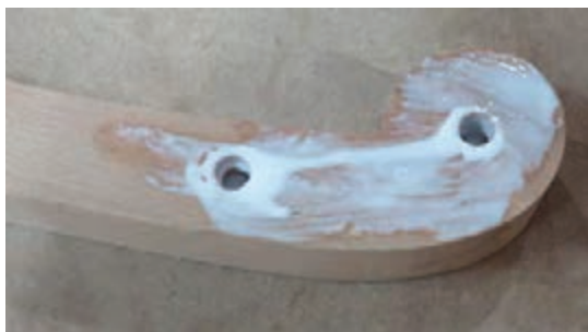
شکل ۴۶- روش چسب زدن اتصال دوبل پایه‌های عقب
