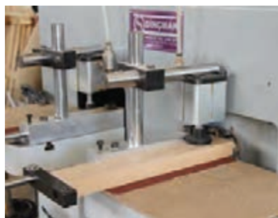
شکل ۴۲- ساخت زبانه با دستگاه زبانه‌زن نیمه اتوماتیک
