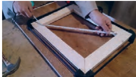
شکل ۲۵- کنترل دوئیدگی و صحیح بودن قاب
