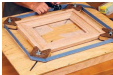
شکل ۷۲- گیره مخصوص بستن قاب
