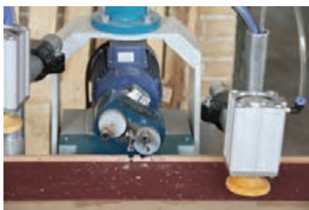
شکل ۳۸- ایجاد اتصال با دستگاه دوبل زن نیمه‌اتوماتیک
