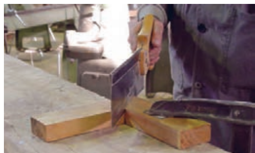
شکل ۲۱- چگونگی اهر کشی درز بین اتصال
