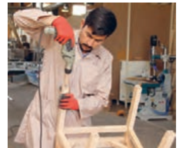
شکل ۱۱۲- سوراخکاری کف پایه با دریل
