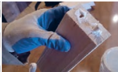
شکل ۳۵- چسب زدن اتصال دوپل
