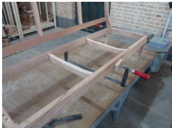
شکل ۵۶- جا زدن اتصالات با گیره دستی
