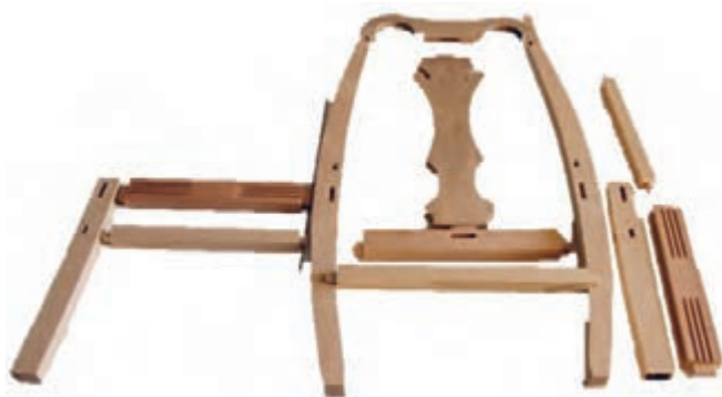
شکل ۹۶- قطعات آماده مونتاژ صندلی
