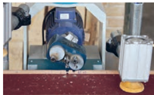
شکل ۵۶- دستگاه دوبل زن
