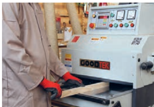
شکل ۷۸- نحوه گندگی کردن چوب‌های کم عرض
