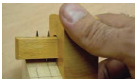
شکل ۱۹- اندازه‌گذاری و خط‌کشی اتصال فاق و زبانه دو رو فارسی
