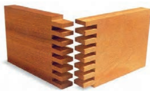
شکل ۱۱- اتصال انگشتی با تعداد زبانه زوج
