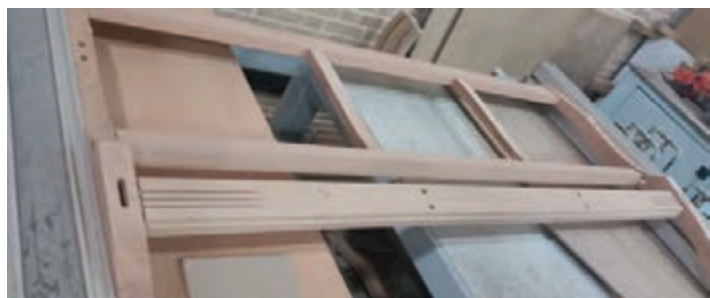
شکل ۵۰- جا زدن پشتی مبل با تنگ پنوماتیک
