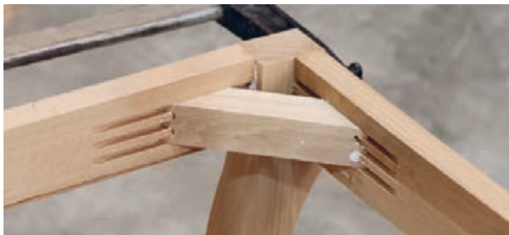
شکل ۱۲- اتصال انگشتی نبشی (بلوک سه‌گوش)
