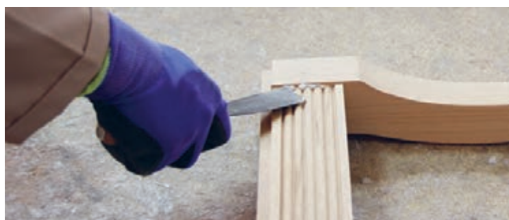
شکل ۱۰۲- تمیز کردن چسب اضافی با کاردک
