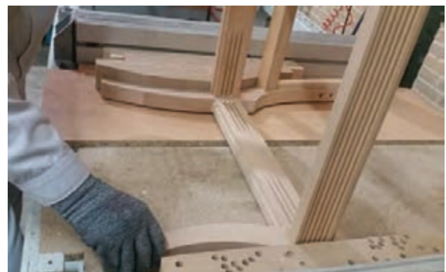
شکل ۵۵- جا زدن اتصالات با تنگ پنوماتیکی
