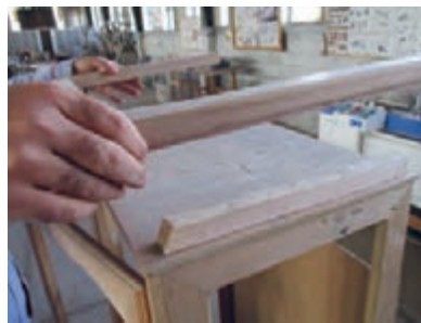
شکل ۸۱- نصب تاج به بدنه
