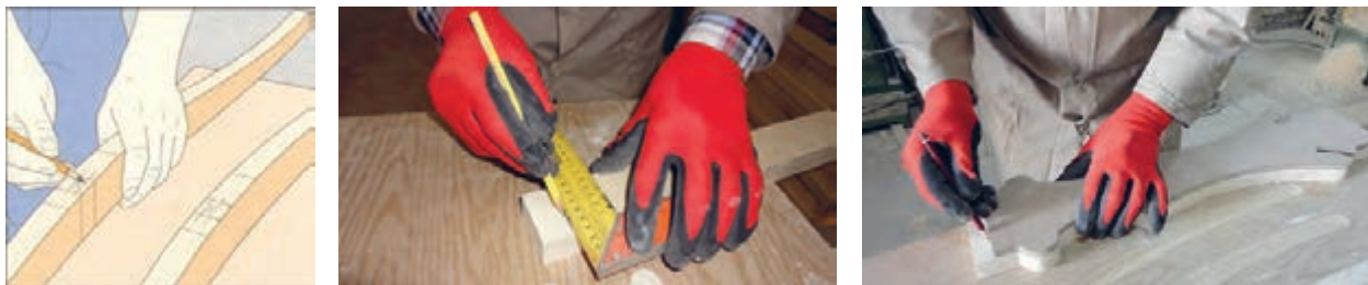
شکل ۸۷- علامت زدن قطعات مختلف برای انجام اتصال
