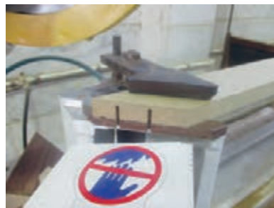
شکل ۶۹- دستگاه دم چلچله زن نیمه اتوماتیک
