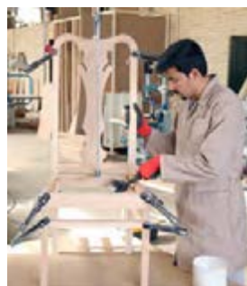
شکل ۱۰۷- جا زدن نبشی به وسیله چکش پلاستیکی
