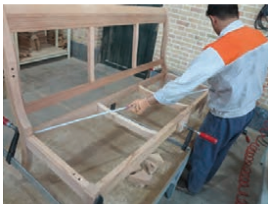
شکل ۵۷- کنترل دوئیدگی (گونیا)ی کردن کار) با متر
