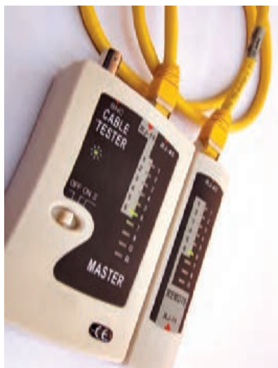
شکل ۲۰- تست کابل شبکه
