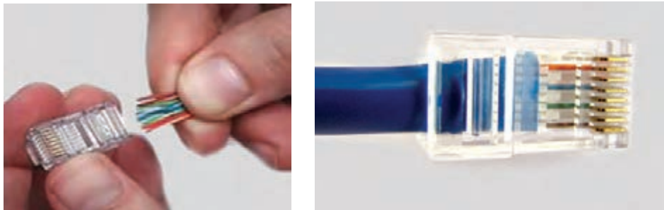
شکل ۲۸- قرار دادن سیم‌ها در سوکت
