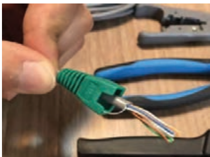
شکل ۲۶- وارد کردن کاور سوکت سر کابل
