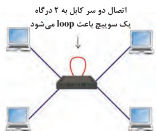
شکل ۵۹- وجود loop در سوییچ
