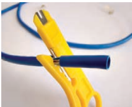
شکل ۲۵- لخت کردن سر کابل
