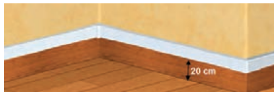
شکل ۵۲ - فاصله داکت یا ترانک از کف
