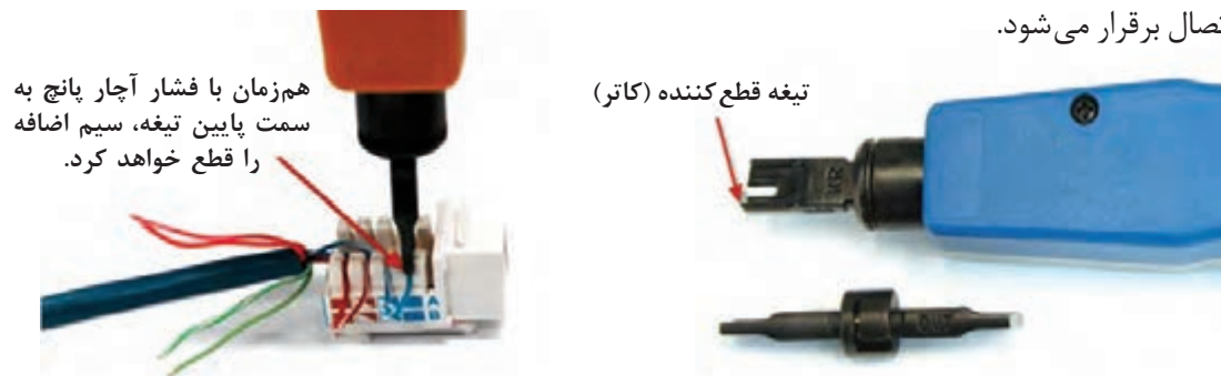
شکل ۳۳- قرار دادن سیم‌ها در کیستون به کمک آچار پانچ
