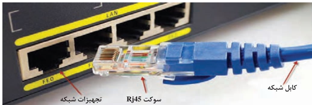
شکل ۶- اتصال سوکت Rj45 به تجهیزات شبکه
