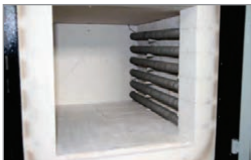
شکل ۱۲- نصب المنت بر روی پایه
