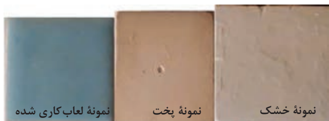
شکل ۱۲- تأثیر انقباض پخت بر ابعاد نمونه
