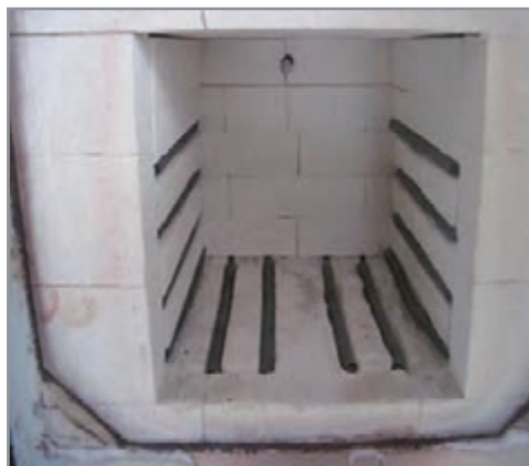
شکل ۱۳- نصب المنت درون شیار
