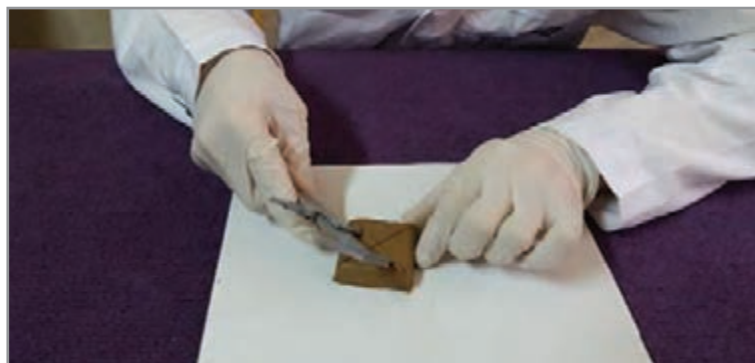
شکل ۸- علامت‌گذاری به وسیله کولیس
