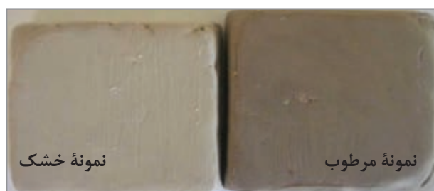
شکل ۲- تأثیر انقباض خشک در کاهش ابعاد نمونه
