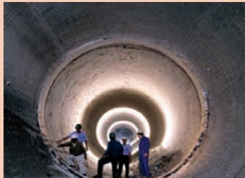
شکل ۲۳- نمای داخلی کوره دوار
