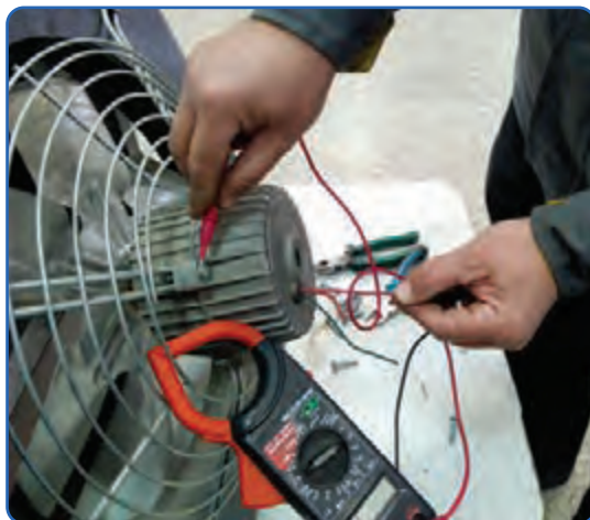
شکل ۲۰- اندازه گیری مقاومت اهمی موتور یونیت هیتر
