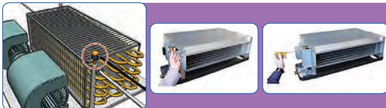
شکل ۲- هواگیری فن کویل
