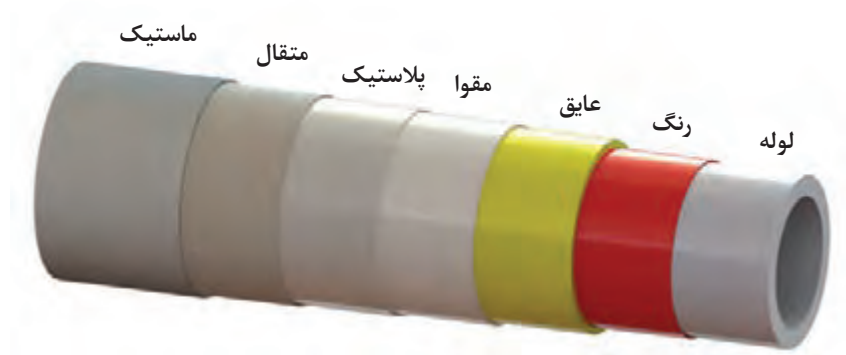
شکل ۱۳- لایه های عایق پشم شیشه
