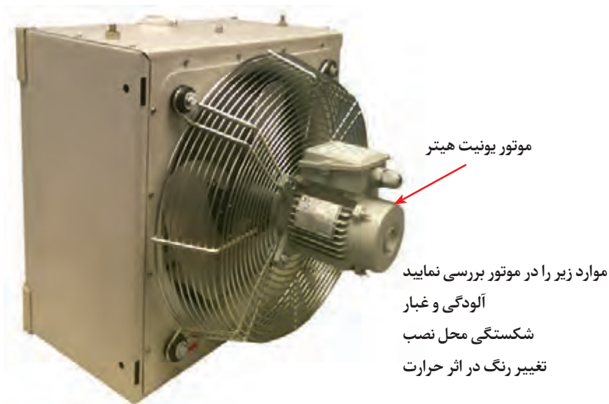
شکل ۱۹- کنترل ظاهری موتور یونیت هیتر
