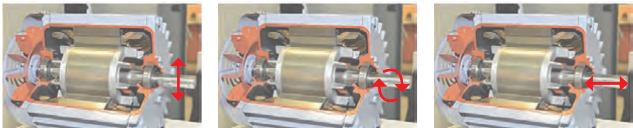
شکل ۱۸- کنترل ظاهری بلبرینگ موتور یونیت هیتر
