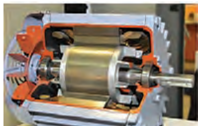
شکل ۱۷. نمایش بلبرینگ و روتور موتور الکتریکی
