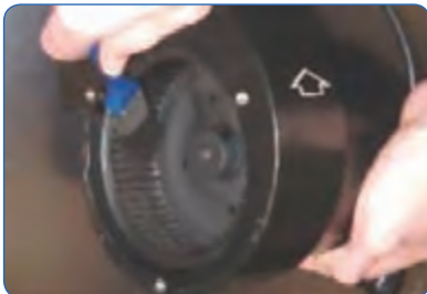
تمیز کردن فن مشعل از گردوغبار
