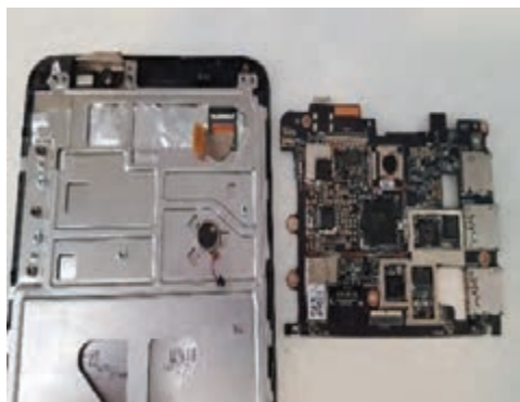
شکل ۵-۳۳- جدا کردن کامل برد از بدنه
