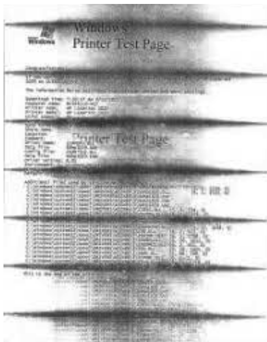
شکل ۱-۳۹- چاپ سیاه به دلیل خرابی کارتریج
