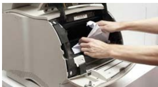
شکل ۳-۳۲- گیر کردن کاغذ
