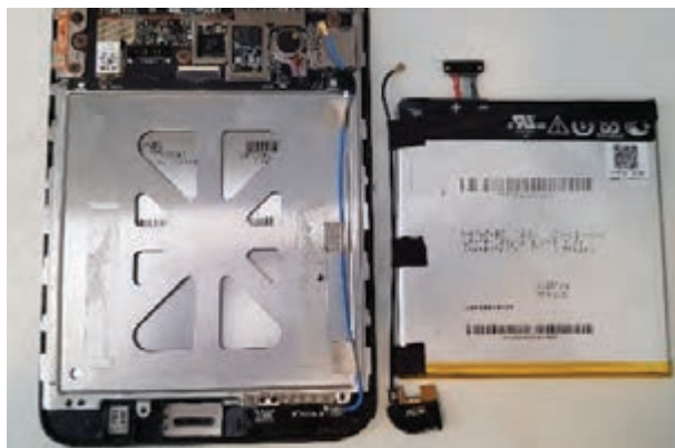
شکل ۵-۳۰ جدا کردن باتری از بدنه اصلی
