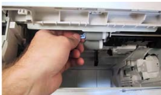
شکل ۳-۲۲ تعویض Separation Roller
