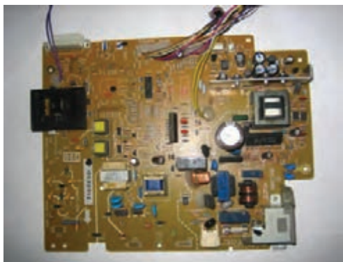
شکل ۲-۲۳ برد «های ولتاژ»
