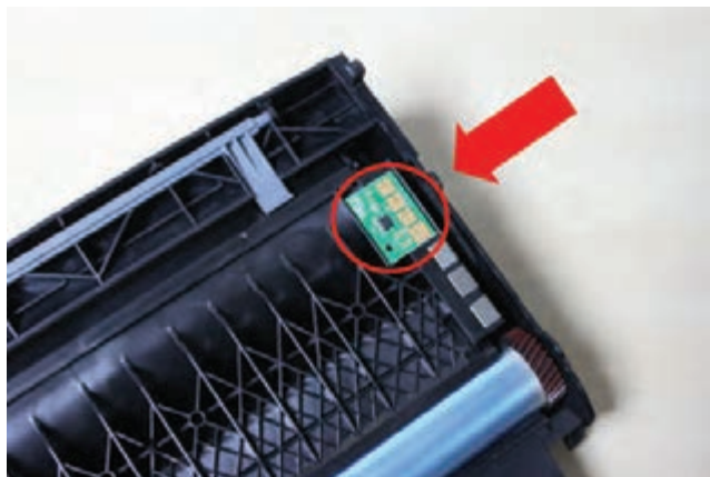
شکل ۴۶-۳- کارتریج مجهز به برد چیپ ست
