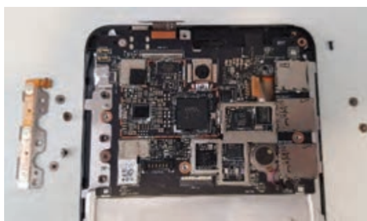
شکل ۵-۳۱ باز کردن پیچ‌های اتصال دهنده برد به بدنه
