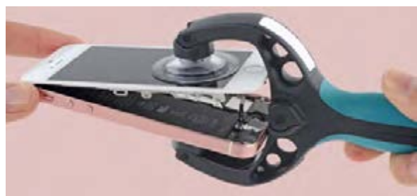
شکل ۵-۳۵- جدا کردن صفحه لمسی با ابزار وکیوم
