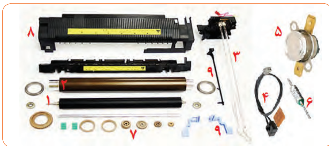
شکل ۲-۳۴ اجزای تشکیل دهنده فیوزینگ یونیت
