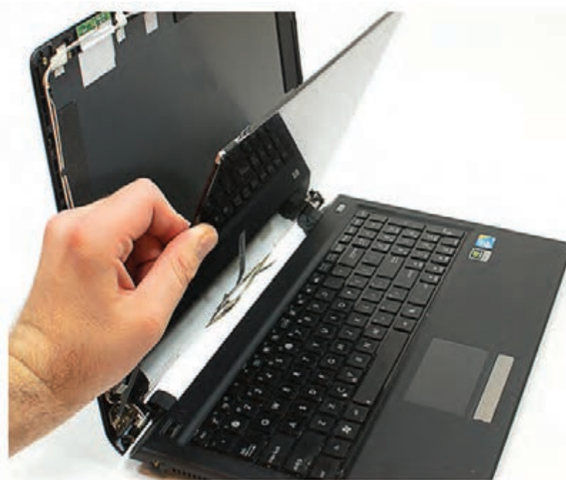
شکل ۵-۲۲- باز کردن نمایشگر لپ تاپ
