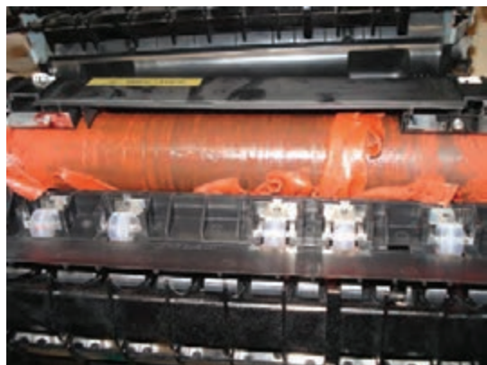
شکل ۳-۳۶- غلتک پرس معیوب
