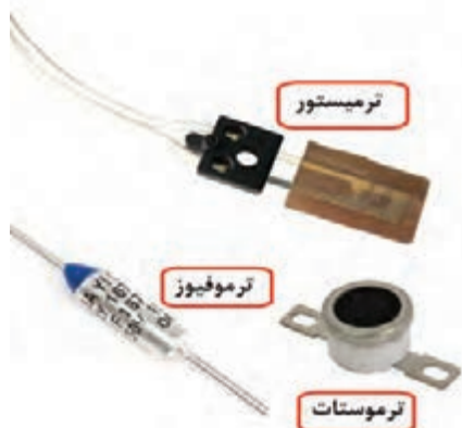
شکل ۲-۳۸ - قطعات حرارتی واحد فیوزینگ
