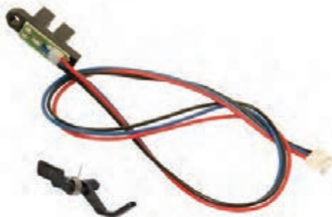
شکل ۳-۲۳- یک نمونه سنسور کاغذ
