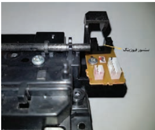
شکل ۳-۳۵- سنسور خروجی فیوزینگ یونیت
