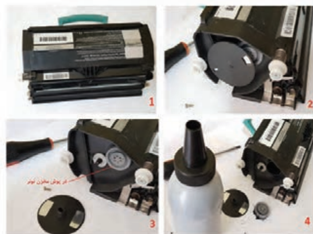
شکل ۳-۴۸- مراحل شارژ یک نمونه کارتریج لیزری
