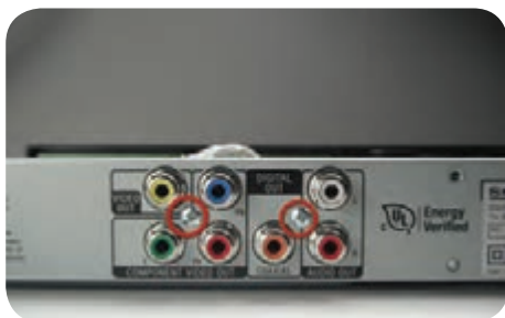
شکل ۶-۲۲ باز کردن پیچ‌های برد پردازشگر
