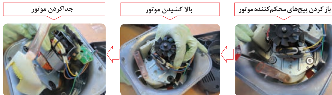
شکل ۲۶-۱- اینفوگرافی جدا کردن موتور
