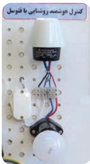
شکل ۲-۱۹- نحوه سیم‌کشی فتوسل
