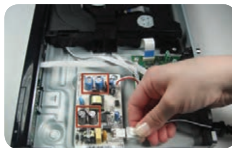
شکل ۶-۲۳ آزادکردن سوکت منبع تغذیه
