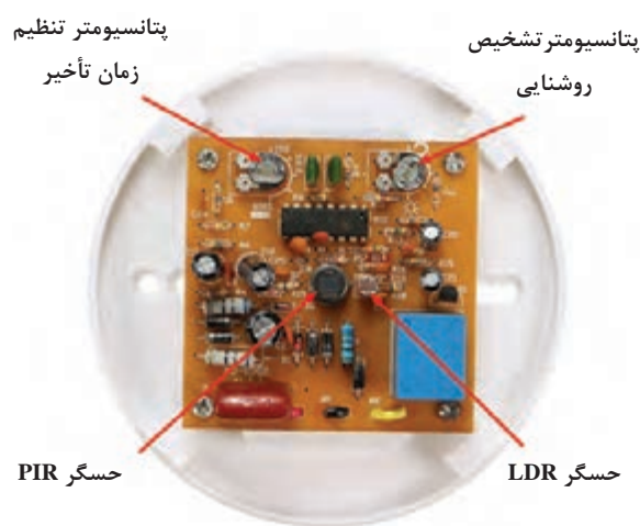
شکل ۲-۲۷- مدار داخلی یک نمونه حسگر سقفی
