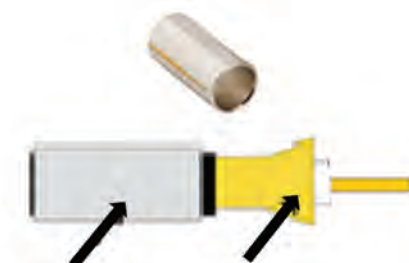
شکل ۳-۲۲- قراردادن حلقه روی کابل
