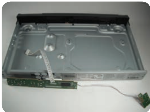
شکل ۶-۳۷ دمونتاژ پنل‌ها
