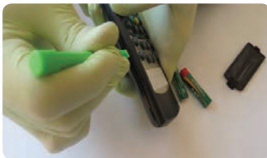
شکل ۱-۸ آزاد کردن خارهای قاب دستگاه ریموت کنترل
