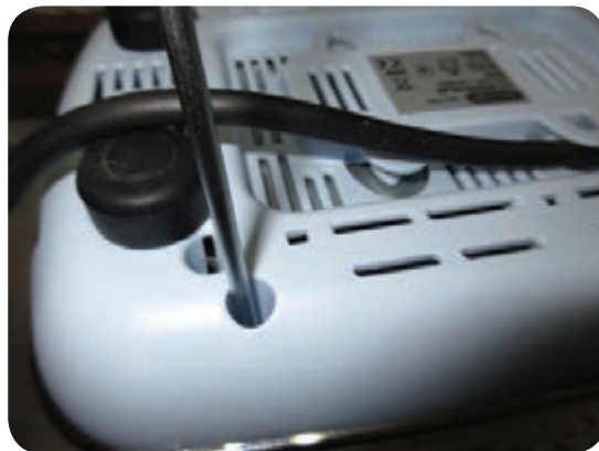
شکل ۶-۴۲ تشخیص نوع و محل پیچ‌های باز شده
