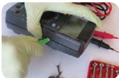
شکل ۱۵-۱ جدا کردن دو قسمت بدنه
