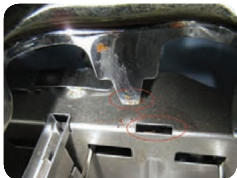
شکل ۵۸-۶ خار نر و ماده جهت اتصال
