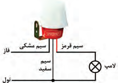
شکل ۲-۱۸- اتصال فتوسل به لامپ و شبکه
