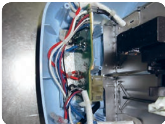
شکل ۶-۴۹ محل قرار گرفتن حسگر حرارتی
