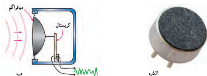
شکل ۱۶-۵- میکروفون کریستالی و ساختمان داخلی آن
