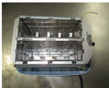
شکل ۶-۵۴ سیم اتصال زمین جدا شده از فیش
