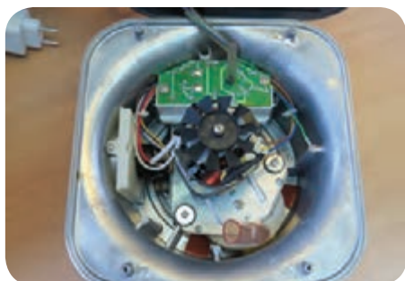
شکل ۲۴-۱. موتور، برد الکترونیکی و پروانه
