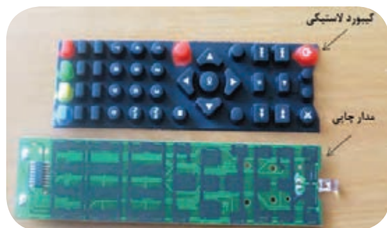
شکل ۱-۴ صفحه کلید و برد دستگاه ریموت کنترل
