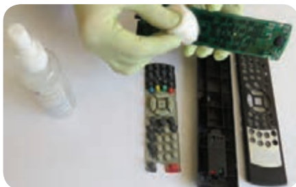
شکل ۱-۱۰ تمیز کردن کنتاکت‌ها با الکل
