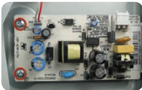
شکل ۶-۲۴ محل پیچ‌های محکم‌کننده برد منبع تغذیه
