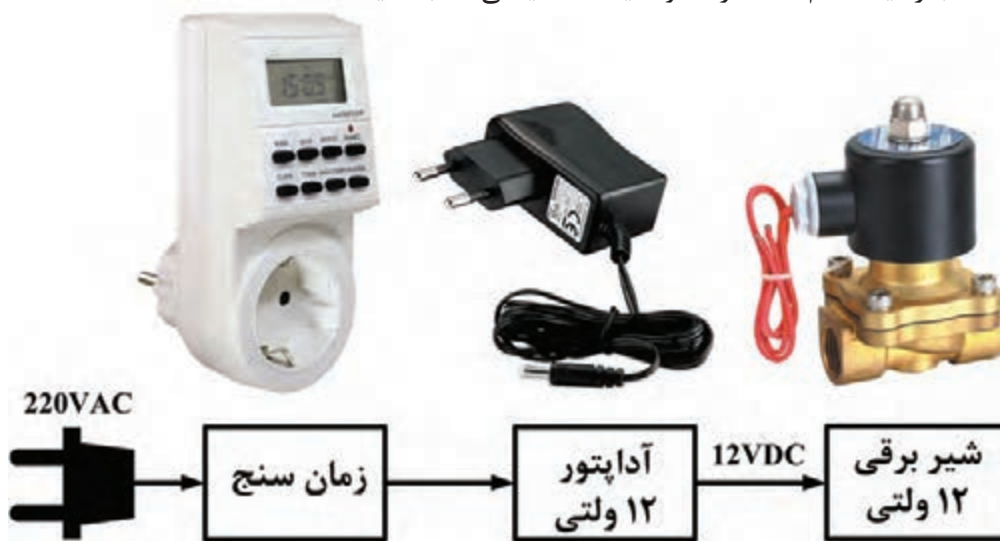
شکل ۲-۴۸- نصب شیر برقی ۱۲ ولت
