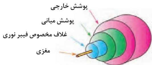
شکل ۴-۸- فیبر نوری و اجزای آن
