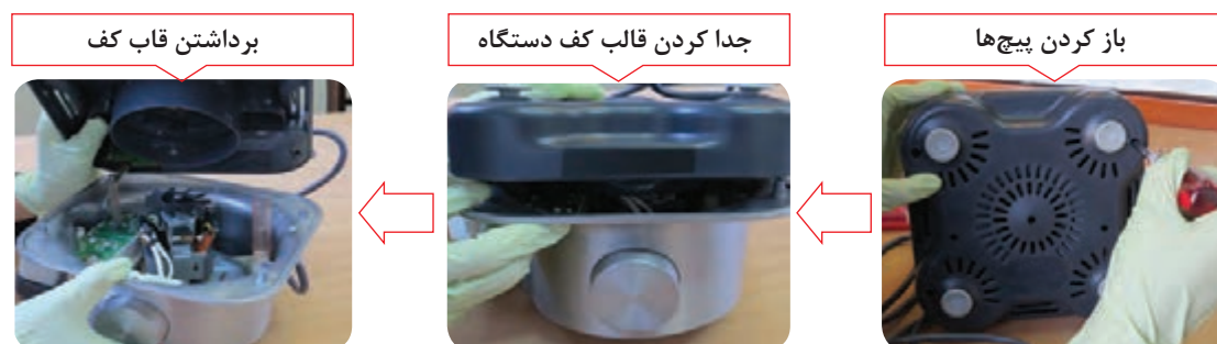
شکل ۲۲-۱. اینفوگرافی باز کردن کف دستگاه
