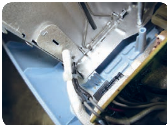
شکل ۶-۴۹ محل قرار گرفتن حسگر حرارتی
