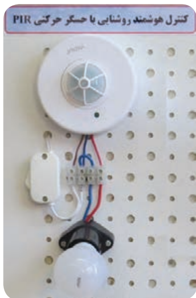
شکل ۲۹-۲ نحوه سیم‌کشی حسگر حرکتی PIR
