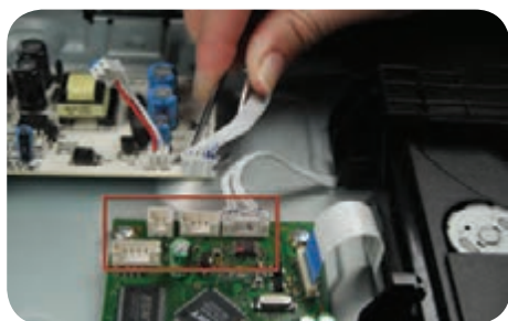
شکل ۶-۲۰ جدا شدن تمامی سوکت‌ها از برد
