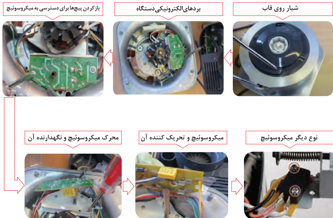
شکل ۲۵-۱- اینفوگرافی جدا کردن میکروسوییچ
