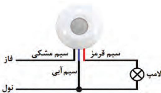
شکل ۲۸-۲ اتصال حسگر حرکتی به شبکه و لامپ
