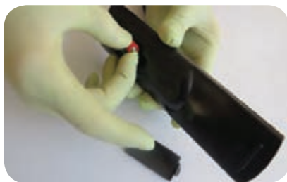
شکل ۷-۱- خارج کردن باتری
