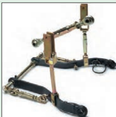
شکل ۶- میله‌ها و مفصل‌های اتصال سه نقطه تراکتور
