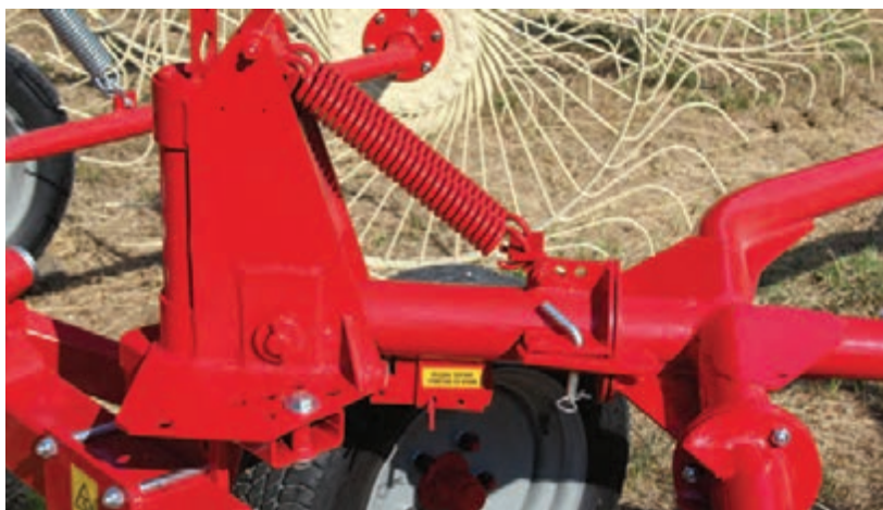
شکل ۱۵- مکانیزم شناوری شانه خورشیدی
