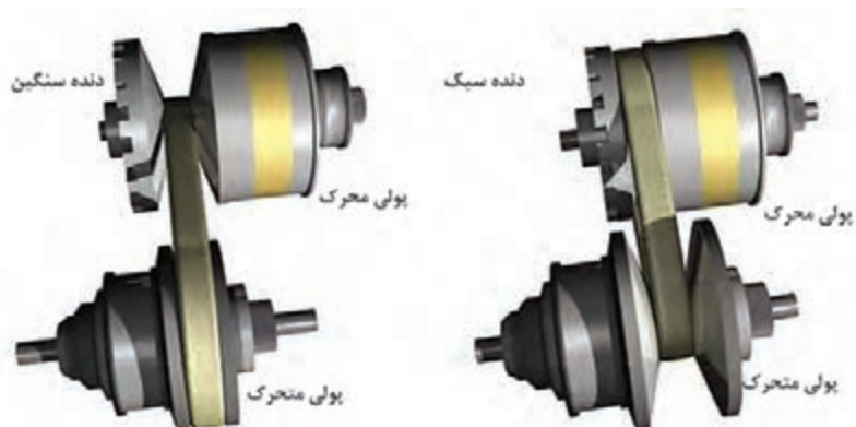
شکل ۶۲- نحوه عملکرد پولی‌های با قطر متغیر
