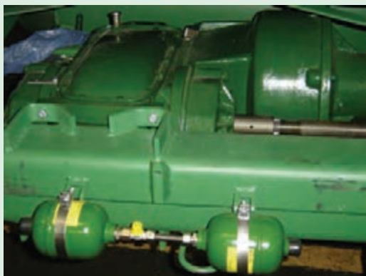
شکل ۳۷- آکومولاتور سیستم تعلیق هد کمباین جاندر ۱۰۵۵
