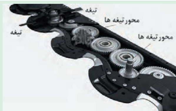
شکل ۵۱ - چرخ دنده‌های محرک تیغه‌ها در دروگر بشقابی
