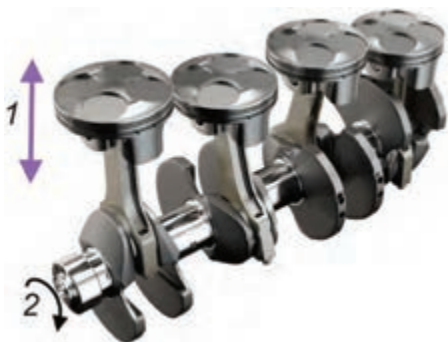
شکل ۱۹- کاربرد مکانیزم لنگ و لغزنده در موتور
