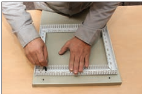
شکل ۴۱- داکت کشی روی صفحه نصب
