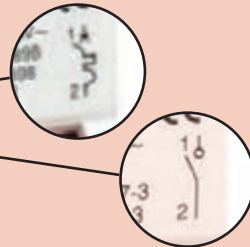
شکل ۳- دو نمونه کلید خودکار مینیاتوری متفاوت
