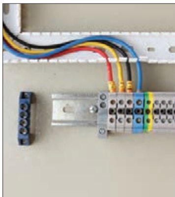
شکل ۵۲- سیم‌کشی روی صفحه نصب
