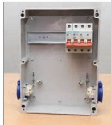
شکل ۲۲- نصب کلید جریان باقیمانده (نشتی)
