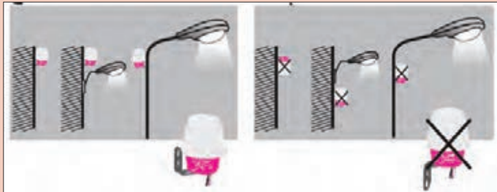
شکل ۹۸- نحوه نصب فتوسل
