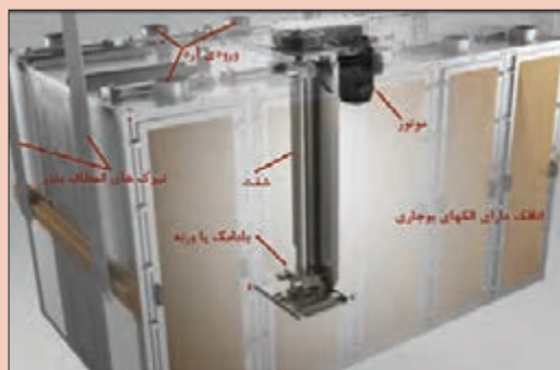
شکل ۳۴- موتور ۷۵ کیلووات با جریان نامی ۱۷۰ آمپر
