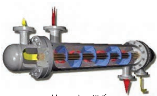
شکل ۱۷- مبدل پوسته و لوله
