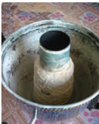
شکل ۸- تشکیل رسوب در سماور و لوله‌ها
