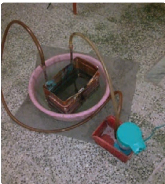
شکل ۱۹- رسوب‌زدایی با پمپ
