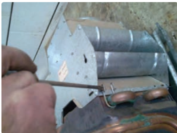
شکل ۶- جدا کردن کلاهک تعدیل از مبدل
