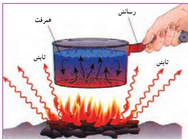
شکل ۱۱- انتقال گرما به هر سه روش
