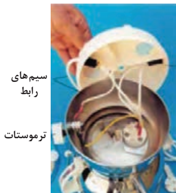
شکل ۱۷-۴ - اجزای داخلی سماور برقی
