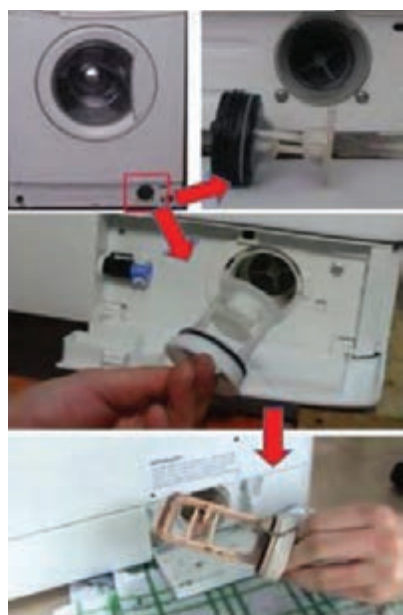
شکل ۳-۴ نحوه تمیز کردن فیلتر لباسشویی
