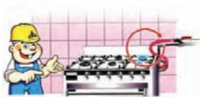
شکل ۸-۷-لوله پلاستیکی حامل گاز نباید از یک متر و نیم بیشتر باشد.
