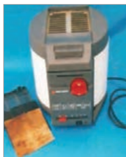
شکل ۴-۲۶- تعویض فیلتر سرخ کن
