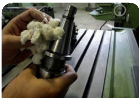
تمیز کردن دنباله میله فرزگیر
