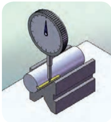
کنترل شیار از نظر طولی
