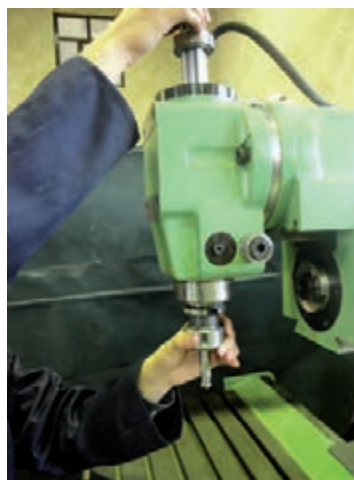
نحوه بستن کُلت بر روی دستگاه
