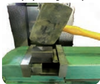
اطمینان از چسبیدن قطعه به سطح لوک زیرین
