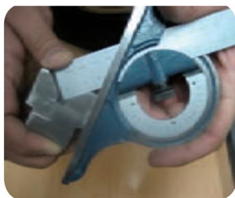
کنترل شیب قطعه با زاویه سنج انیورسال
