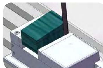
کنترل دو سر خط کشیده شده بر روی قطعه با خط‌کش
