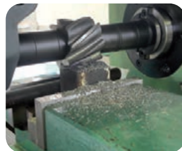
کف تراشی با تیغه فرز غلطکی با استفاده از ماشین فرز افقی
