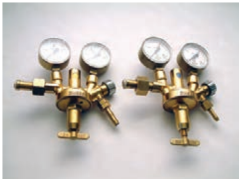
شکل ۲-۴۵- رگولاتور اکسیژن و استیلن
