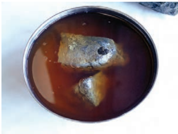
شکل ۱۲-۲- نگهداری کربید در زیر نفت
