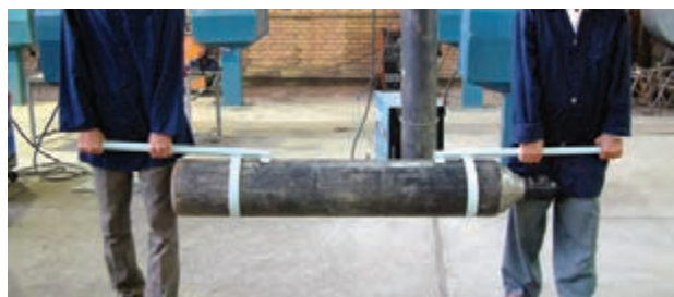
شکل ۸۶-۲ روش درست جابه‌جا کردن کپسول
