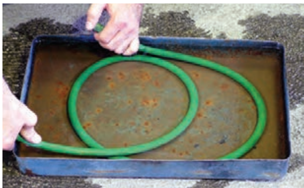
شکل ۲-۹۹ – کنترل نشتی شیلنگ در آب
