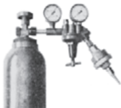
شکل ۲-۴۴- شیر یک طرفه بعد از رگولاتور
