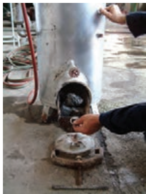
شکل ۲-۳۴- قرار دادن کاربید در محفظه‌ی مخصوص
