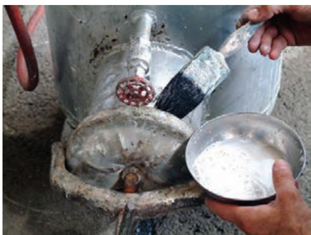
شکل ۲-۳۹- کنترل نشتی گاز
