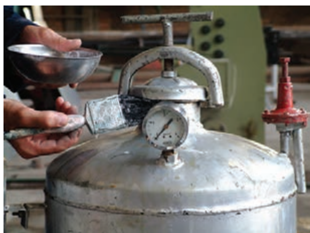
شکل ۲-۳۸- کنترل نشتی گاز
