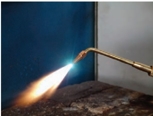
شکل ۲-۳- شعله‌ی سوختن گاز استیلن با اکسیژن
