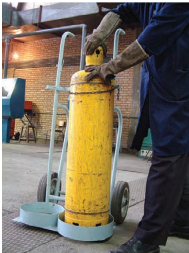
شکل ۲-۱۹- کپسول استیلن و کلاهک آن
