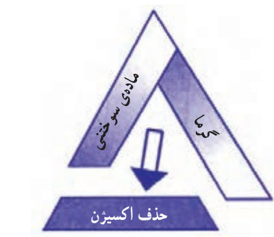
شکل ۱۶-۱- ممانعت از رسیدن اکسیژن به ماده سوختنی
