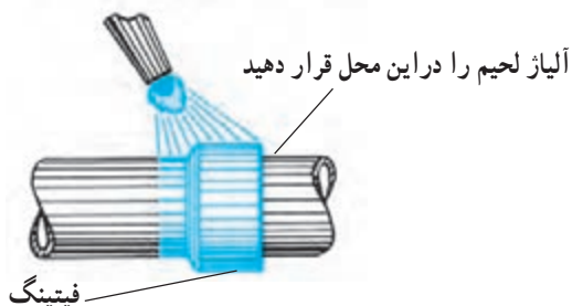
شکل ۴-۱۹- ترتیب گرم کردن لوله و فیتینگ
