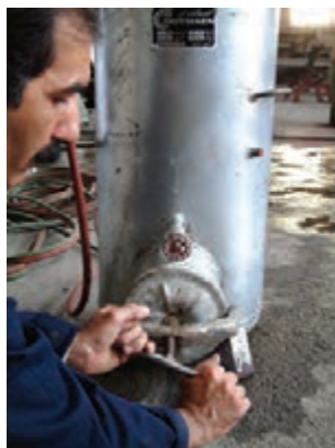
شکل ۲-۳۶- بستن دریچه‌ی محفظه‌ی کاربید
