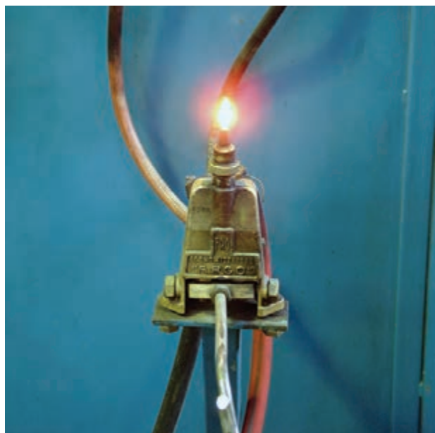
شکل ۲-۶۸- شمعک روی میز جوشکاری گاز
