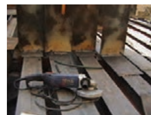
شکل ۲۹-۱ الف پروفیل‌های به هم چسبیده
