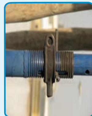
شکل ۳-۲۳- سوراخ‌های روی شمع فلزی جهت تعیین ارتفاع مناسب
