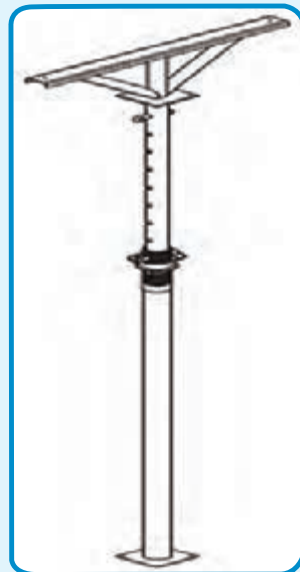
شکل ۳-۲۲- شمع فلزی کامل تنظیم ارتفاع
