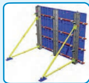
شکل ۳-۱۲- اجزاء قالب‌بندی
