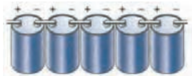
شکل ۲-۱۲۰ اتصال سری پیل‌ها
