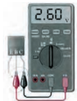
شکل ۴۹-۱۲ ترانزیستور معیوب (قطع)
