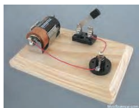
شکل ۱-۳۰ یک مدار الکتریکی ساده
