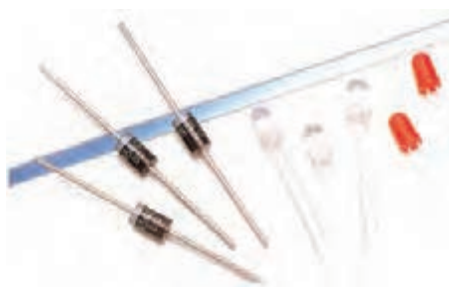
شکل ۱۰-۲۰ نمونه هایی از انواع دیودها
