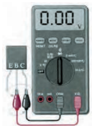
شکل ۵۰-۱۲ ترانزیستور معیوب (اتصال کوتاه)
