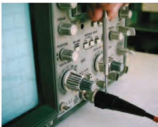
شکل ۸-۶ نحوه‌ی تنظیم پروب
