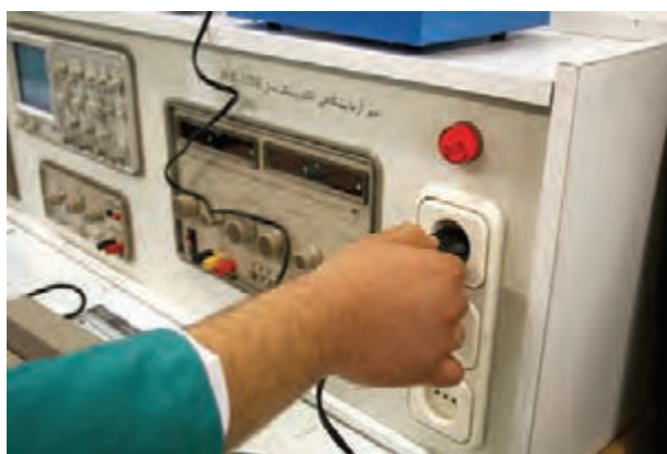
شکل ۱-۳۸ اتصال صحیح دو شاخه
