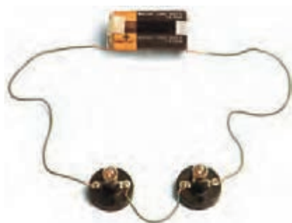
شکل ۲-۲۹ مدار واقعی دو لامپ به صورت سری
