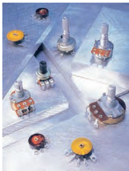
شکل ۲-۴ چند نمونه پتانسیومتر پر کاربرد در الکترونیک
