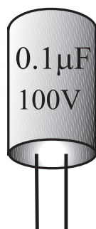
شکل ۷-۲۵ مشخصات روی خازن
