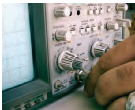
شکل ۶-۶ نحوه‌ی اتصال BNC به اسیلوسکوپ
