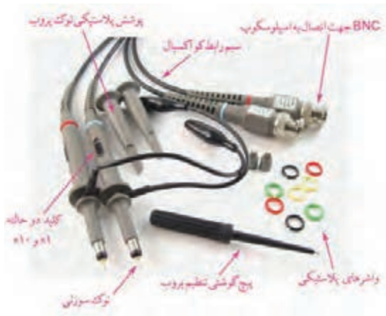
شکل ۵-۶ پروب و اجزای آن
