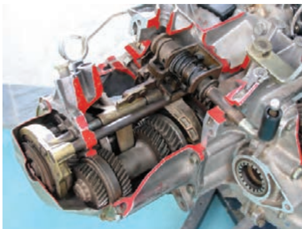
شکل ۱۶۲- جعبه دنده خودروی محرک جلو
