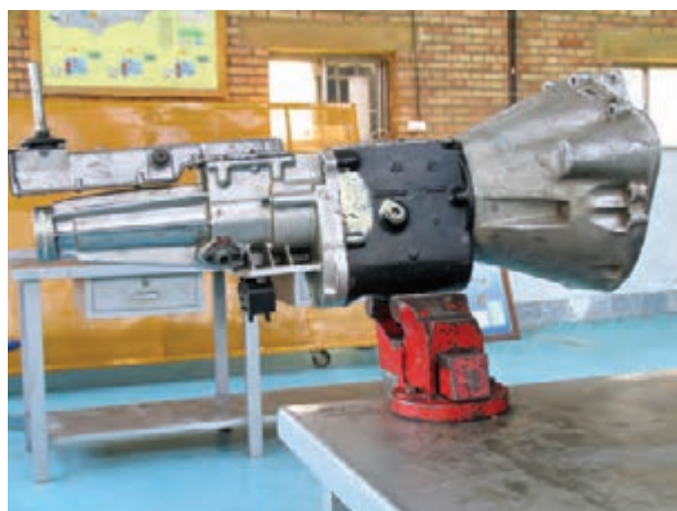
شکل ۱۶۳- جعبه دنده خودروی محرک عقب
