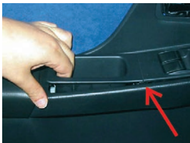
شکل ۱۸۳-۲ خارج نمودن قاب سوئیچ‌ها
