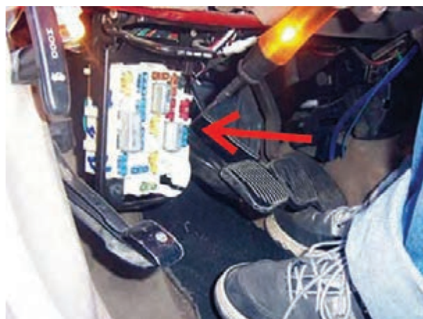
شکل ۱۸۹-۲- آزمایش پایه‌های فیوز
