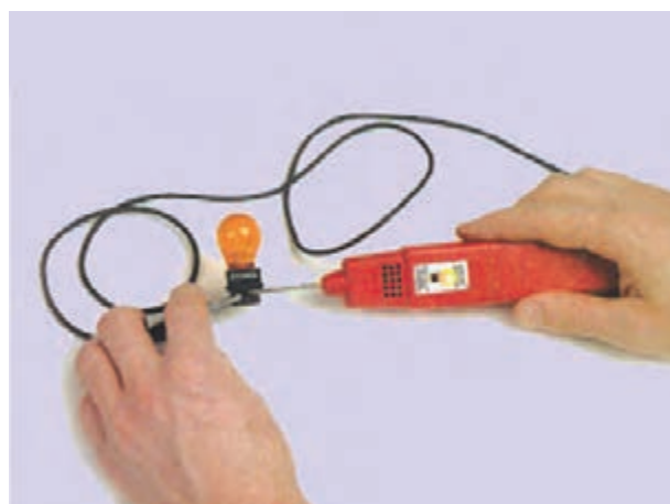
شکل ۱۸۲-۱- آزمایش لامپ چراغ راهنما
