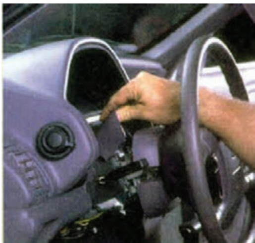
شکل ۹۱-۱- بیرون آوردن قاب سوئیچ روشنایی
