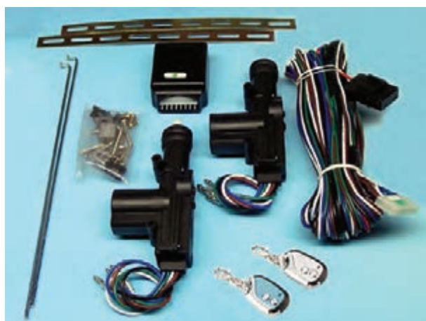
شکل ۱-۲- اجزای مدار قفل مرکزی
