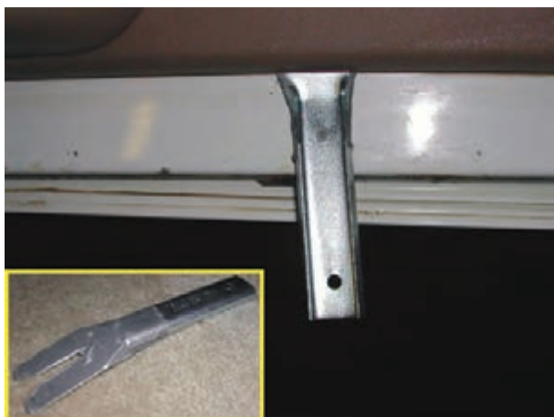
شکل ۲-۳۵- اهرم خاردرآر و نحوه‌ی استفاده از آن
