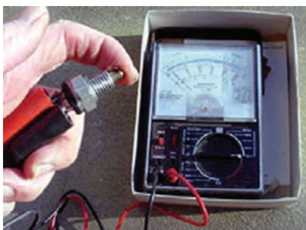
شکل ۱۰۵-۱- آزمایش سوئیچ چراغ‌های دنده عقب
