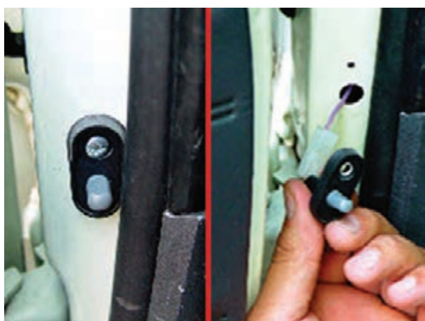
شکل ۱۹۲-۱- باز کردن سوئیچ لای در
