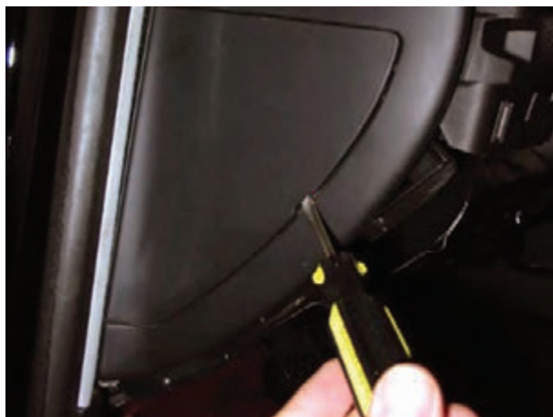
شکل ۱۱۸-۱ آزاد کردن خار پوشش محفظه‌ی جعبه‌ی فیوز
