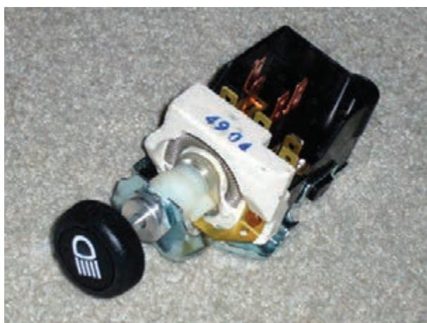
شکل ۱-۷۱- سوئیچ چراغ‌های روشنایی نوع چرخشی
