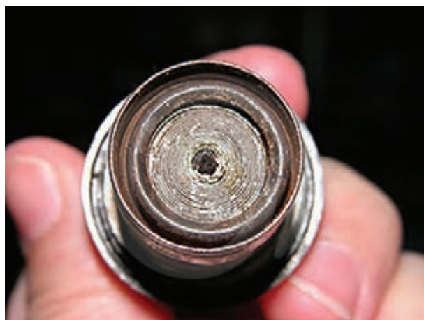
شکل ۱-۲۲۵- المنت حرارتی داخل سوئیچ فشاری
