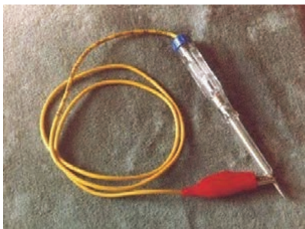
شکل ۱-۱۲۱- چراغ آزمایش بدون باتری
