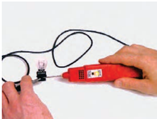
شکل ۲۱۹-۱- آزمایش لامپ چراغ صندوق عقب خودرو
