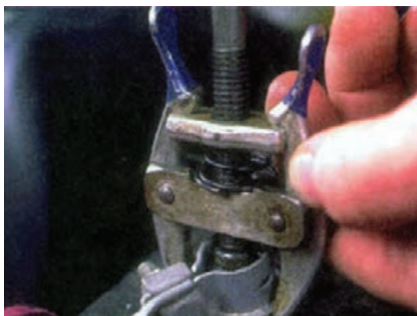
شکل ۱-۸۹- باز کردن بست اتصال بدنه‌ی باتری
