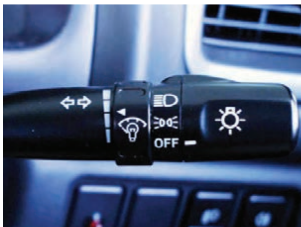
شکل ۱-۷۲- سوئیچ چراغ‌های روشنایی (طرح دسته‌ی راهنما)
