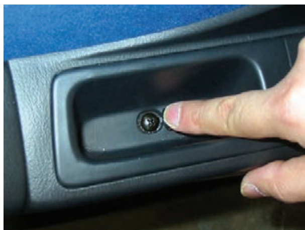
شکل ۱۸۲-۲ پیچ اتصال قاب سوئیچ به بدنه
