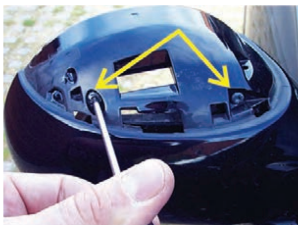
شکل ۱۷۴-۲- باز کردن پیچ‌های قاب بیرونی آینه
