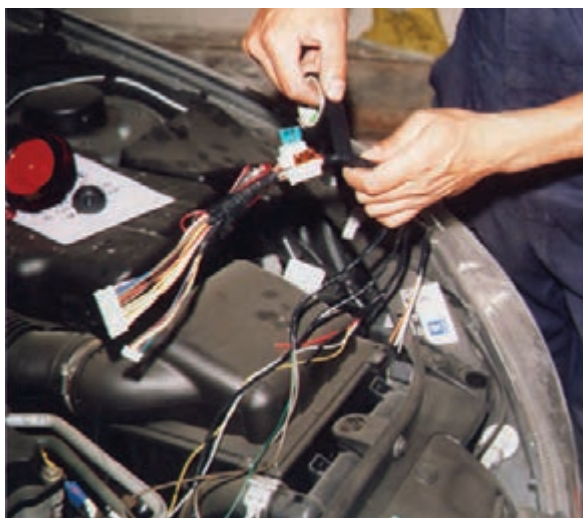
شکل ۲-۷۷ - نحوه‌ی عایق‌بندی سیم‌های مدار الکتریکی دزدگیر
