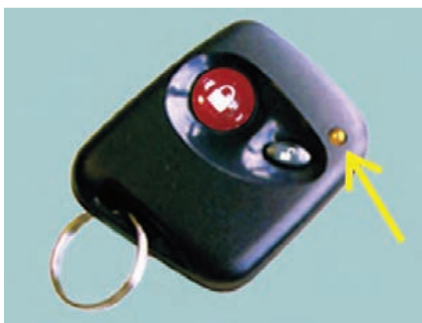
شکل ۲-۷- دیود نوری روی قاب ریموت کنترل
