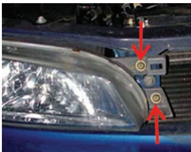
شکل ۱-۴۰- پیچ‌های نگه‌دارنده‌ی چراغ‌های بزرگ جلو
