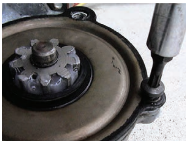
شکل ۱۳۱-۲- بستن پیچ های درپوش به بدنه
