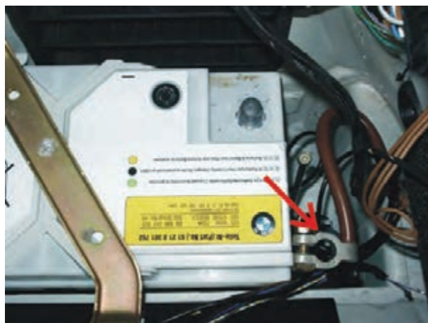
شکل ۳۵-۱- جدا کردن بست اتصال کابل بدنه‌ی باتری
