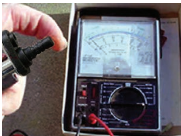
شکل ۱۹۶-۱- آزمایش سوئیچ لای در
