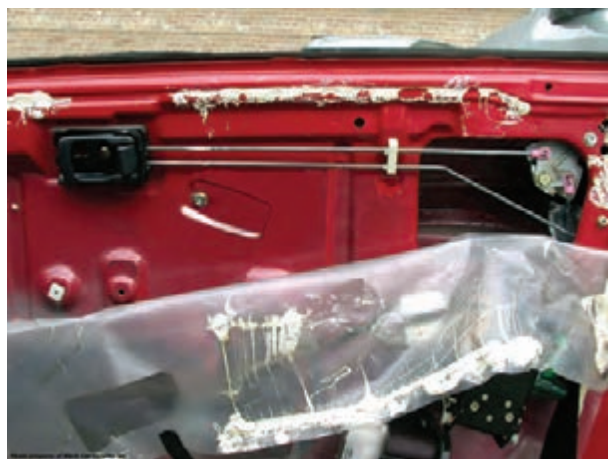
شکل ۲-۲۶- جدا کردن پلاستیک محافظ روی در
