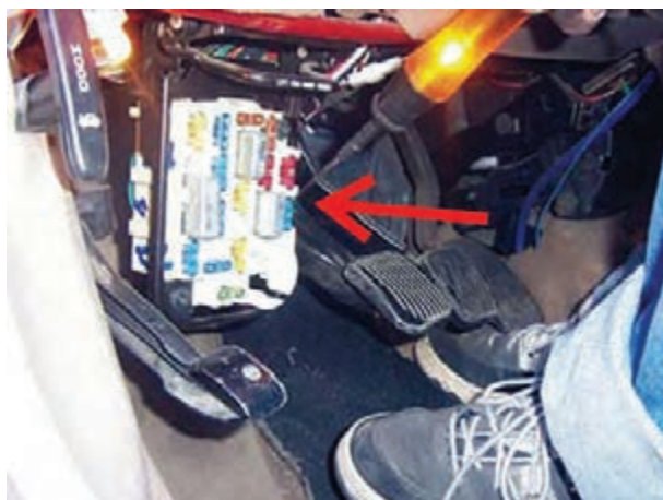
شکل ۱۲۰-۱ آزمایش جعبه‌ی فیوز با چراغ آزمایش
