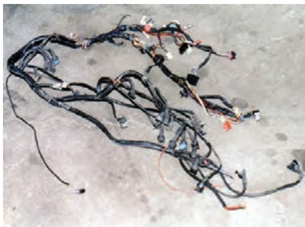
شکل ۱۳۳-۱- دسته‌ی سیم‌های یک نوع خودرو
