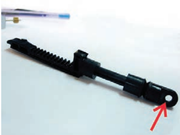
شکل ۱۸-۲ شانه‌ی دندانه‌دار دو قسمتی (محور عملگر)
