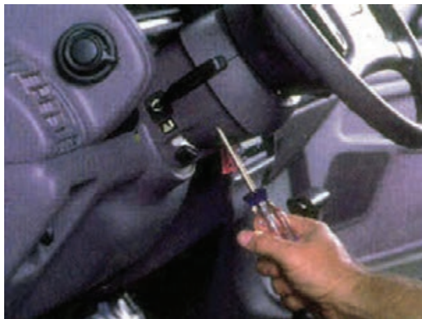
شکل ۱-۹۰- باز کردن پیچ‌های قاب سوئیچ روشنایی
