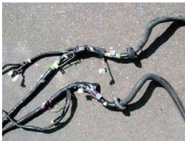
شکل ۱۳۷-۱- کلاف سیم کشی یک نوع خودرو
