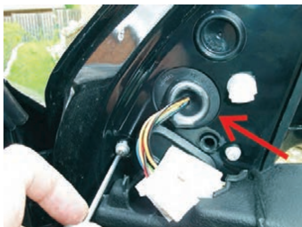
شکل ۱۷۸-۲ بازکردن پیچ نگه دارنده‌ی پایه‌ی اصلی آینه
