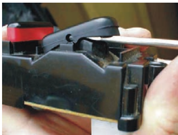
شکل ۲-۱۴۵ تعویض شستی معیوب
