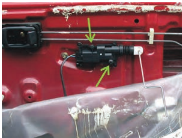
شکل ۲-۲۹ اتصال عملگر الکتریکی در روی در خودرو
