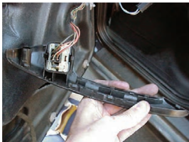
شکل ۱۱۸-۲ اتصال سوکت سوئیچ شیشه بالابر
