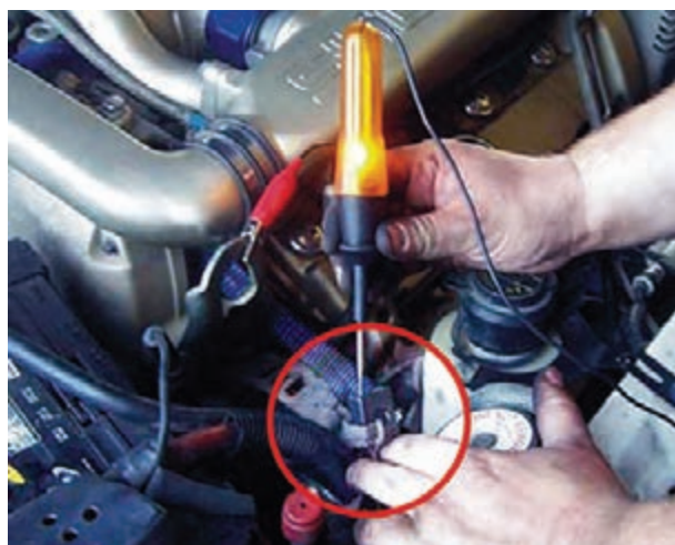
شکل ۱۴۵-۱- آزمایش برقراری جریان مدار چراغ‌های روشنایی
