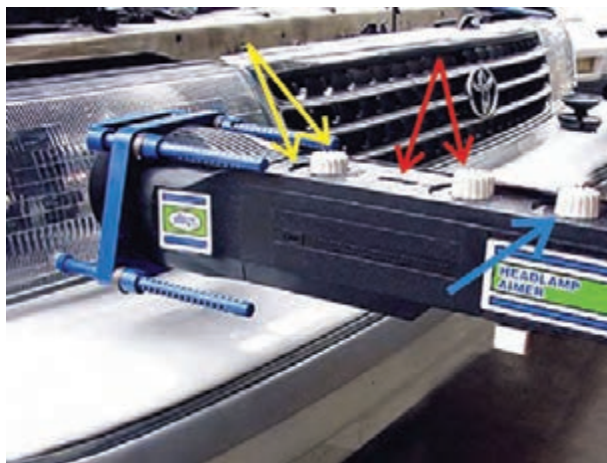
شکل ۱۶۱-۱ پیچ‌های تنظیم دستگاه تنظیم نور چراغ‌ها
