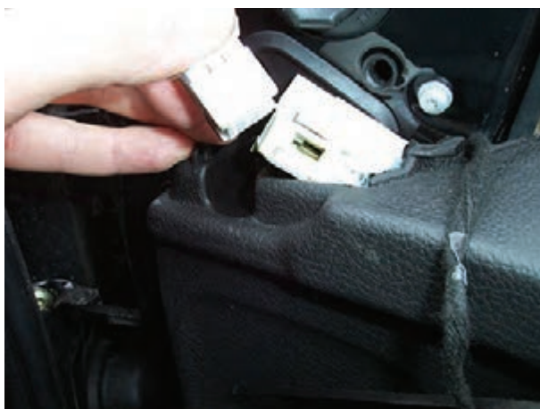
شکل ۱۶۶-۲- جدا کردن سوکت سیم کشی آینه
