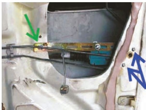
شکل ۳۹-۲ باز کردن پیچ‌های اتصال عملگر الکتریکی
