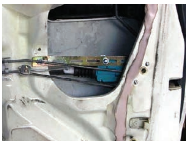
شکل ۲-۳۷- نحوه‌ی اتصال عملگر الکتریکی
