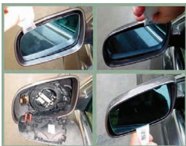
شکل ۱۶۷-۲- بیرون آوردن آینه از داخل قاب آن
