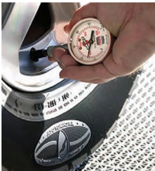
شکل ۱۵۸-۱- کنترل فشار باد تایر
