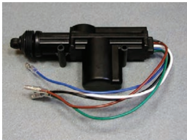
شکل ۲-۲۴- عملگر الکتریکی پنج سیمی
