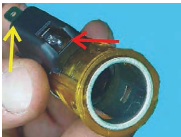
شکل ۱-۲۲۴- لامپ فنک و ترمینال الکتریکی آن
