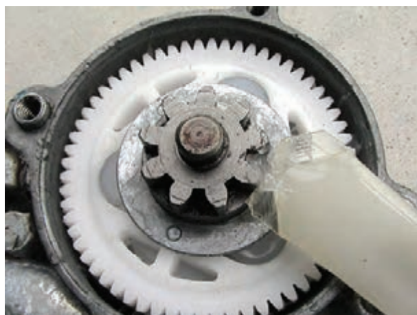
شکل ۱۳۰-۲- روغن کاری چرخ دنده ها
