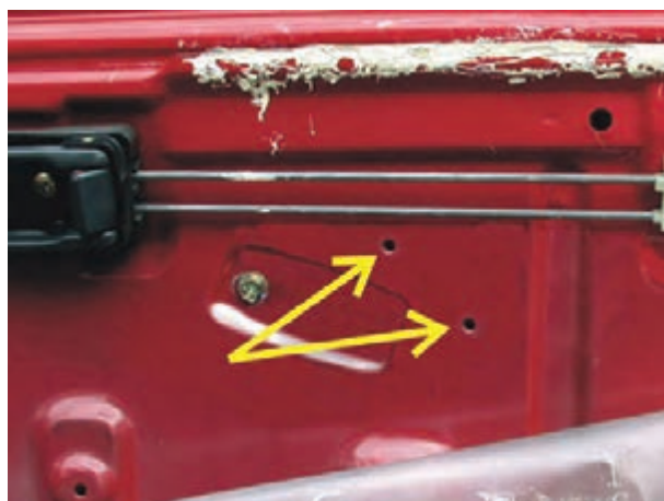
شکل ۲-۲۷ سوراخ کاری بدنه‌ی داخلی در خودرو
