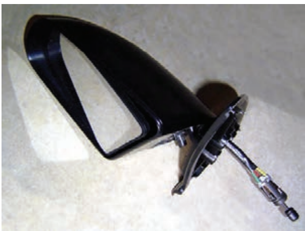
شکل ۱۵۶-۲- آینه‌ی جانبی و مکانیزم حرکت آن
