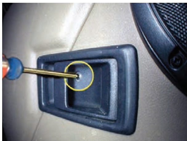
شکل ۲-۳۶- باز کردن قاب دستگیره‌ی قفل در
