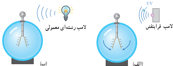
شکل ۱-۵-۱ الف) برهم‌کنش نور فرودی فرابنفش با کلاهک برق‌نما سبب می‌شود تا ورقه‌های آن به سرعت به هم نزدیک شوند. ب) در حالی که برهم‌کنش نور مرئی گسیل‌شده از یک لامپ رشته‌ای تغییری در انحراف ورقه‌های برق‌نما به وجود نمی‌آورد.
