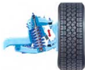
شکل ۲-۱۴ فنرهای به کار رفته در چرخ‌های خودرو
