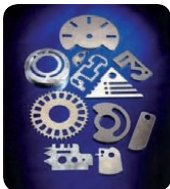
قطعات تولید شده بوسیله دستگاه پانچ CNC
