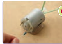
۲۲ یک سر مقاومت ۵۰ کیلو اهم را به یکی از پایه‌های موتور وصل کنید (فرقی نمی‌کند که کدام پایه باشد).
