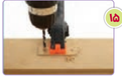
۱۵ با استفاده از آخرین چوب بستنی، دسته‌ای به طول حدود ۶ سانتی‌متر برای چرخاندن مولد ببرید. دو طرف آن را به فاصله‌های حدود ۱ سانتی‌متر یا دریل سوراخ کنید.
