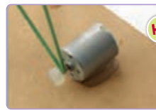
۲۰ لکمه‌ای دیگر از میله چسب حرارتی به طول حدود ۴ میلی‌متر ببرید و مرکز آن را به سر محور موتور فشار دهید. به طوری که فاصله کمی از کش لاستیکی داشته باشد.
