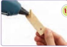
۱۴ از سیخ چوبی لکمه‌ای به طول حدود ۳ سانتی‌متر ببرید. و آن را به سوراخ انتهای گرد دسته بچسبانیید.
