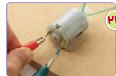
۲۳ سرب یکی از سیم‌های رابط را به انتهای آزاد مقاومت و سرب دیگر را به پایه دیگر موتور وصل کنید.
