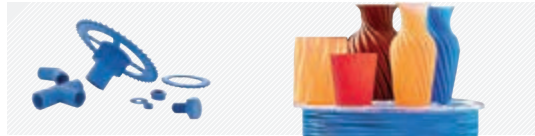
شکل ۳ چاپ سه‌بعدی شامل مجموعه‌ای از فرایندها است که مواد به صورت کنترل‌شده به یکدیگر پیوند داده می‌شوند تا یک شیء سه‌بعدی ساخته شود.
