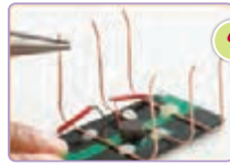
۹ با استفاده از سیم چوب پاهی قسمت جلوی ربات را کوتاه کنید تا کمی کوتاه‌تر از بقیه باشند. این کار صفحه خورشیدی را زاویه می‌دهد و ممکن است به جج‌آوری نور بیشتری کمک کند.
