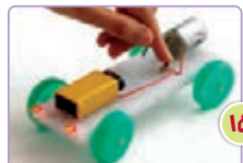
۱۵ کلید را بزنید و بررسی کنید که آیا مدار شما کار می‌کند یا نه. در صورتی که همه چیز درست باشد، دو لامپ LED روشن می‌شوند و موتور می‌چرخد. اگر این طور نبود، تمام مراحل قبلی را به دقت بررسی کنید.
