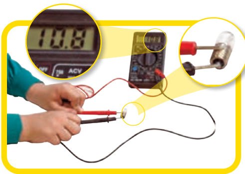
شکل ۸- اندازه‌گیری مقاومت لامپ خاموش با اهم سنج
