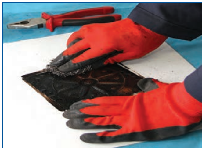
شکل ۱۱-۱۱- ساب زدن سطح پلاک مسی
