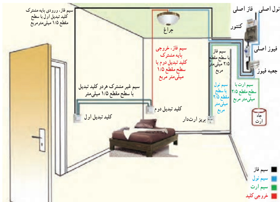
شکل ۱۸-۶ - سیم‌کشی مدار کلید تبدیل
