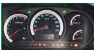
شکل ۹-۱۴- چراغ‌های هشداردهنده خودرو
