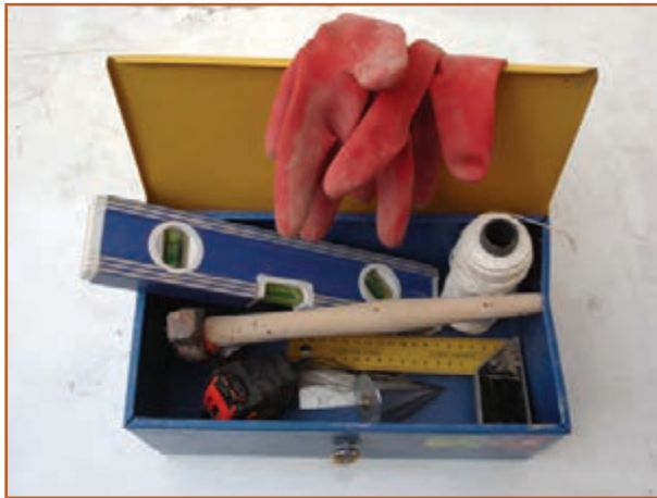
شکل ۸-۱۰- برخی از ابزار مورد نیاز دیوار چینی
