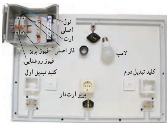
شکل ۶-۲۰- جانمایی قطعات مدار کلید تبدیل
