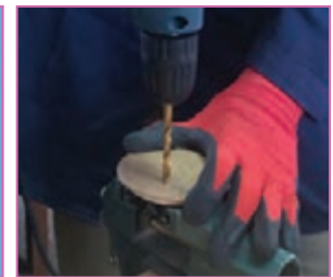
ث - سوراخ کاری قطعات
