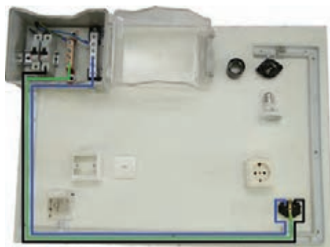
شکل ۱۰-۶- انجام سیم‌کشی پریز ۱
