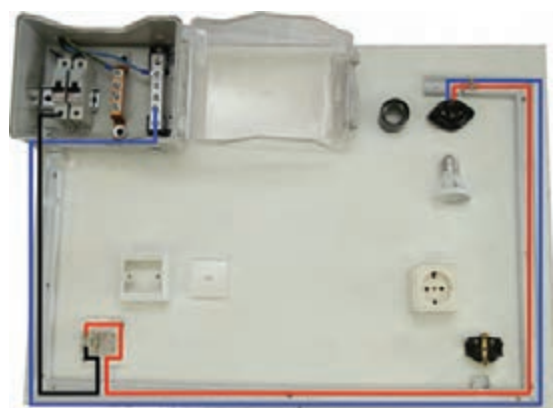
شکل ۶-۸ - انجام سیم کشی روشنایی
