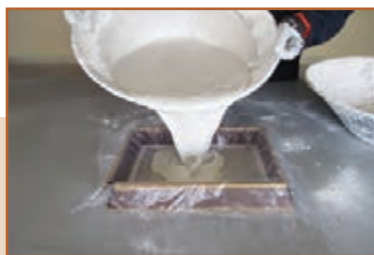
ث - ریختن ملات گچ در قالب
