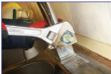
ث- باز کردن پیچ روی مغزی (گلند)
