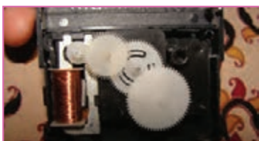
ب — بعد از باز کردن موتور ساعت
