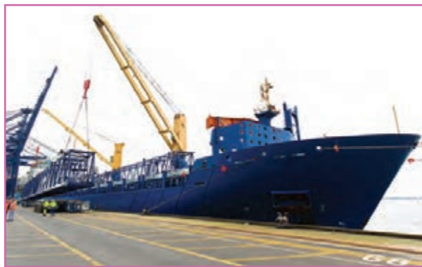
الف - نصب جرثقیل بر روی کشتی
