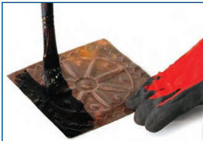
شکل ۱۰-۱۱- آغشته کردن سطح پلاک مسی به قیر
