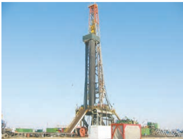
شکل ۱۰- دکل حفاری چاه‌های اکتشافی نفت و گاز
