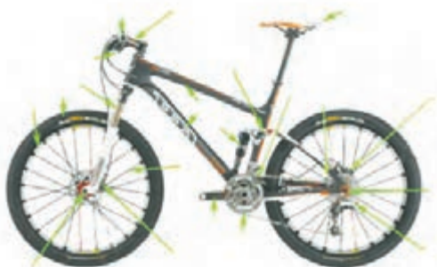
شکل ۳ - دوچرخه از اجزا یا ماشین‌های ساده‌تری مانند: اهرم، پیچ و مهره، چرخ و محور، چرخ و دنده... تشکیل شده است.
